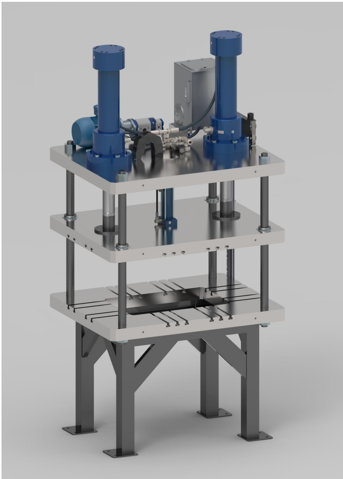
Slika 84. Hidraulična preša za krzalice kapaciteta 50 t
