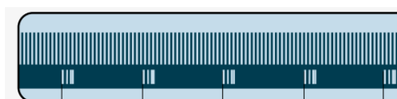
Slika 72. Shematski prikaz skala inkrementalnog enkodera [25]
