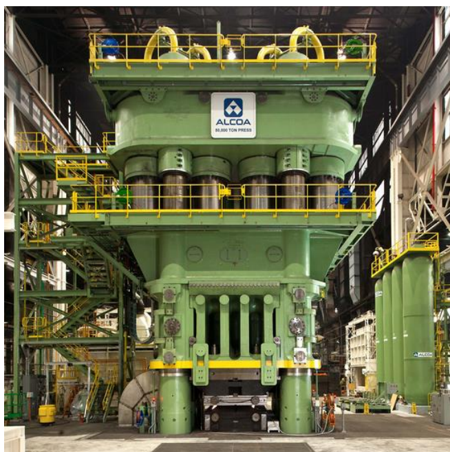
Slika 7. Velike hidraulične preše, Alcoa (lijevo) i Mesta (desno), 50000 t
