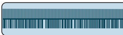
Slika 71. Prikaz skala apsolutnog enkodera [25]
