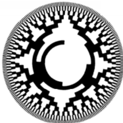
Slika 45. Primjer diska apsolutnog enkodera
