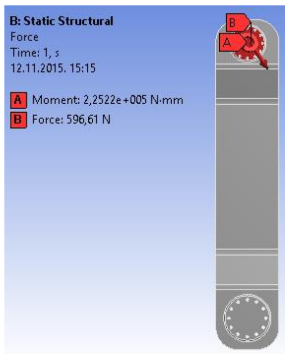
Slika 148. Definiranje opterećenja pomične ruke 1
