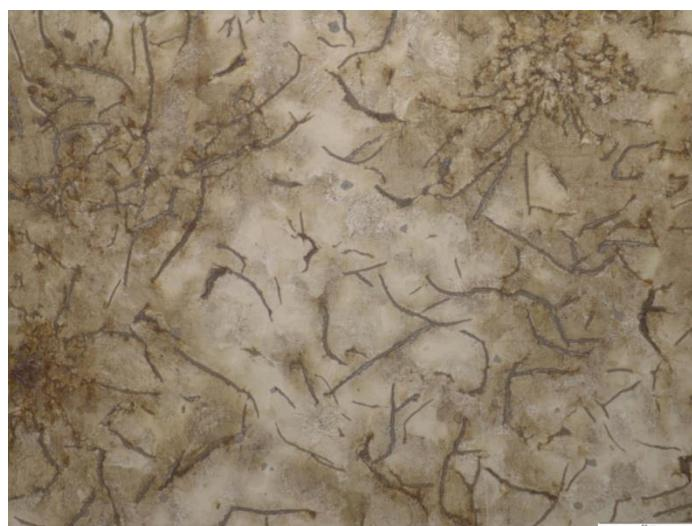
Slika 70. Metalografska snimka mikrostrukture sivog lijeva u nagrizenom stanju, 500x
