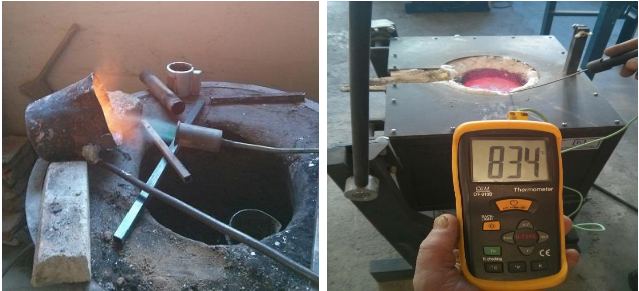
Slika 67. Predgrijavanje lonca (lijevo) i mjerenje temperature litine unutar peći (desno)
