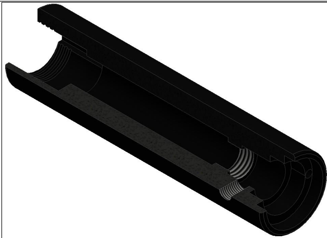
Slika 65. Kućište sonde pogonjene elektromotorom – 3/4 presjek - CAD
