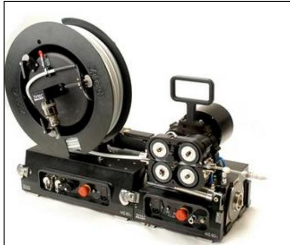
**Slika 21. Integrirani sustav za ispitivanje vrtložnim strujama MIZ-80iD**
