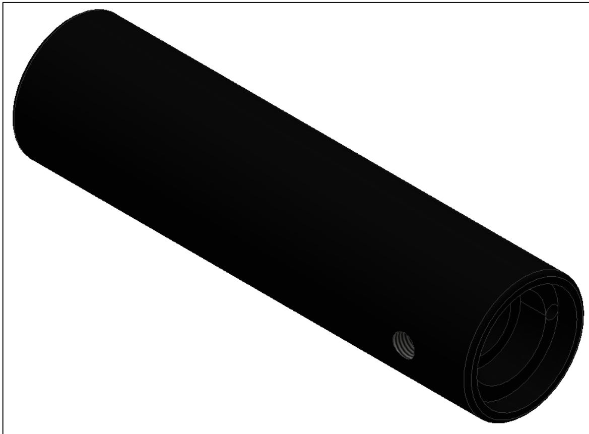
Slika 64. Kućište sonde pogonjene elektromotorom - CAD
