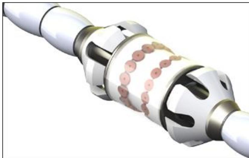
Slika 16. Sonda s poljem zavojnica, prema [12]
