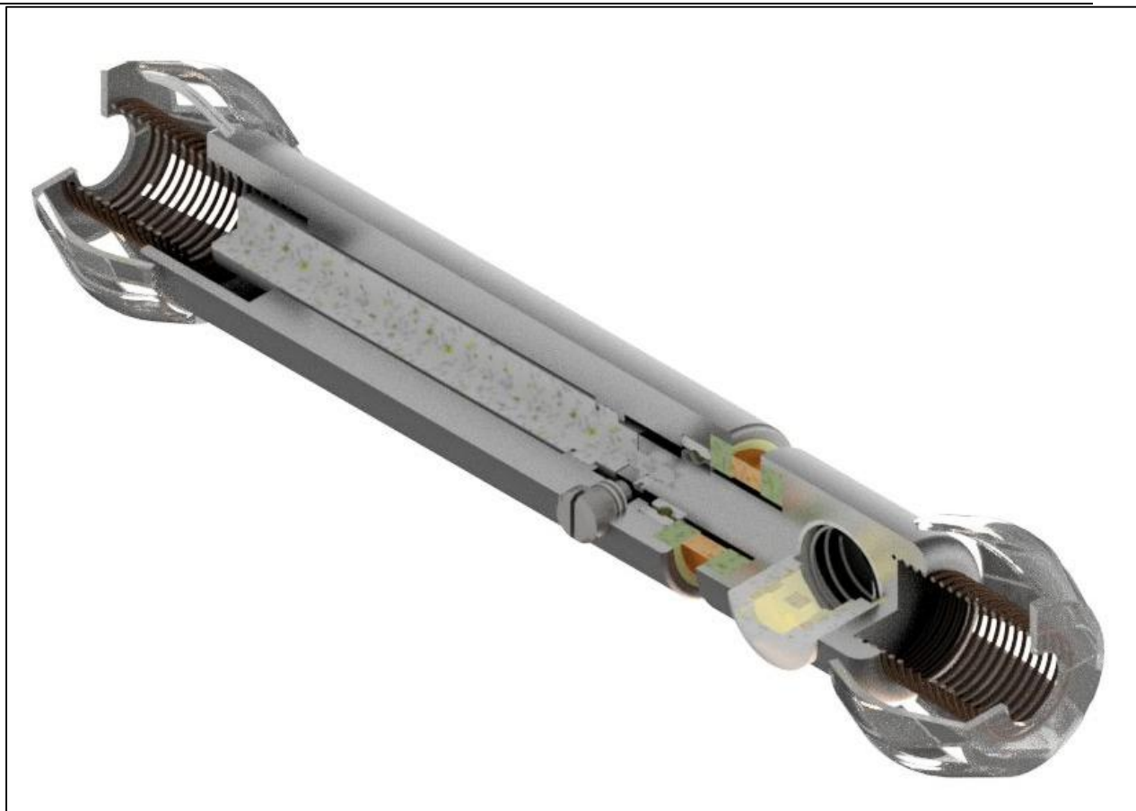
Slika 79. Sonda pokretana elektromotorom – 3/4 presjek
