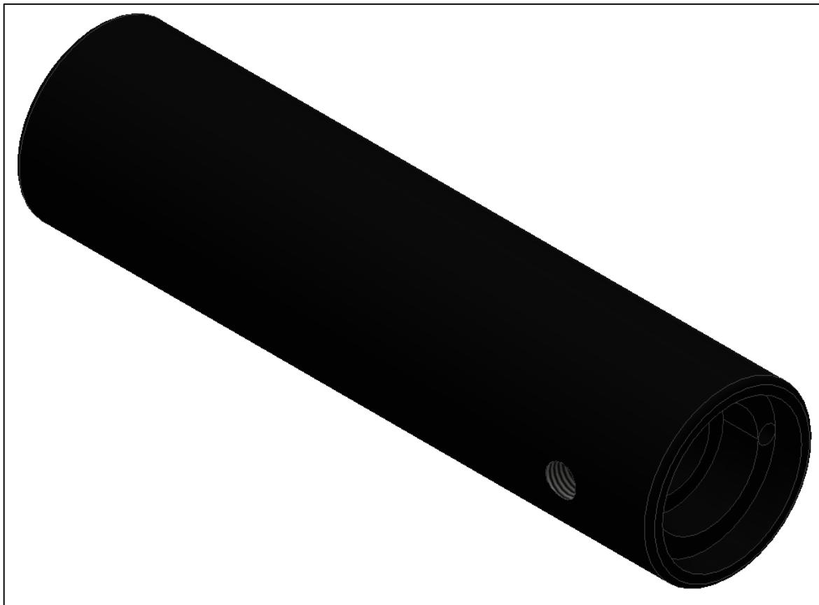
Slika 64. Kućište sonde pogonjene elektromotorom - CAD
