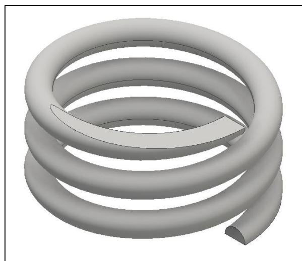
Slika 75. Opruga nosača zavojnice – stisnuto stanje – CAD
