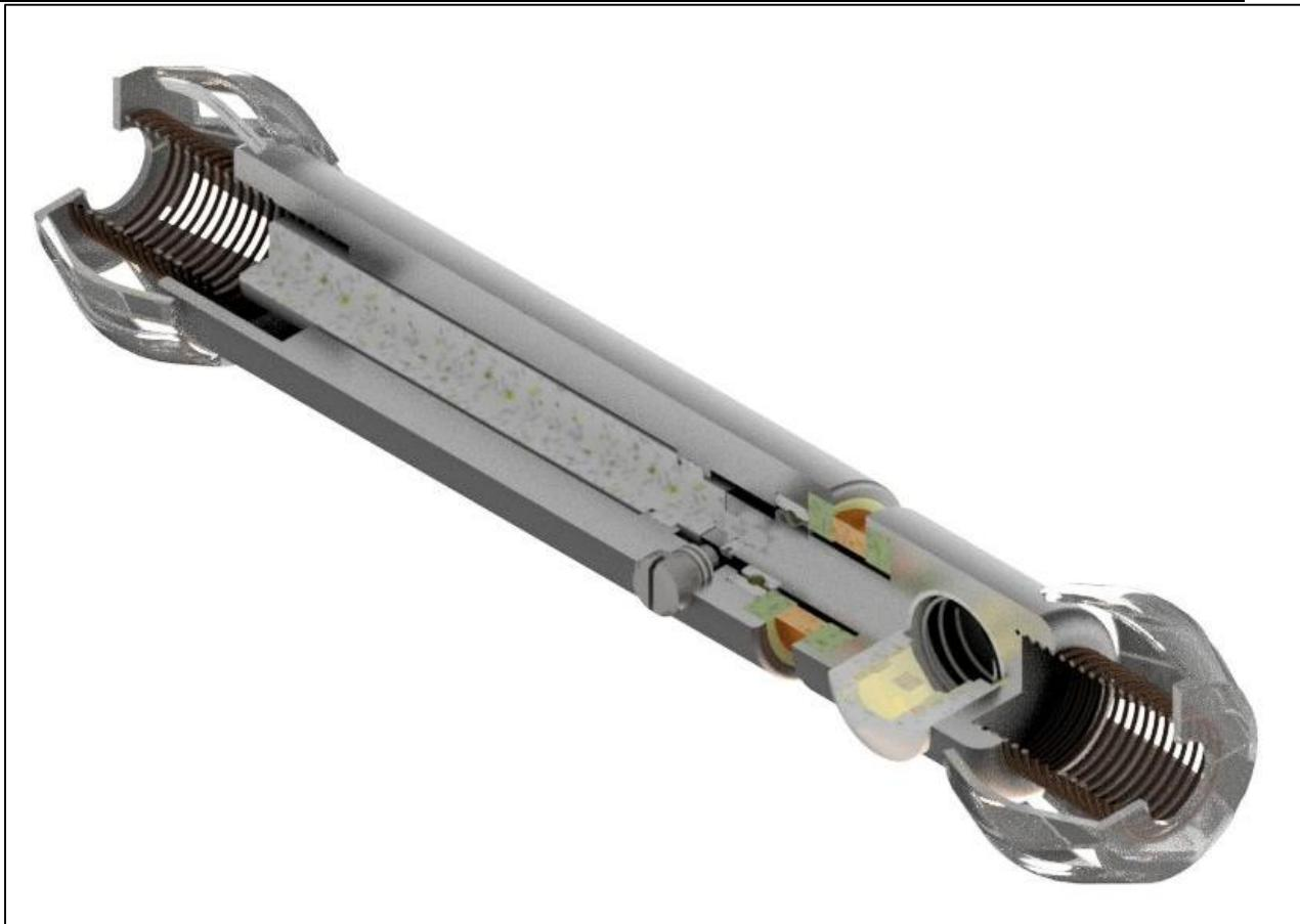
Slika 79. Sonda pokretana elektromotorom – 3/4 presjek
