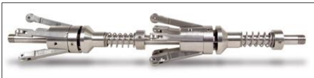
Slika 27. Uređaj za centriranje sustava IRIS tvrtke Olympus
