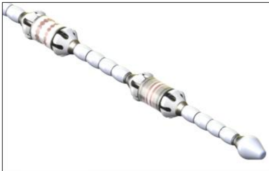
Slika 17. Kombinirana sonda (bobbin sonda + sonda s poljem zavojnica)
