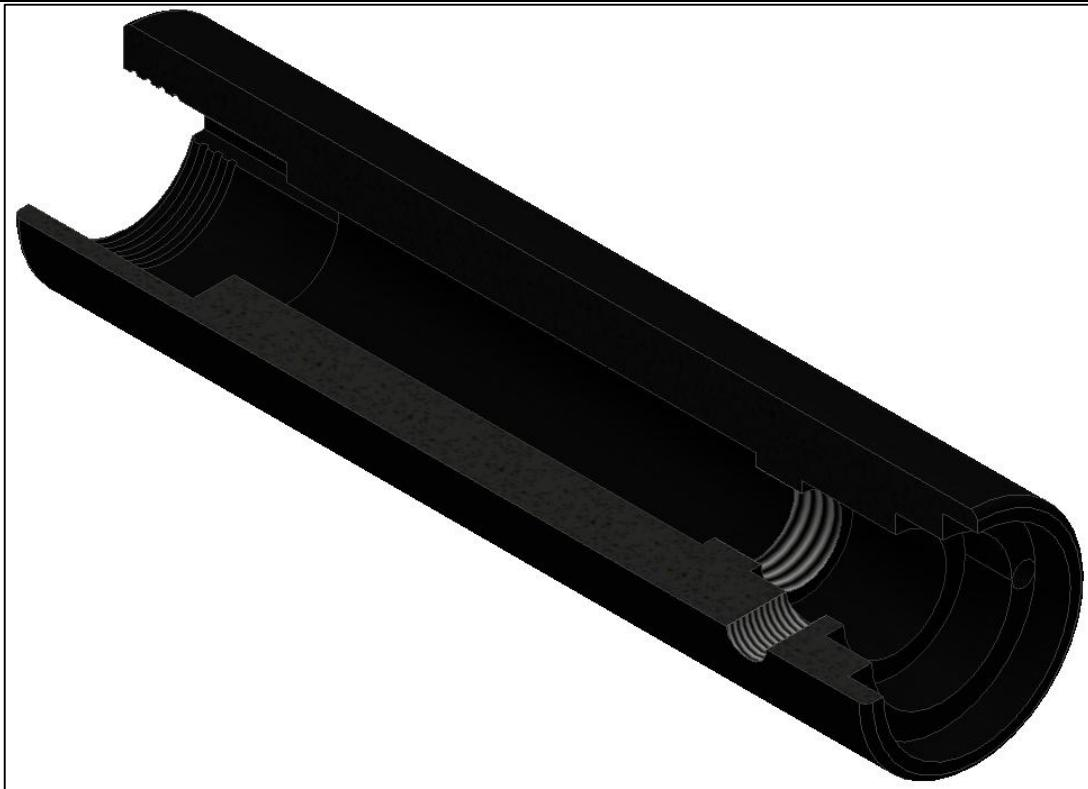
**Slika 65. Kućište sonde pogonjene elektromotorom – 3/4 presjek - CAD**
