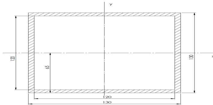
**Slika 57. Proračunski presjek zavara montažne ploče**
