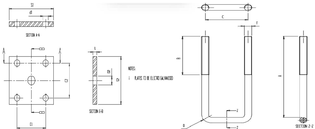
**Slika 19. Dimenziije seta za pričvršćenje opruge za osovinu**
