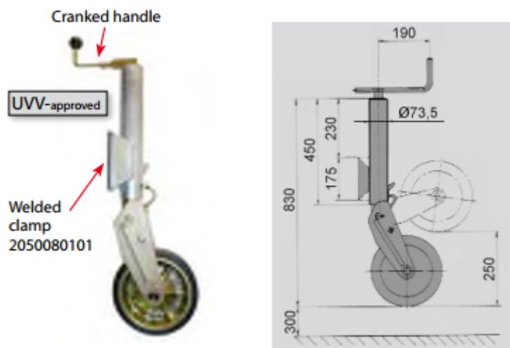
**Slika 22. Stabilizator tvrtke AL-KO**
