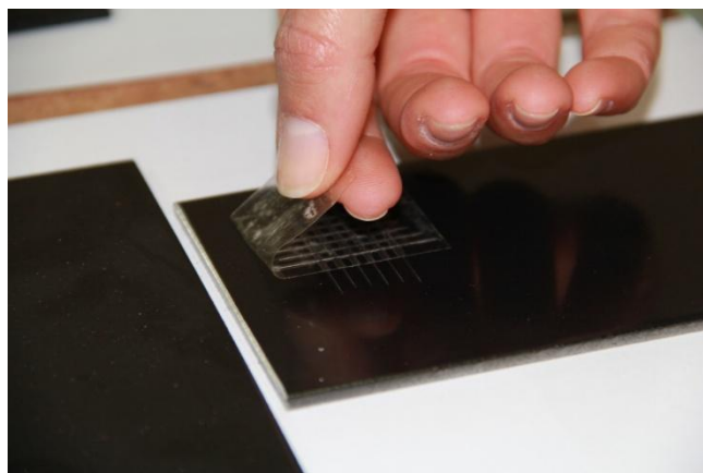
Slika 40. Uklanjanje samoljepljive trake s kvadratne mrežice
