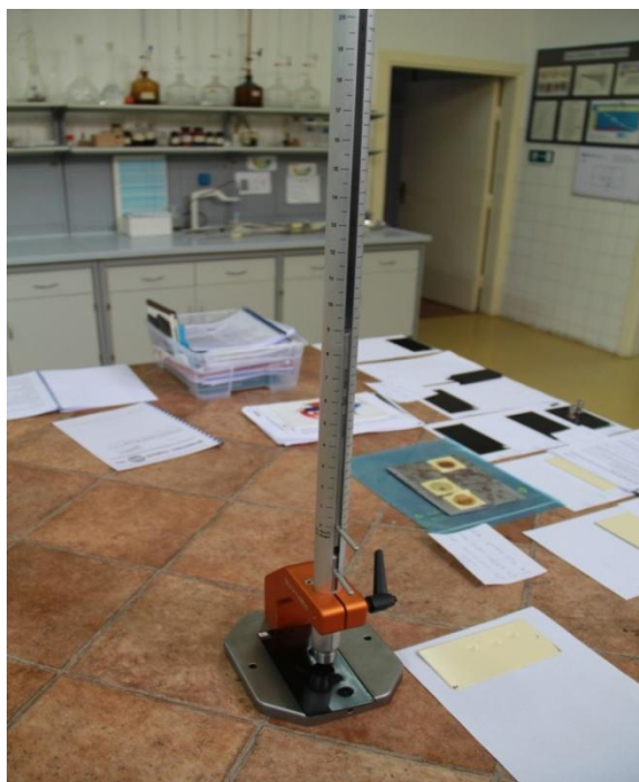
Slika 32. Uteg za utvrđivanje otpornosti premaza na udar s postavljenim uzorkom
