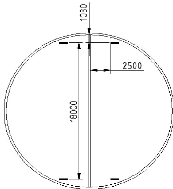
Slika 49. Prikaz raspodjele 4 mehaničke mješalice u digestoru.
