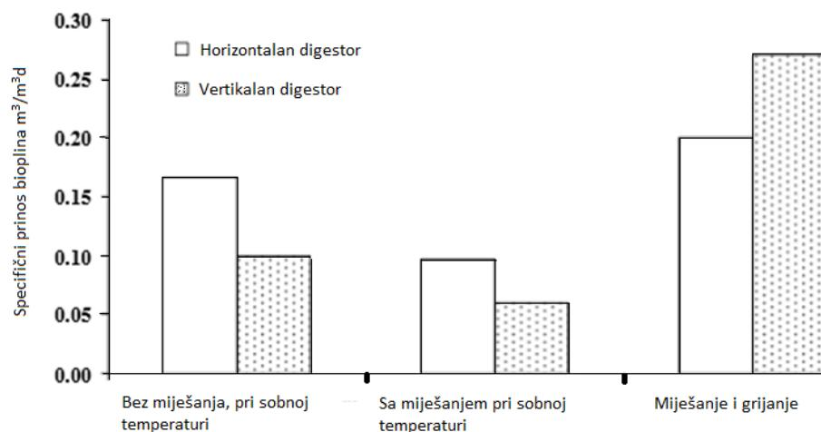
Slika 27. Specifičan prinos bioplina ovisno o tipu digestora.
