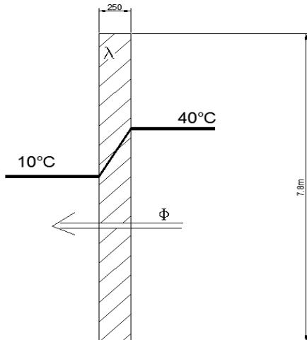
Slika 43. Model provođenja topline kroz stijenk digestora.
