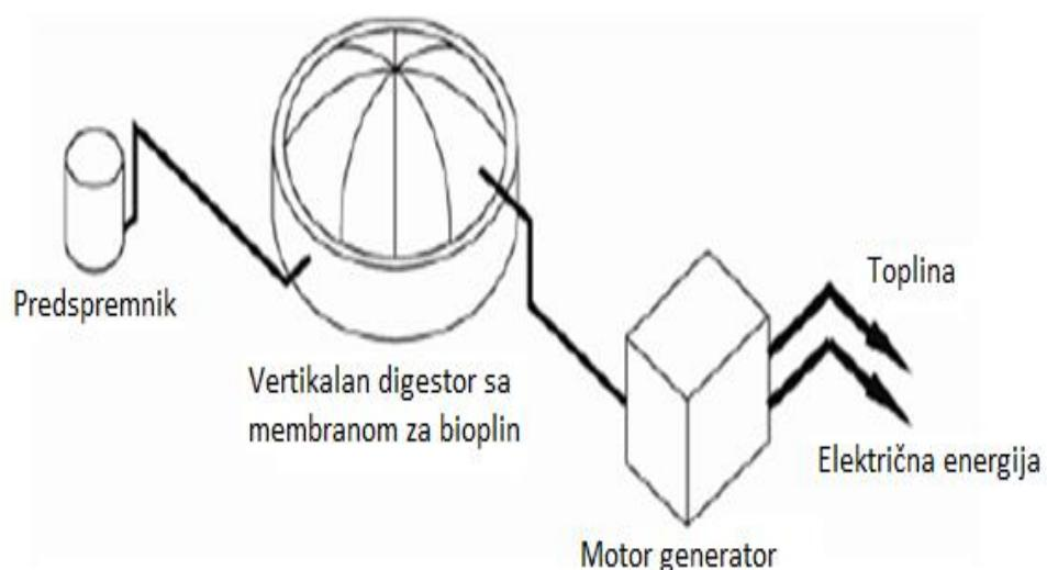
Slika 9. Shematski prikaz bioplinskog postrojenja sa vertikalnim digestorom.
