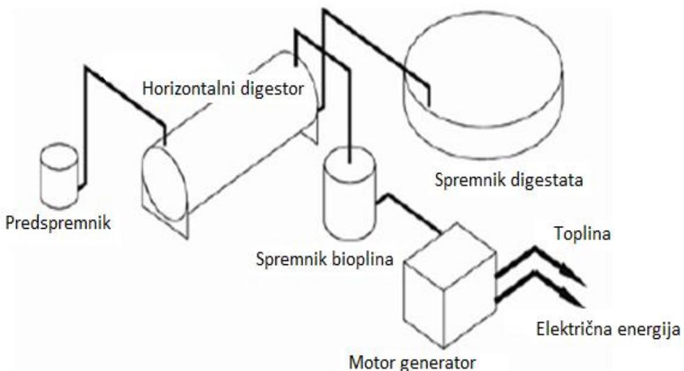
Slika 8. Shematski prikaz bioplinskog postrojenja sa horizontalnim digestorom.
