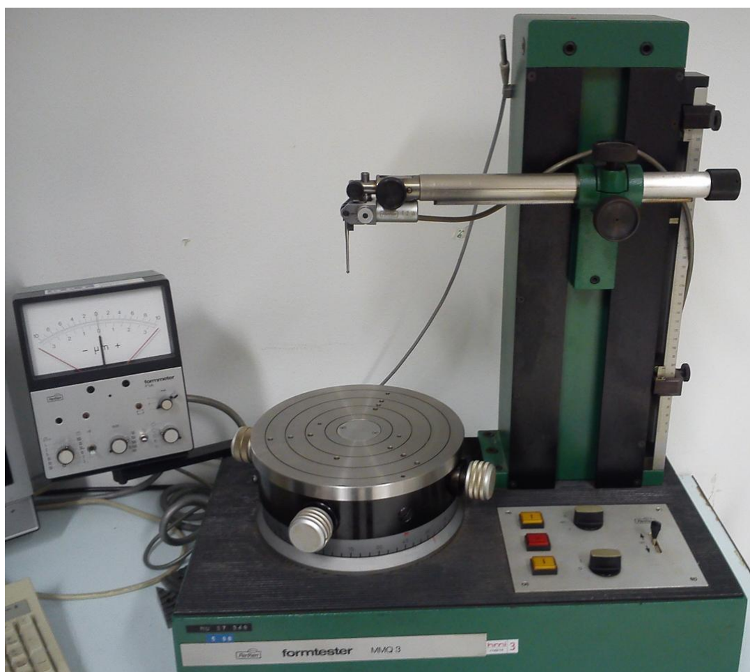
Slika 12. Uređaj za mjerenje kružnosti MMQ 3 u Nacionalnom laboratoriju za duljinu
