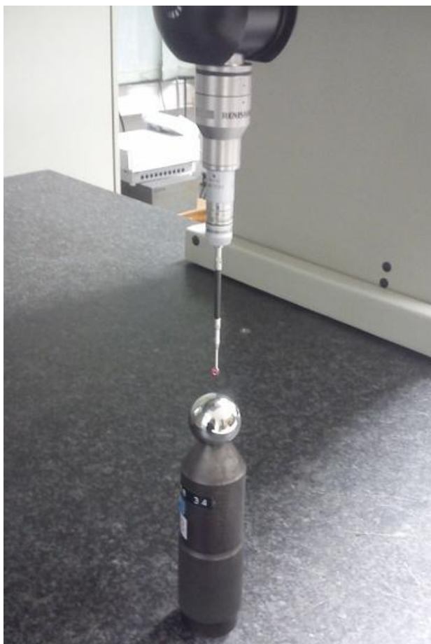
Slika 46. Pozicioniranje ticala prema etalonu za umjeravanje
