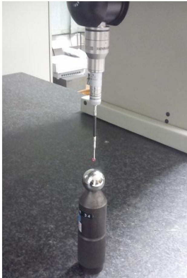
Slika 46. Pozicioniranje ticala prema etalonu za umjeravanje
