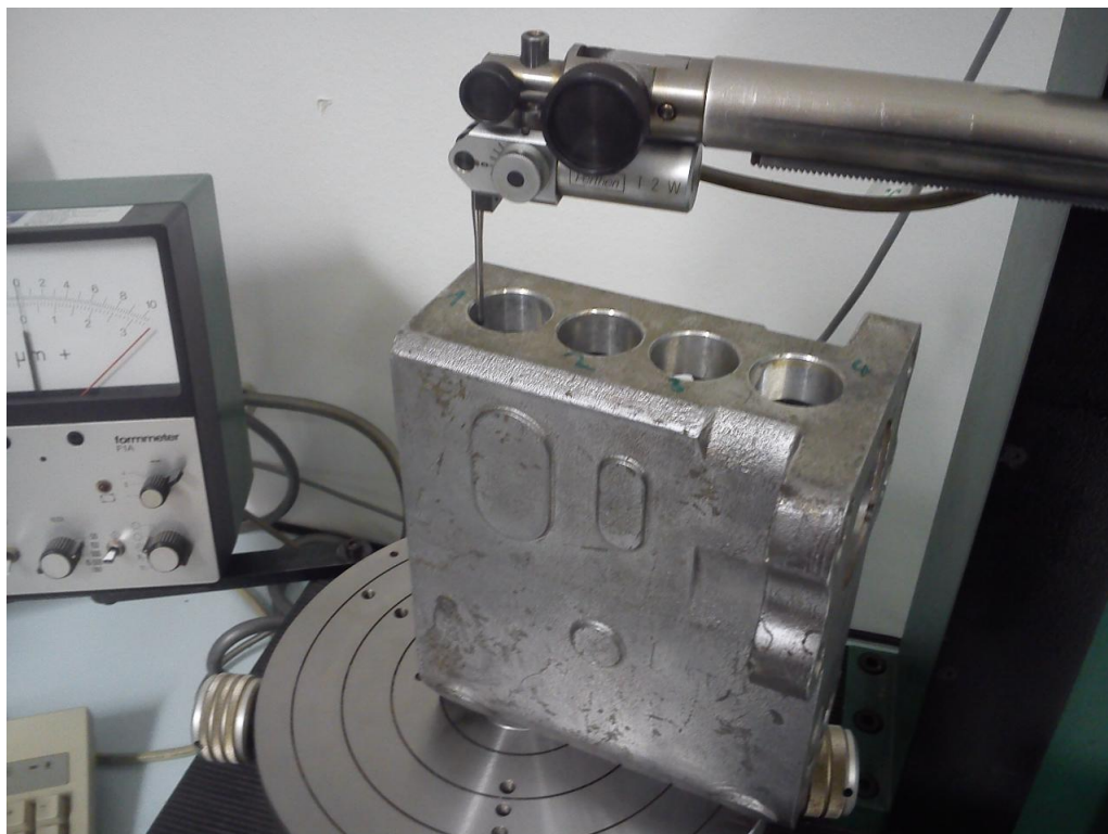
Slika 55. Mjerenje provrta 1 na okretnom stolu
