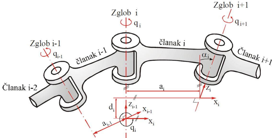
Slika 2.6: Denavit–Hartenbergovi parametri za rotacijski zglob [7]
