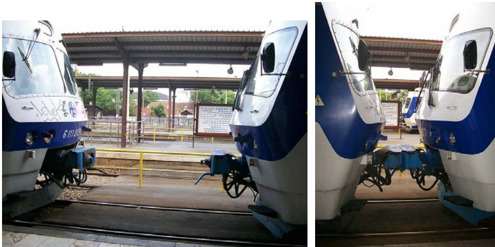
Slika 7. Razdvojene (lijevo) i spojene garniture (desno) HŽ 6111
