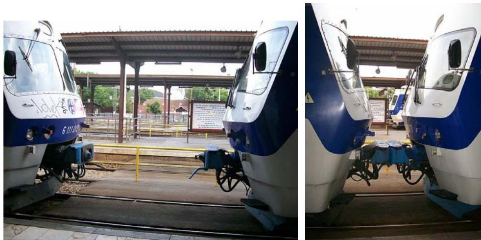
Slika 7. Razdvojene (lijevo) i spojene garniture (desno) HŽ 6111
