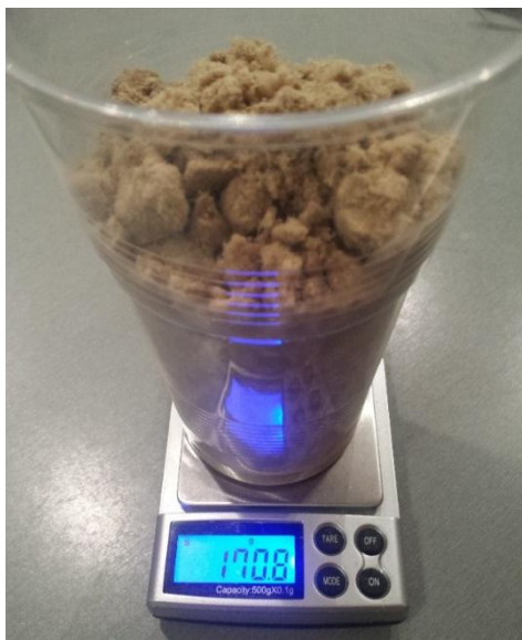
Slika 30. Manje drvene čestice nakon filtriranja
