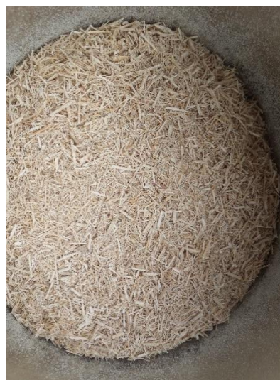
Slika 22. Usitnjavanje stabljike miskantusa
