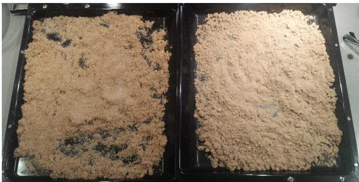
Slika 31. Postavljanje čestica na podložni lim peći
