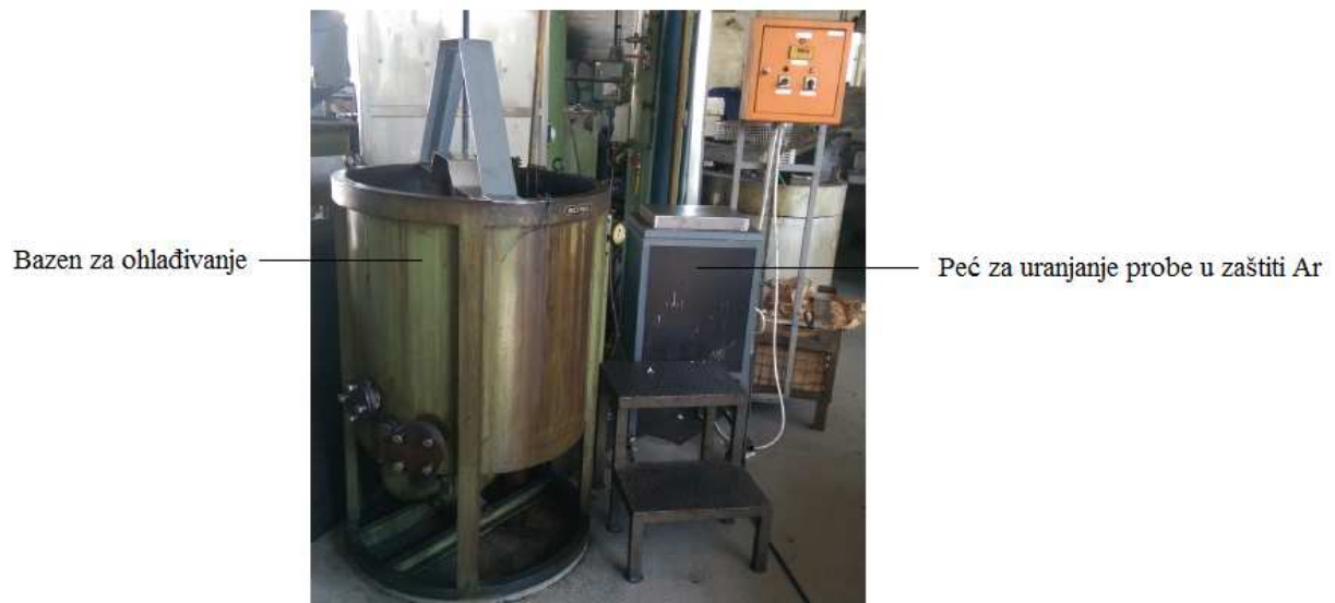
Slika 36. Oprema za gašenje
