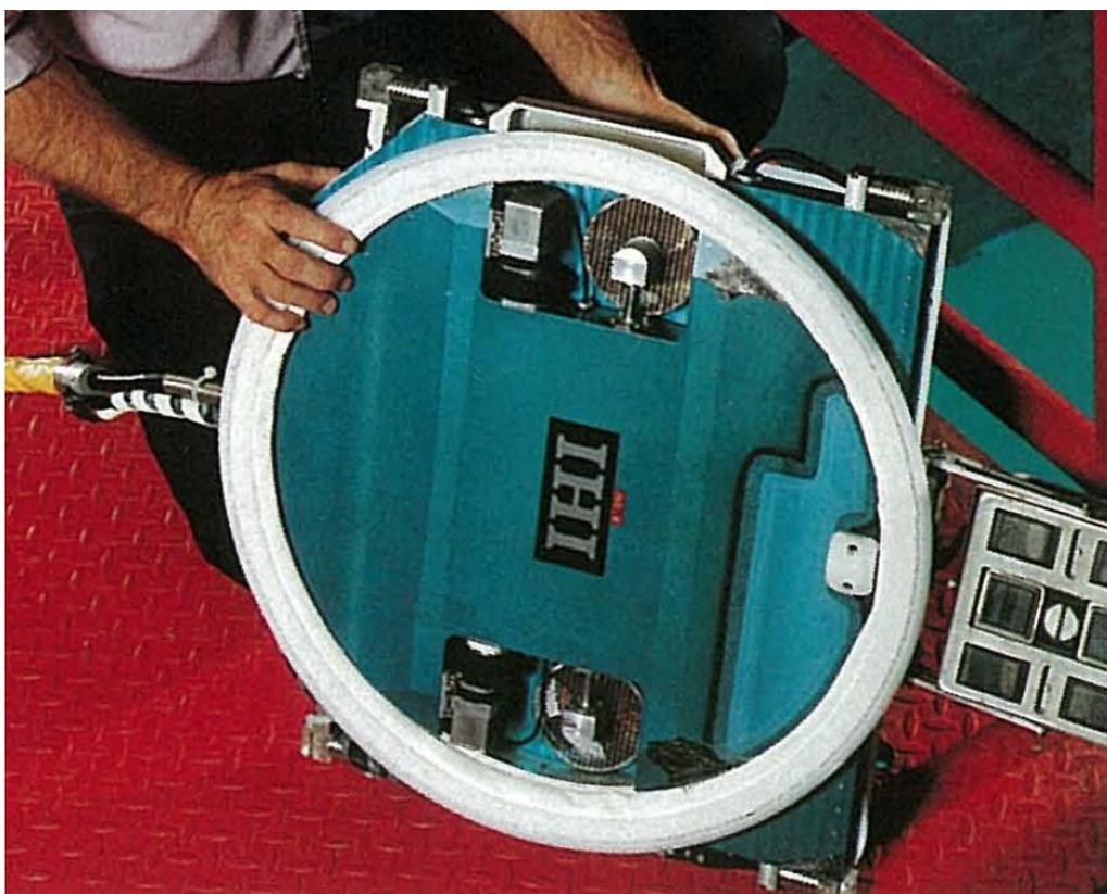
**Slika 8. Donja strana robota za ispitivanje [3]**
