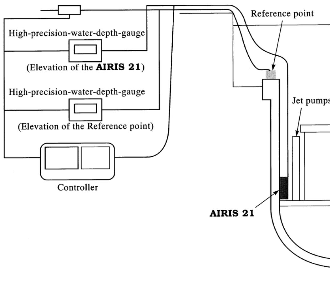
Slika 9. Shema sustava za mjerenje visine [3]
