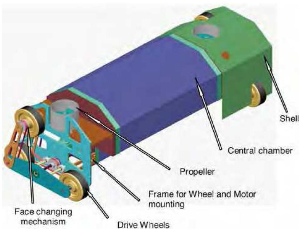
**Slika 17. Robot za uspitivanje spremnika – RobTank [5]**
