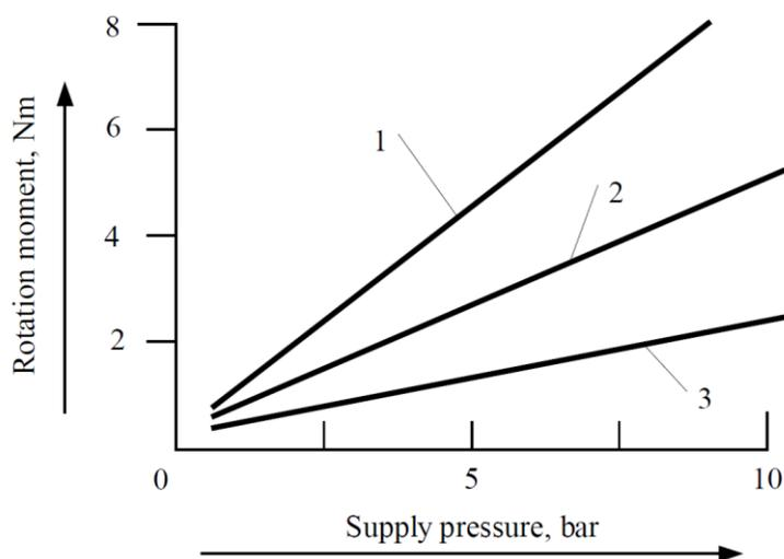
**Slika 25. Dijagram karakteristike okretnog momenta aktuatora [6]**
