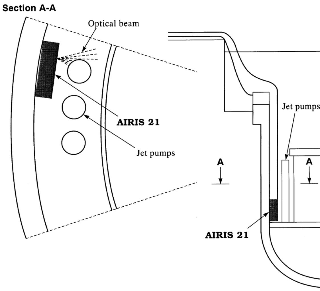
Slika 10. Shema načina rada sustava za mjerenje azimuta [3]
