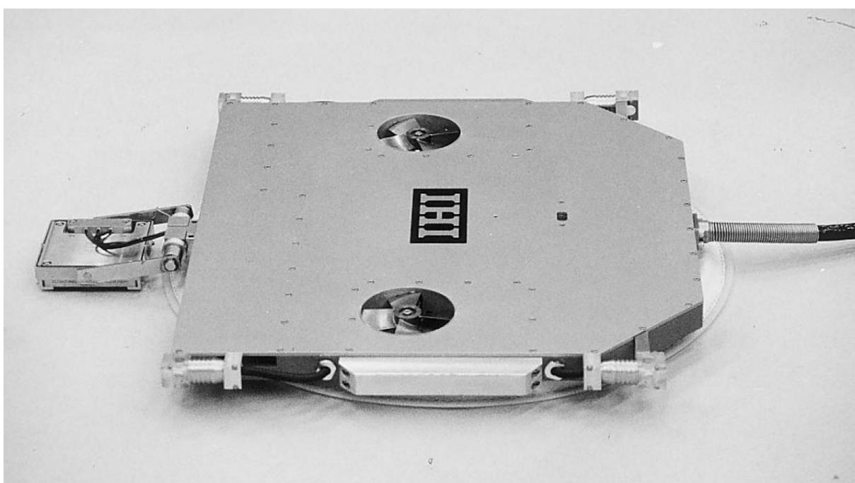
**Slika 7. Skener (robot) za ispitivanje zavara [3]****2.1.1. Konstrukcija i funkcionalnost robota za ispitivanje**
