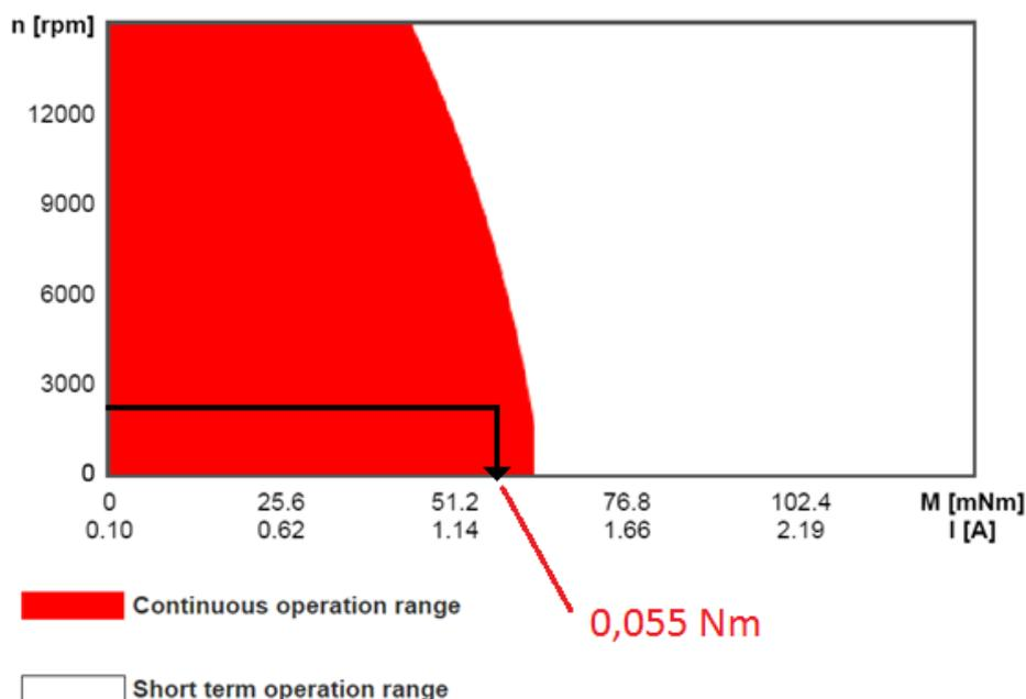
Slika 61. Momentni dijagram motora kotača [11]
