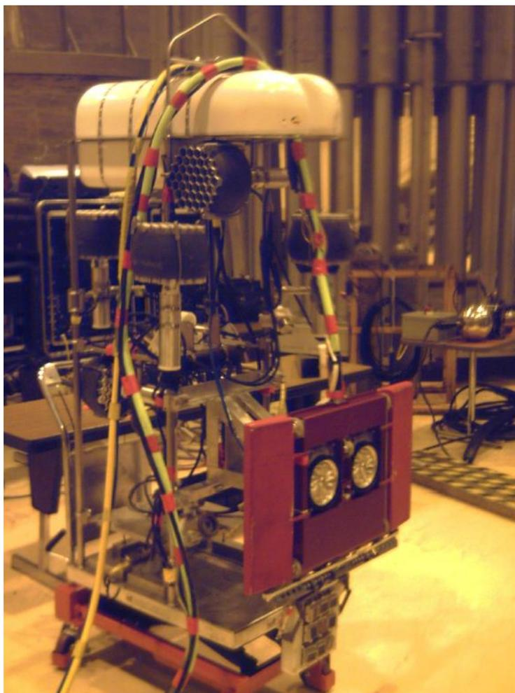
**Slika 13. Podvodno vozilo i skener [4]**
