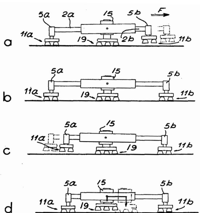
Slika 35. Postupak pomaka vozila po ravnoj plohi [9]
