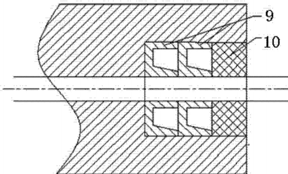
Slika 30. Brtvljenje osovine [7]
