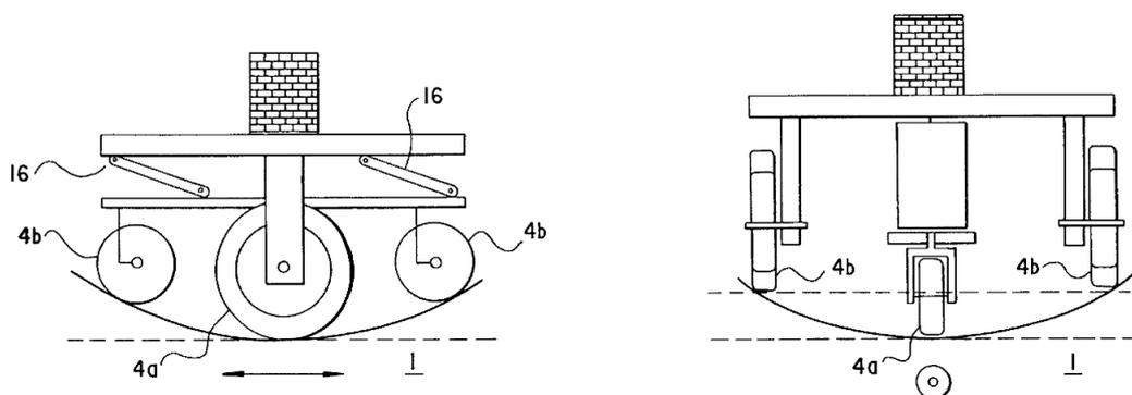
Slika 33. Sustav za kompenzaciju različite udaljenosti kotača [8]
