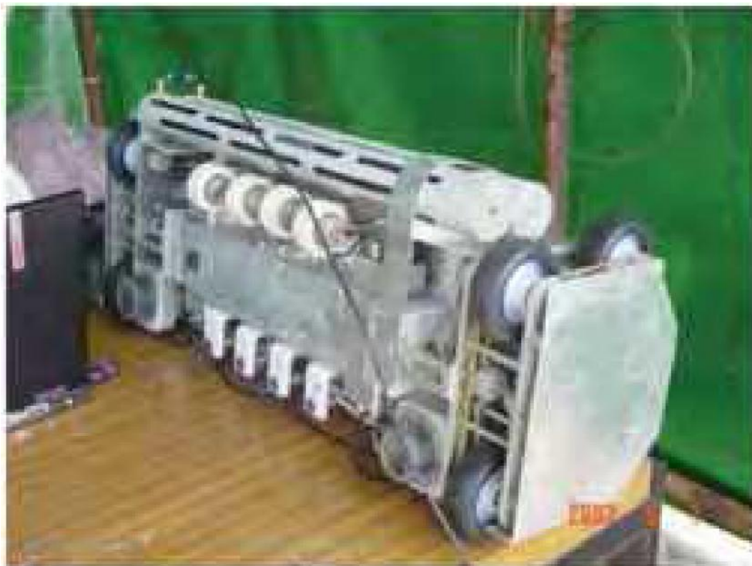
Slika 19. Sonde u kotačima robota RobTank [5]
