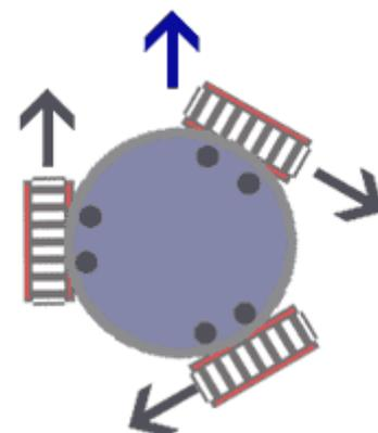
**Slika 40. Metoda upravljanja korištenjem tri višesmjerna kotača [10]**
