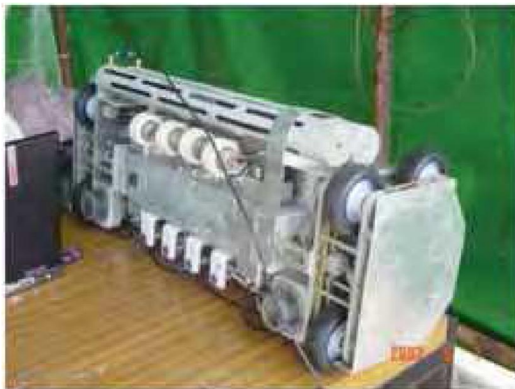
Slika 19. Sonde u kotačima robota RobTank [5]
