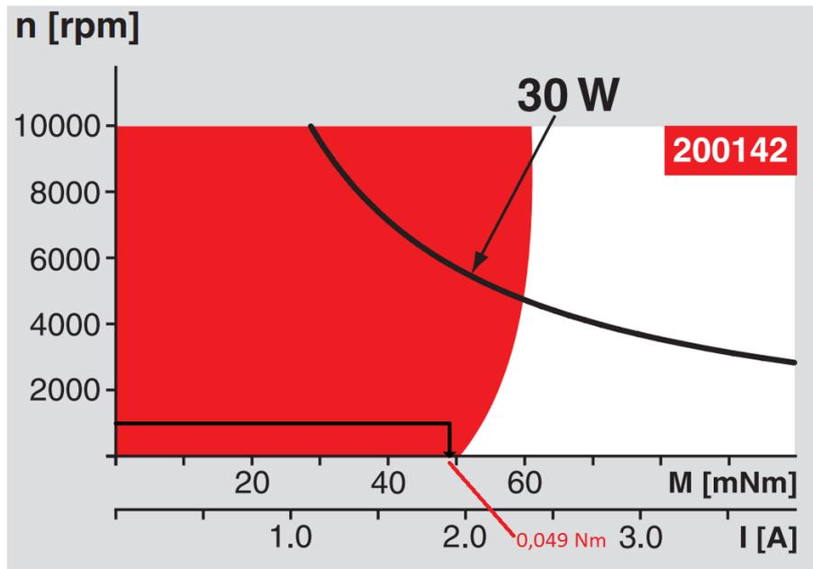
Slika 65. Momentni dijagram motora sklopa okretnog kotača [11]
