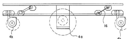
Slika 32. Pogonski i okretni kotači robota [8]
