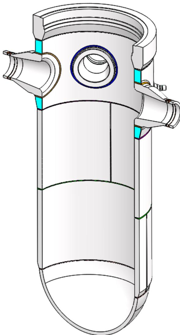
**Slika 4. Presjek reaktorske posude nuklearne elektrane**
