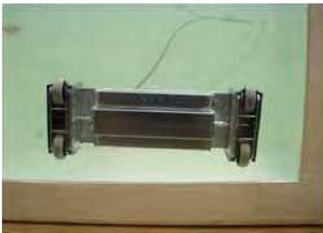
Slika 16. Ispitivanje vertikalne stjenke spremnika prototip 1 – RobTank [5]
