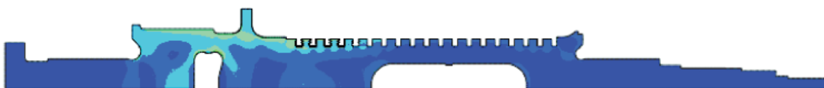
Slika 2. Polje naprezanja unutar rotora tijekom progrijavanja turbine [11]
