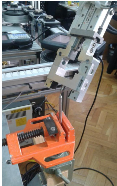
Slika 13: Kalibracija vrha alata robota
