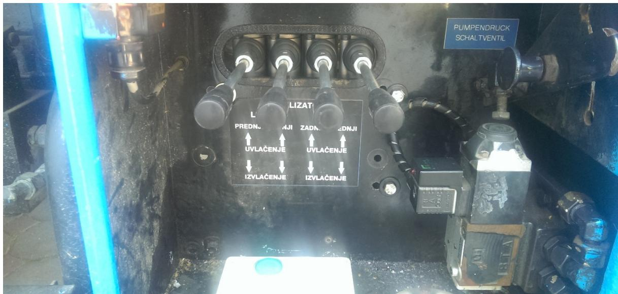
Slika 6. Ormar za nivaciju platforme
