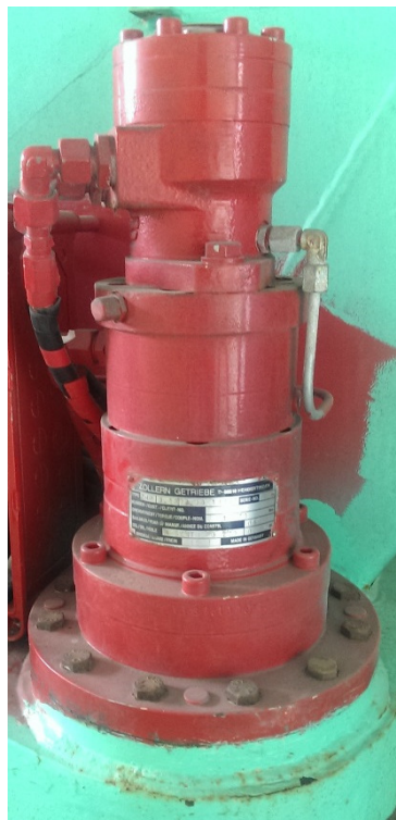
Slika 14. Sklop hidromotora i reduktora
