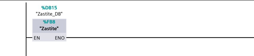
Network 12: Aktivacija bloka za trenutno iskljucivanje aktuatora kad operater ne vrši nikakvu aktivnost
