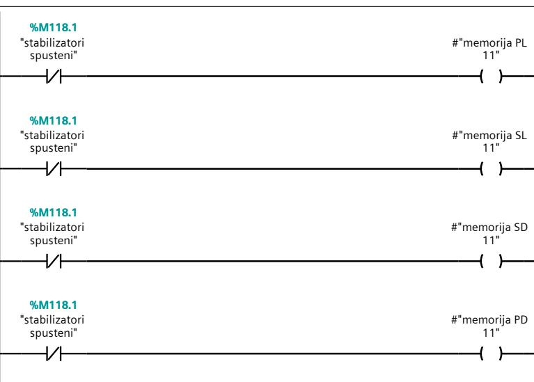
Network 11: elektromagnet PD uvlacenje (DQ modul, drugi do PLC-a)
