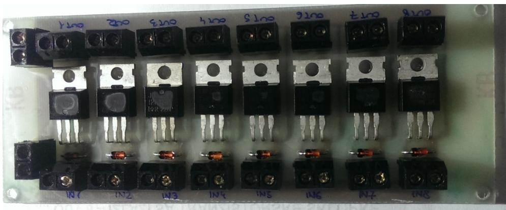
Slika 20. Tiskana pločica za PWM
