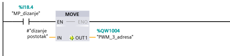
Network 6: PWM-u se omogućava rad jedino ako je jedan od mikroprekidaca potencijometra aktivan
