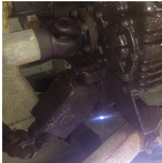
Slika 13. Hidraulička pumpa
