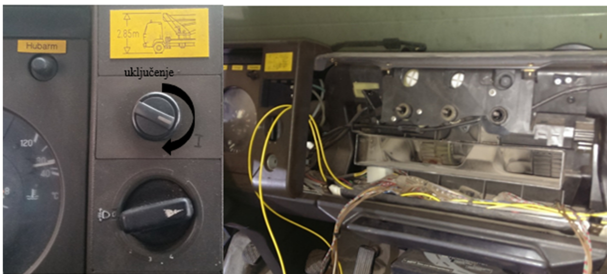
Slika 16. Sklopka za uključenje elektronike radne platforme
