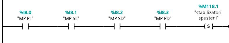
**Network 6:** Ako se iti jedan stabilizator odvoji od podloge od se isključuje signal "stabilizatori spusteni"
