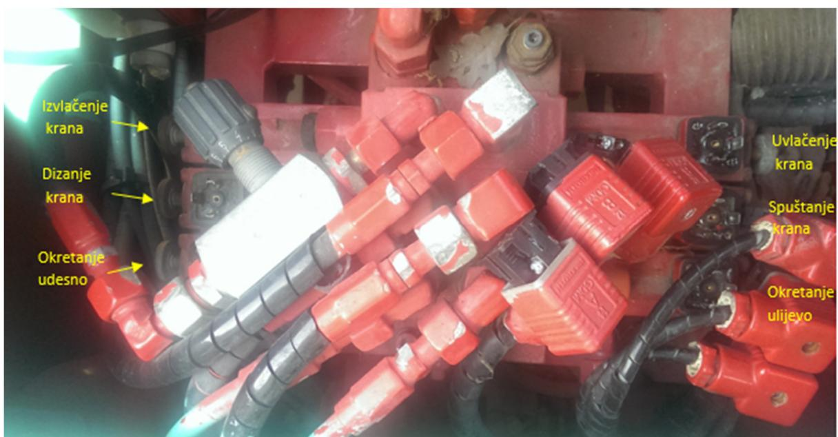
Slika 10. Proporcionalni razvodnici za upravljanje radnom platformom
