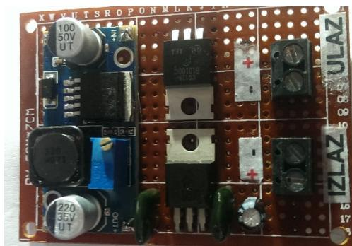
Slika 23. Stabilizator napona
