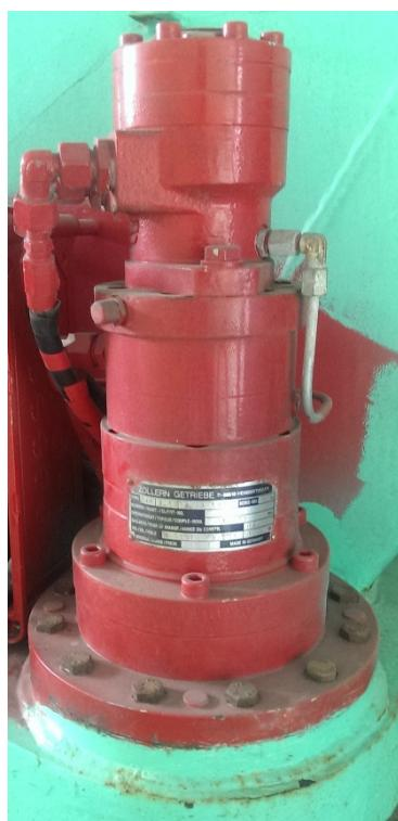
Slika 14. Sklop hidromotora i reduktora
