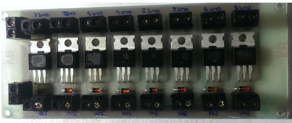
Slika 20. Tiskana pločica za PWM
