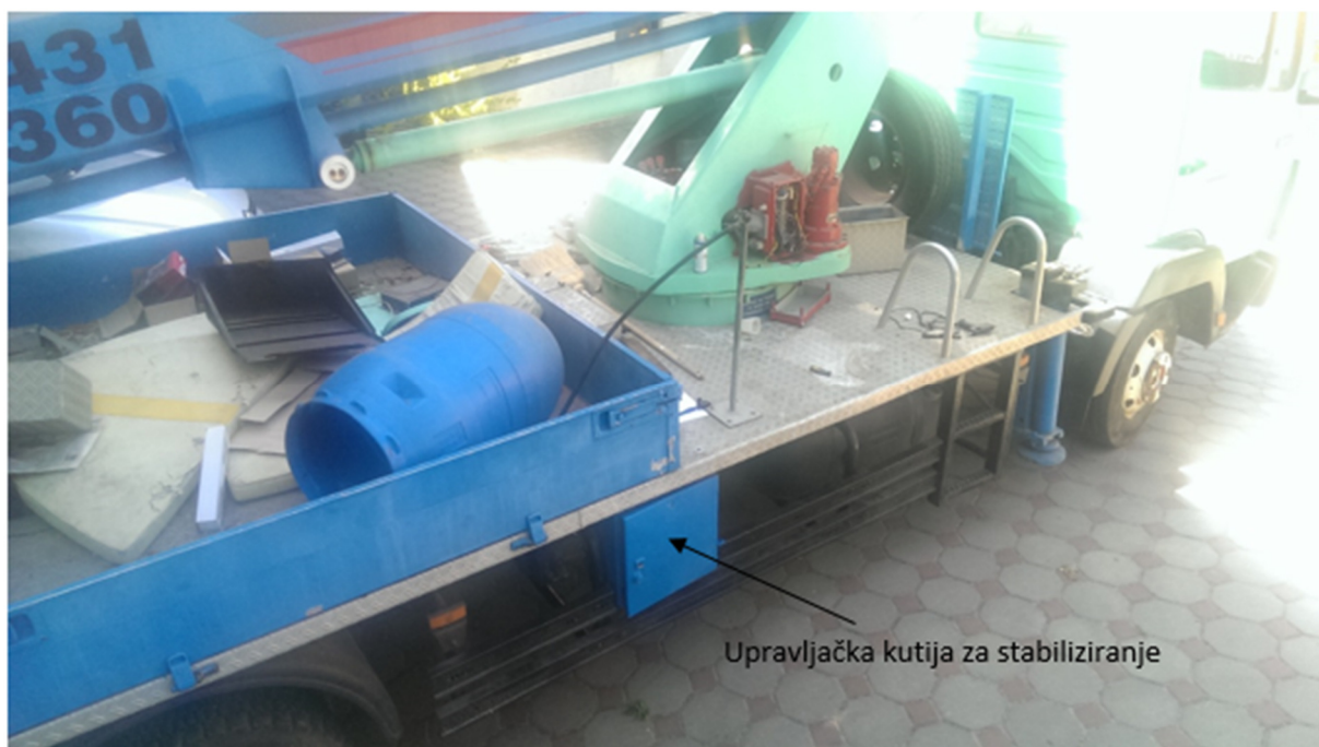
Slika 5. Lokacija ormara za stabilizaciju/nivelaciju
