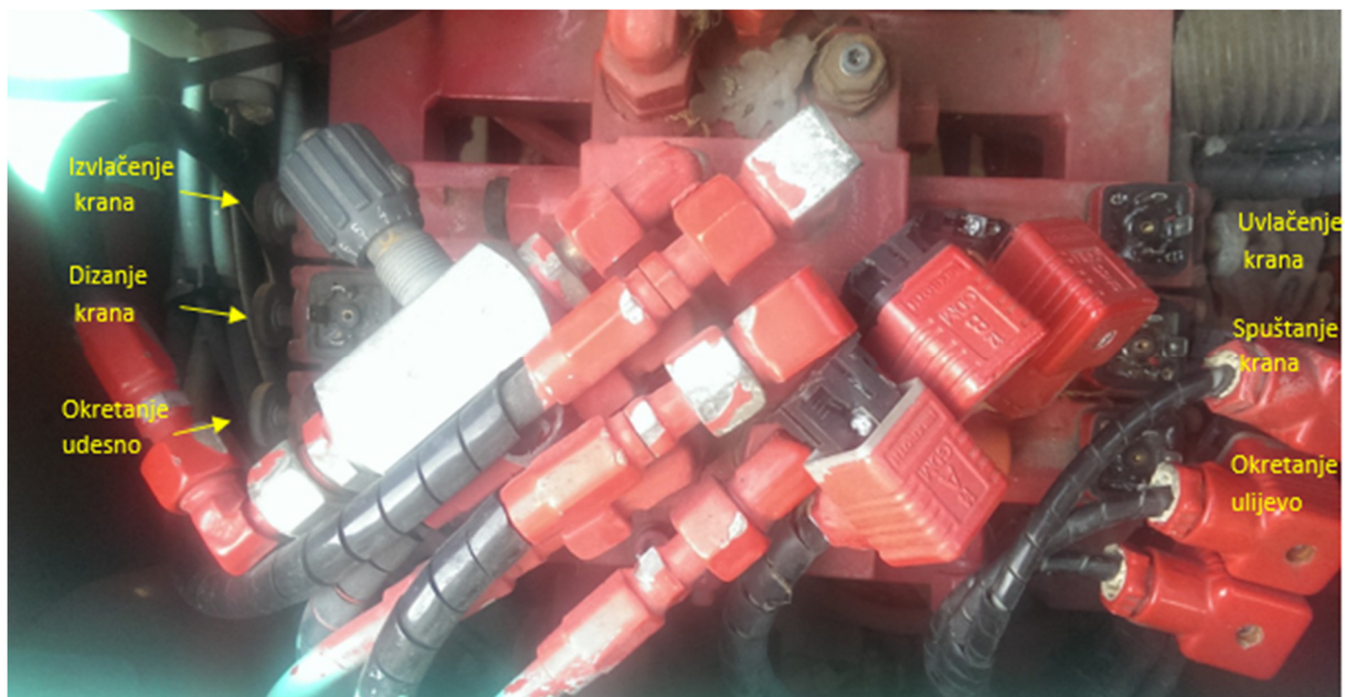
Slika 10. Proporcionalni razvodnici za upravljanje radnom platformom
