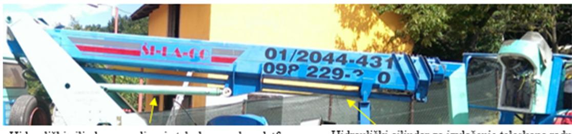
Hidraulički cilindar za podizanje teleskopa radne platforme      Hidraulički cilindar za izvlačenje teleskopa radne platforme
