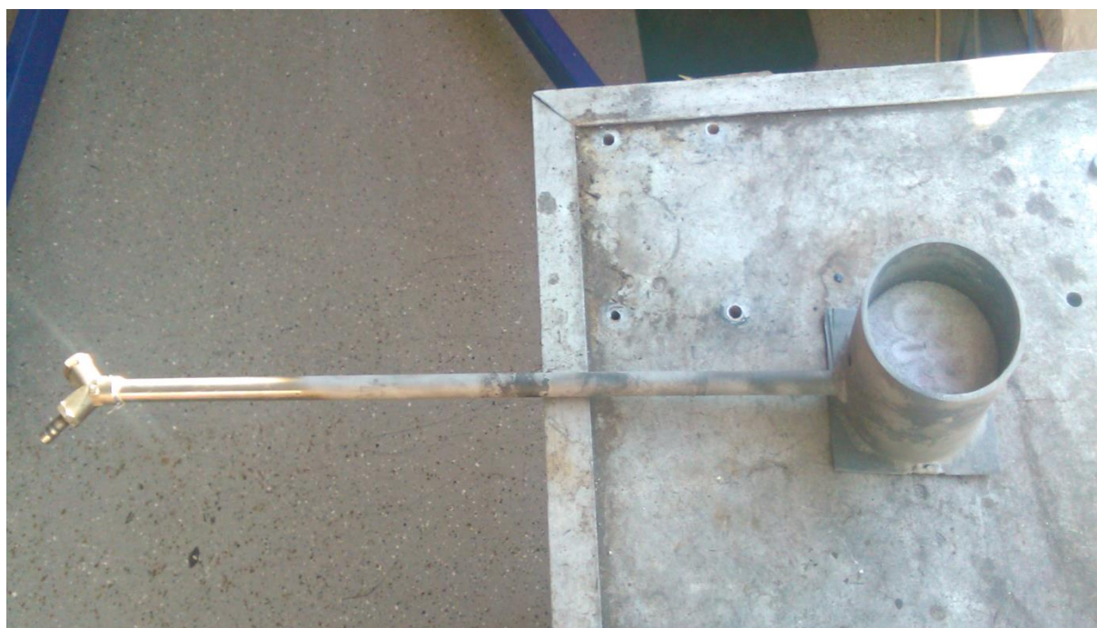
Slika 33. Retorta korištena za aluminiziranje uzoraka
