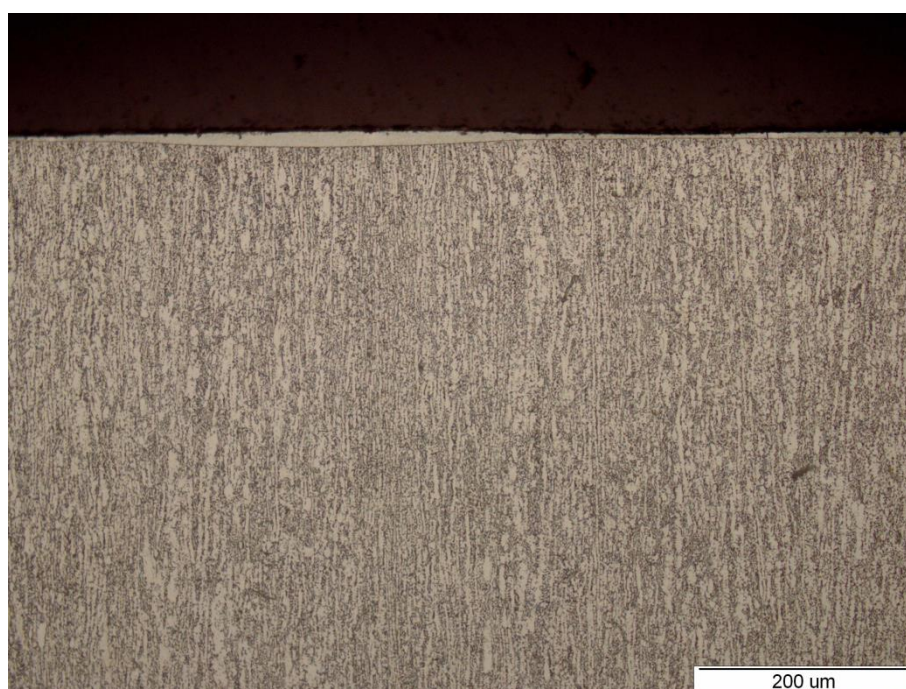
Slika 49. Mikrostruktura rubnog sloja na uzorku legure Ti6Al4V aluminizirane pri 640 °C u trajanju 6 sati, nagriženo u NITAL-u
