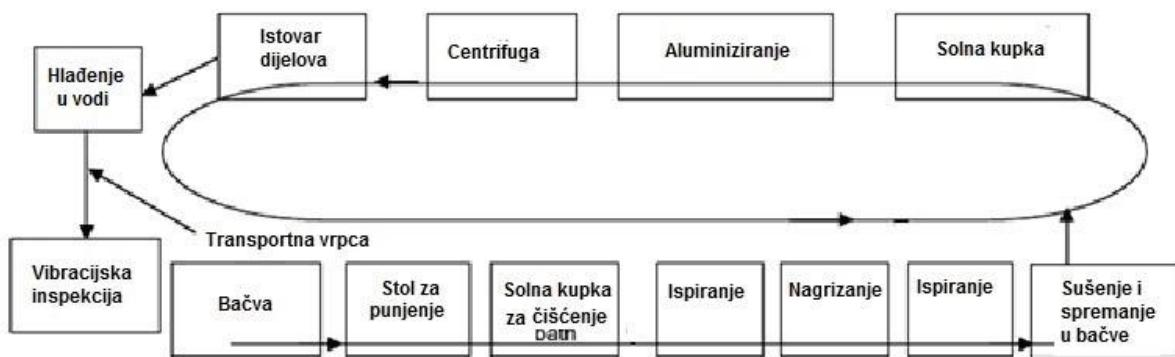
Slika 18. Shematski prikaz automatizirane proizvodnje aluminijskih prevlaka [15]
