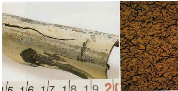
Slika 14. Opća korozija [6]
