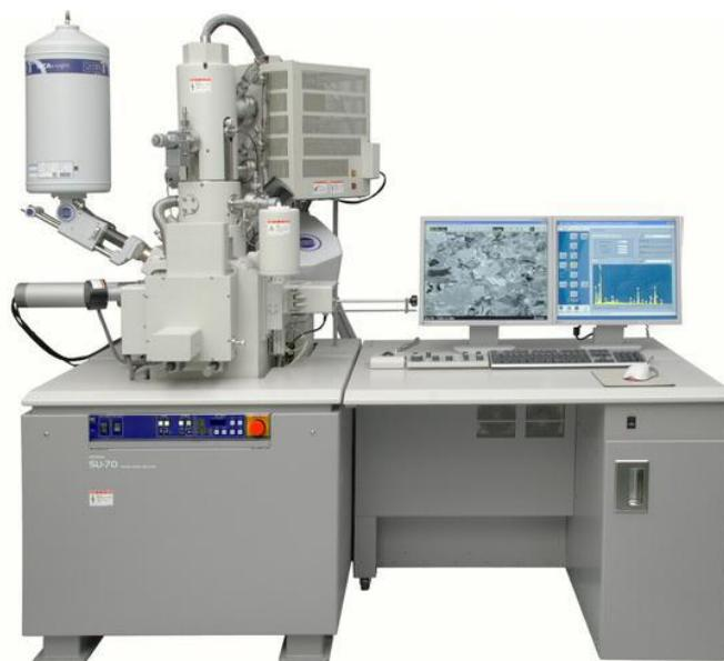
Slika 41. Uređaj za SEM/EDX analizu
