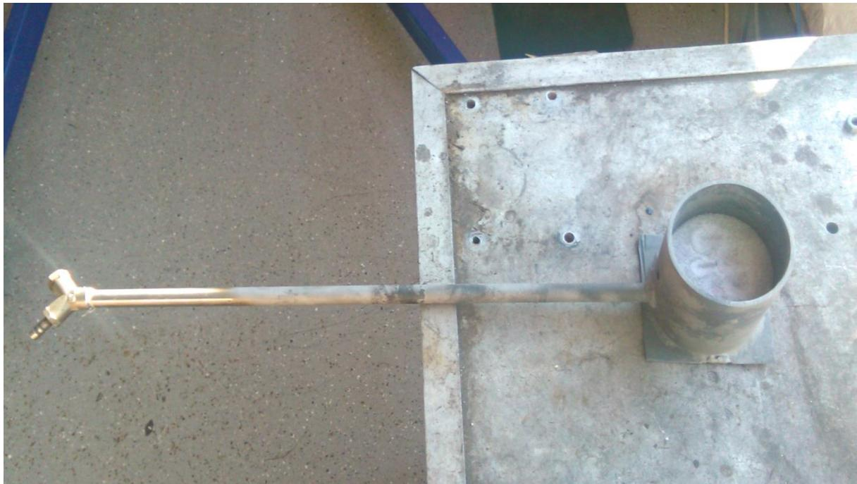
Slika 33. Retorta korištena za aluminiziranje uzoraka
