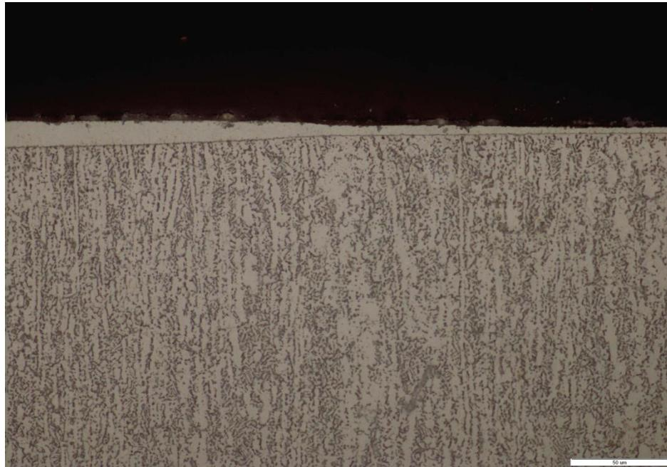
Slika 50. Mikrostruktura rubnog sloja na uzorku, 500x
