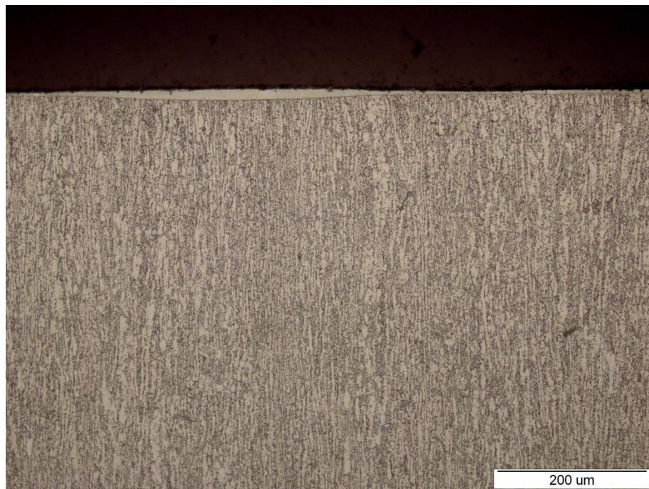
Slika 49. Mikrostruktura rubnog sloja na uzorku legure Ti6Al4V aluminizirane pri  $640\text{ }^{\circ}\text{C}$  u trajanju 6 sati, nagriženo u NITAL-u
