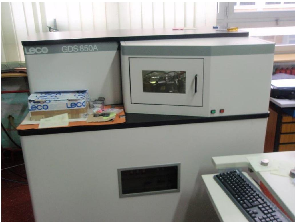
Slika 36. Uređaj LECO GDS 850A za optičku emisijsku spektrometriju
