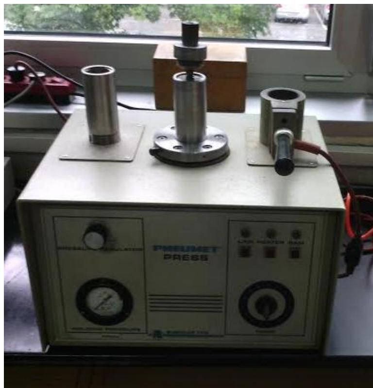
Slika 43. Uređaj Buehler pmeumet press
