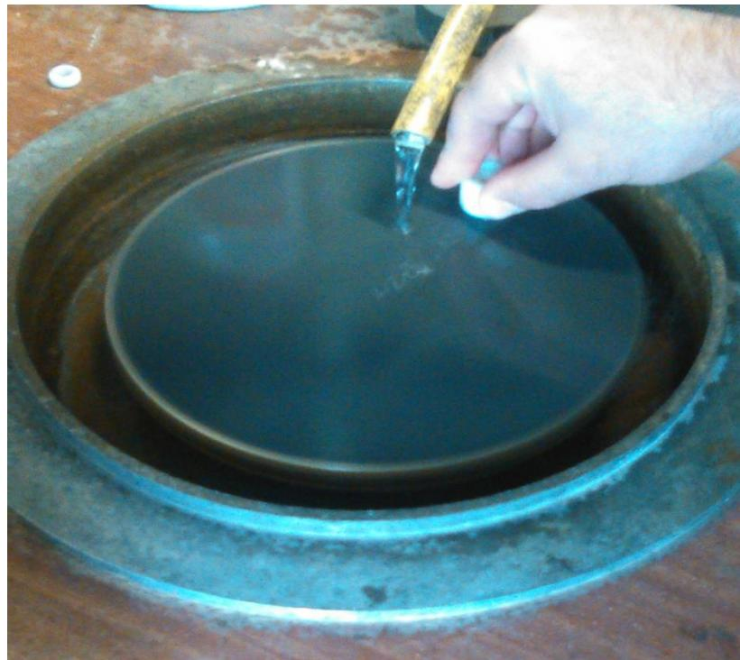
Slika 31. Prikaz ručnog poliranja uzorka
