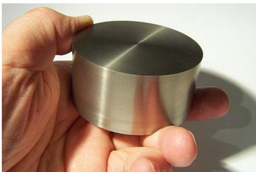
Slika 1. Cilindar od čistog titana [2]
