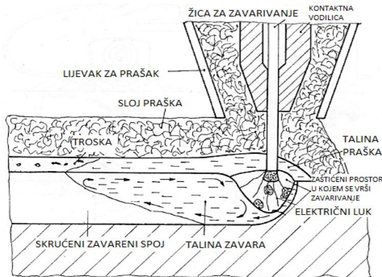
Slika 1. Shematski prikaz procesa taljenja kod EPP zavarivanja [2]
