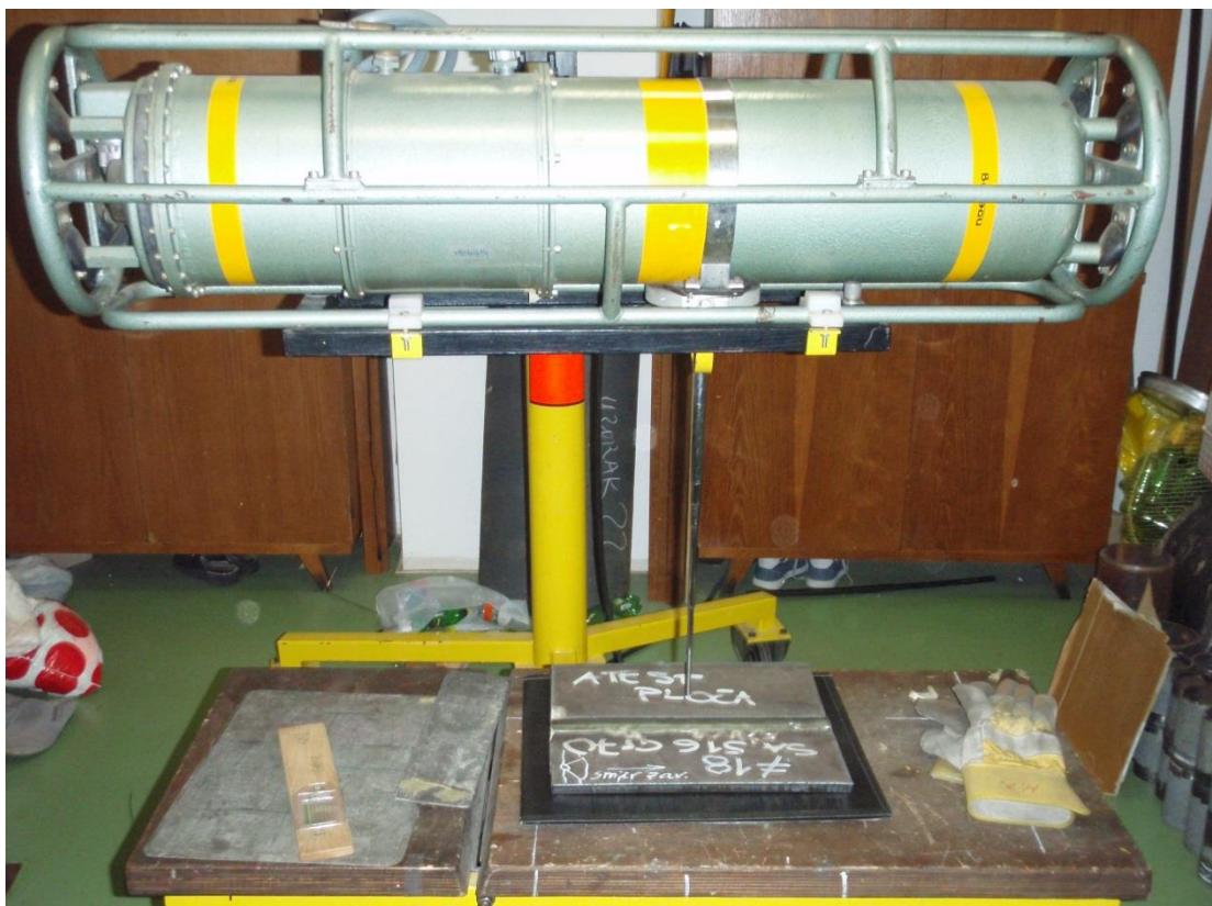
Slika 52. Radni komad pripremljen za radiografsko ispitivanje [29]
