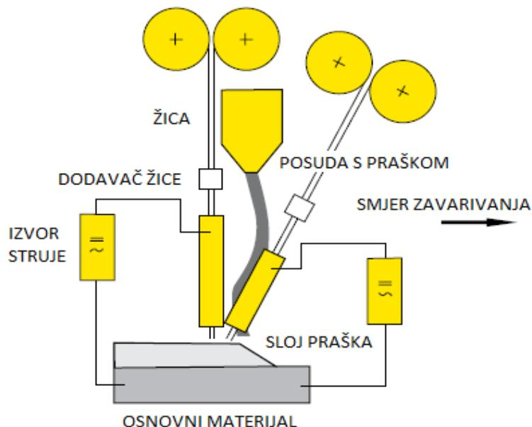
Slika 19. Shematski prikaz dvostrukе tandem tehnike EPP zavarivanja [3]
