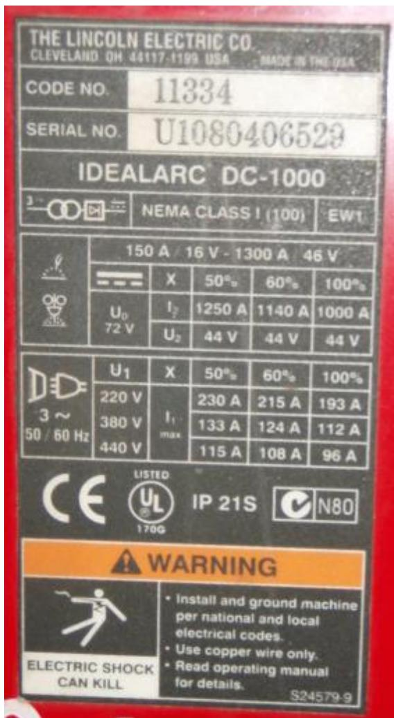
Slika 42. Identifikacijska pločica uređaja *Lincoln Electric, Idealarc – DC 1000* [29]
