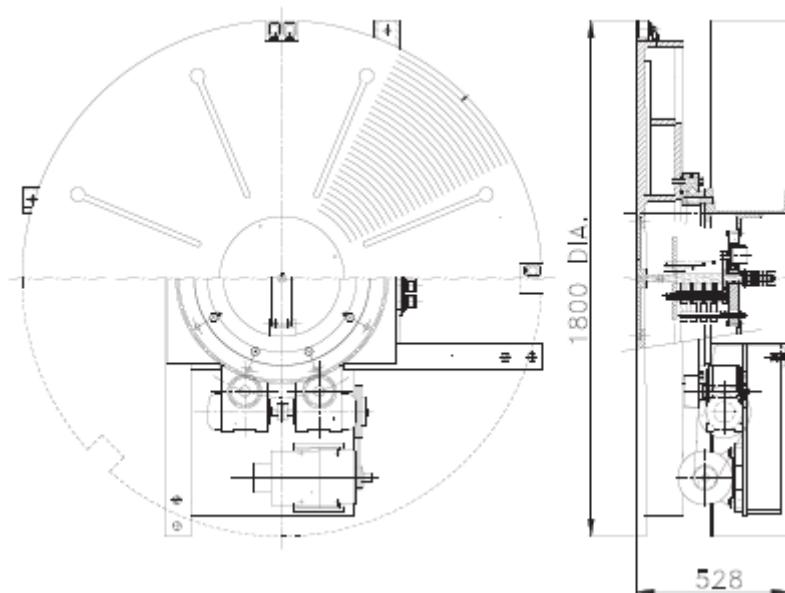
Slika 34. Shematski prikaz okretnog stola za cilindrične dijelove [15]
