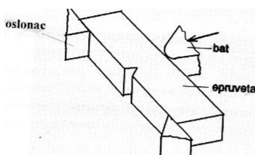
Slika 70. Način udarnog djelovanja bata na epruvetu [36]
