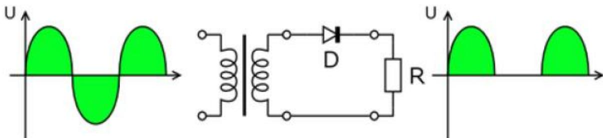
Slika 22. Blok dijagram poluvalnog ispravljača [16]
