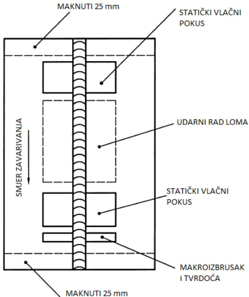
Slika 54. Shematski prikaz mjesta vađenja uzoraka za mehanička ispitivanja [35]
