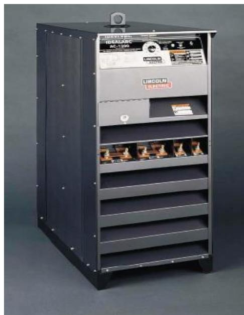
Slika 25. Transformatorski izvor struje za EPP zavarivanje AC – 1200 [15]
