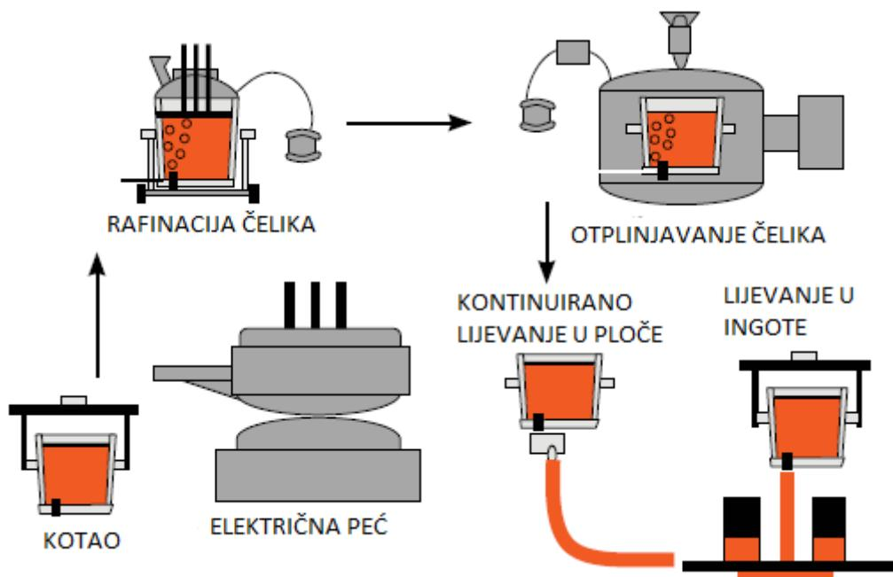
Slika 36. Proces proizvodnje čelika SA516 Gr70 [26]
