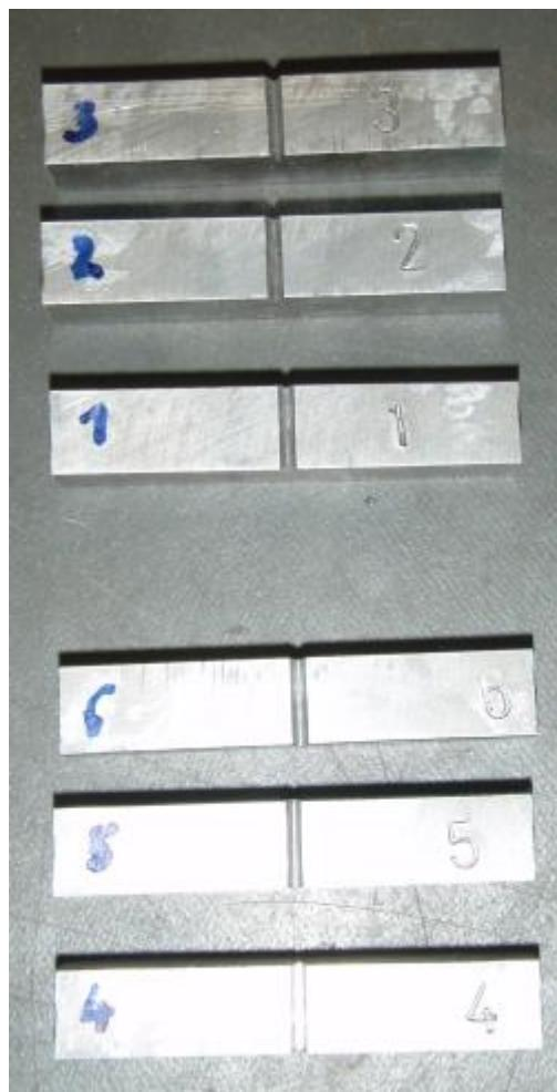
Slika 71. Uzorci za ispitivanje udarne radnje loma [29]
