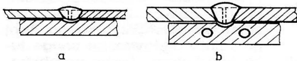
Slika 11. Podloge za zavarivanje prvog sloja [4]
