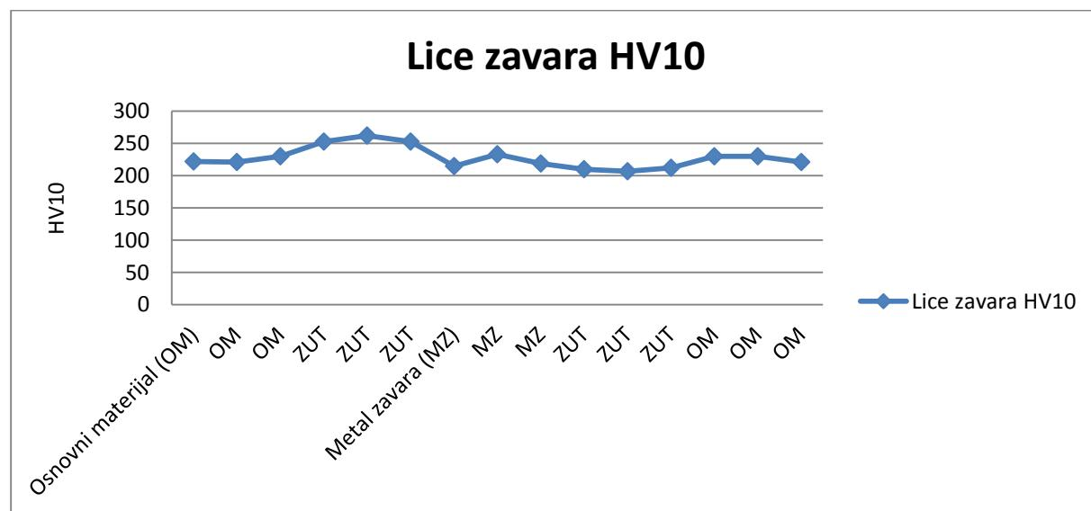
Slika 66. Grafički prikaz tvrdoće izmjerene na licu zavara metodom HV10
