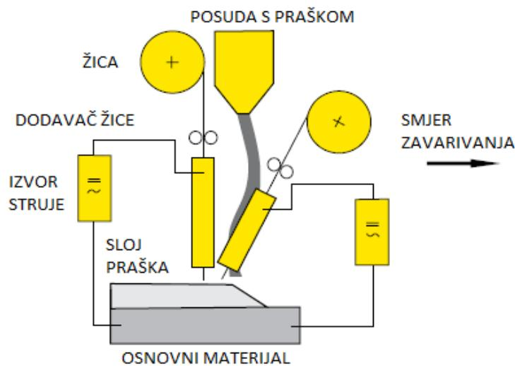
Slika 18. Shematski prikaz tandem tehnike EPP zavarivanja [3]
