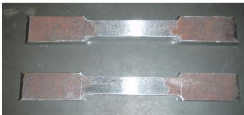
Slika 58. Epruvete za statičko vlačno ispitivanje, strojno obrađene na zadane mjere [29]
