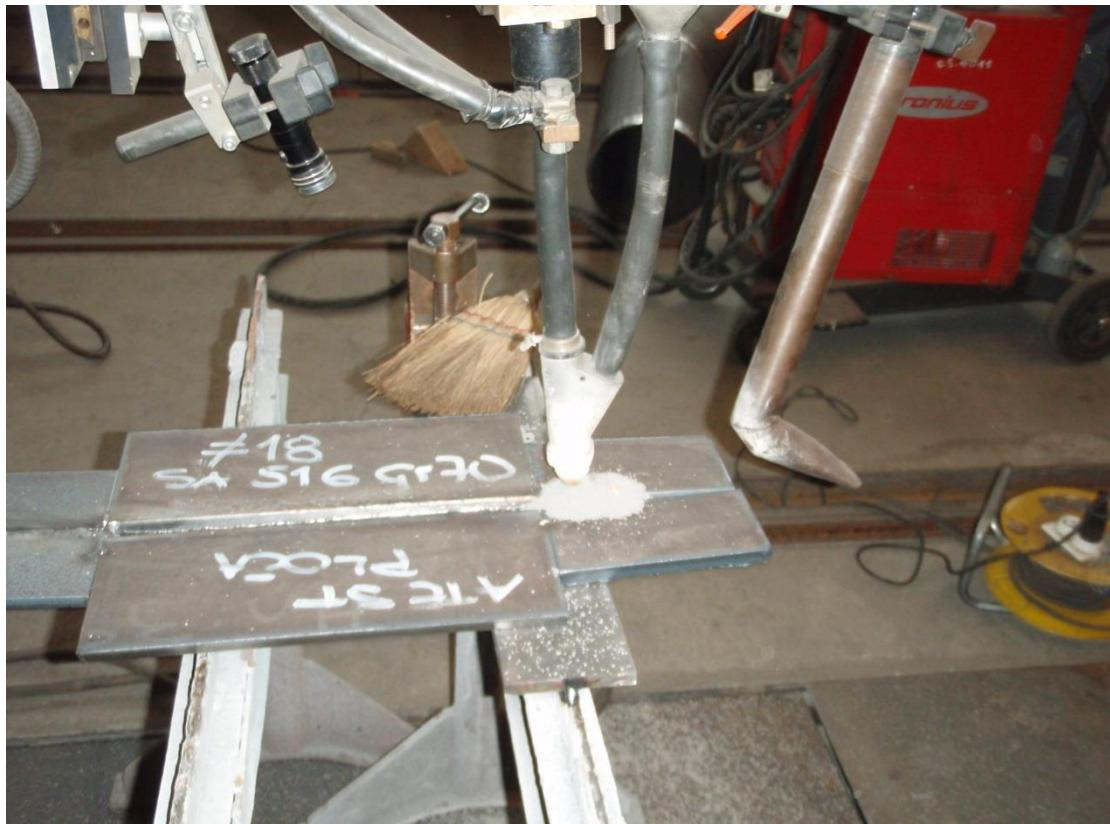
Slika 45. Uspostava električnog luka kod EPP zavarivanja [29]
