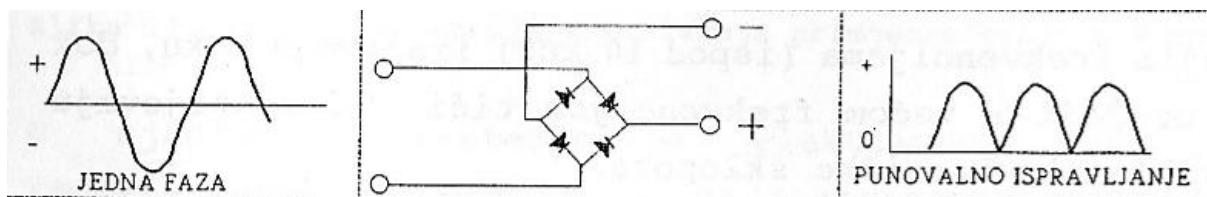
Slika 23. Blok dijagram punovalnog ispravljača sa Graetzovim spojem [1]
