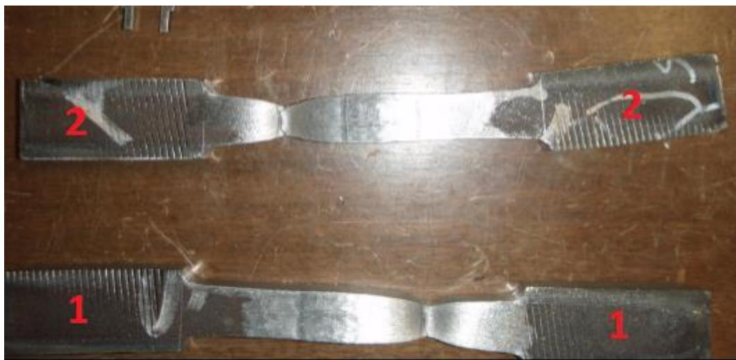
Slika 60. Epruvete nakon procesa kidanja [29]
