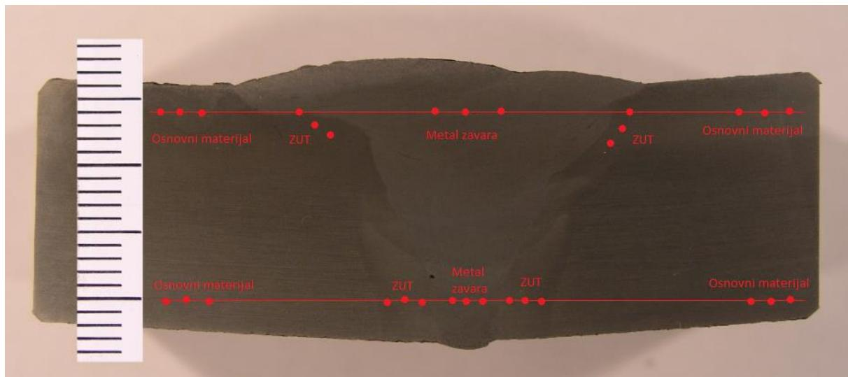
Slika 65. Raspored mjerenja tvrdoće metodom HV10 na makroizbrusku [29]
