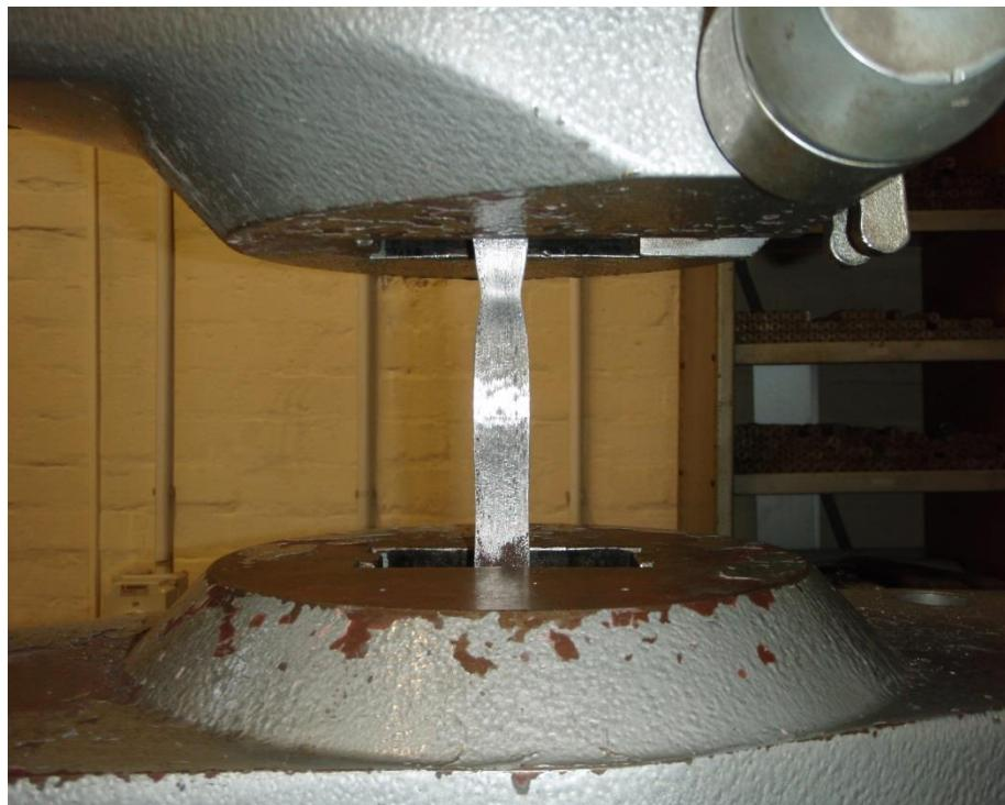
Slika 59. Ispitni uzorak u čeljustima kidalice [29]
