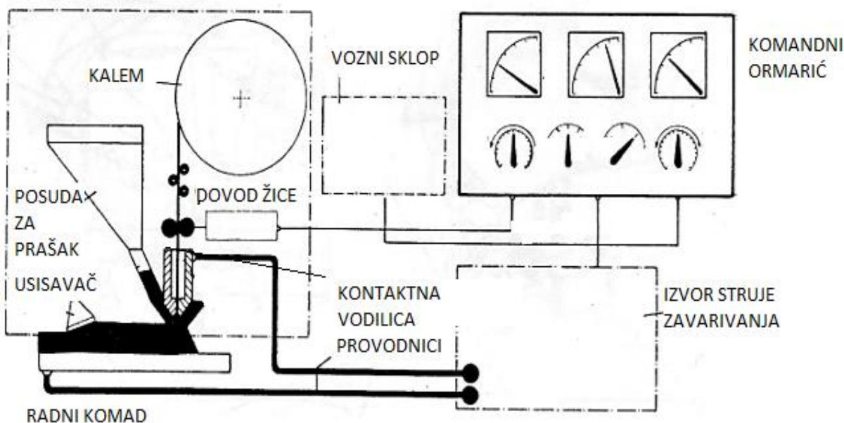
Slika 2. Shematski prikazan proces EPP zavarivanja [2]
