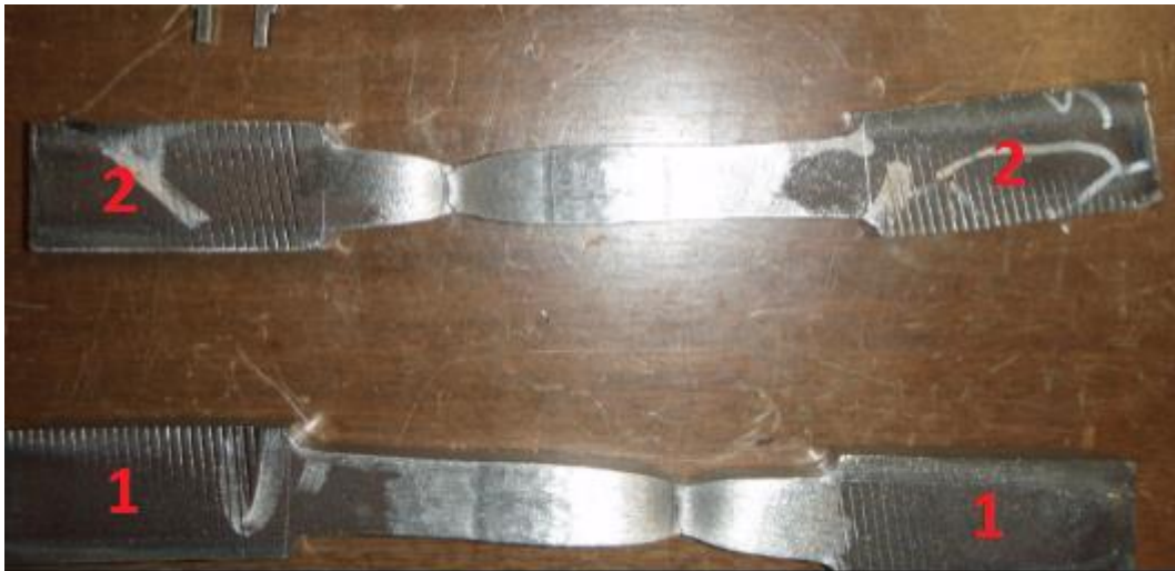
Slika 60. Epruvete nakon procesa kidanja [29]
