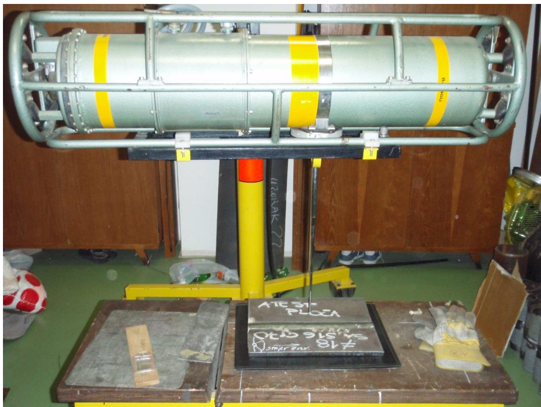
Slika 52. Radni komad pripremljen za radiografsko ispitivanje [29]
