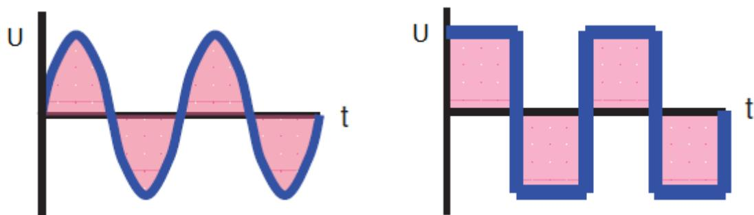
Slika 27. Sinusni i kvadratni valovi dobiveni korištenjem izmjenične struje zavarivanja [15]
