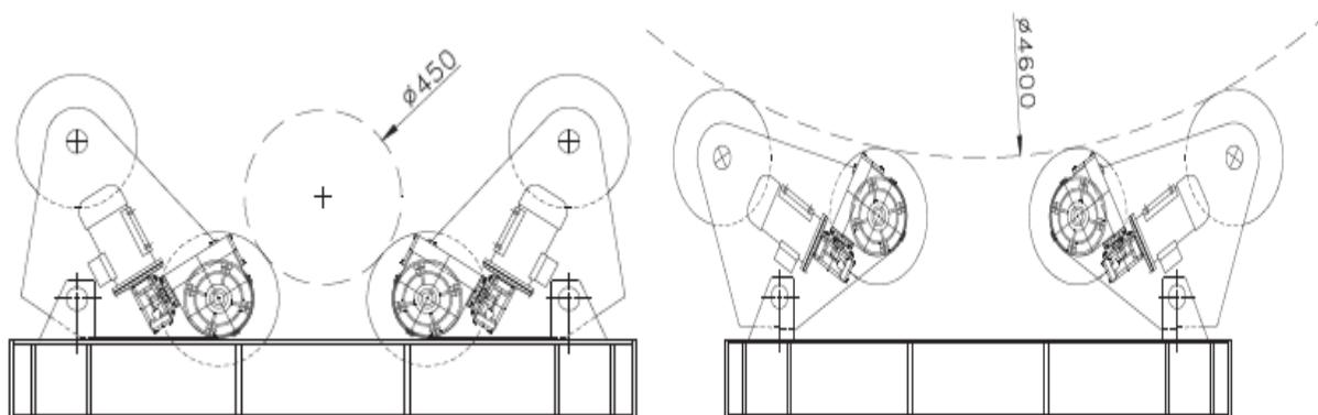
Slika 33. Shematski prikaz okretaljke za cilindrične dijelove [15]
