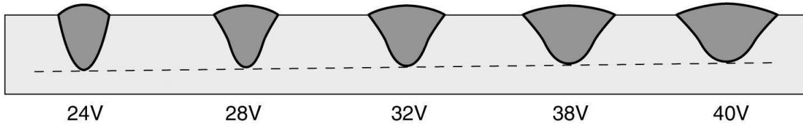
Slika 4. Utjecaj napona zavarivanja na oblik zavarenog spoja [5]
