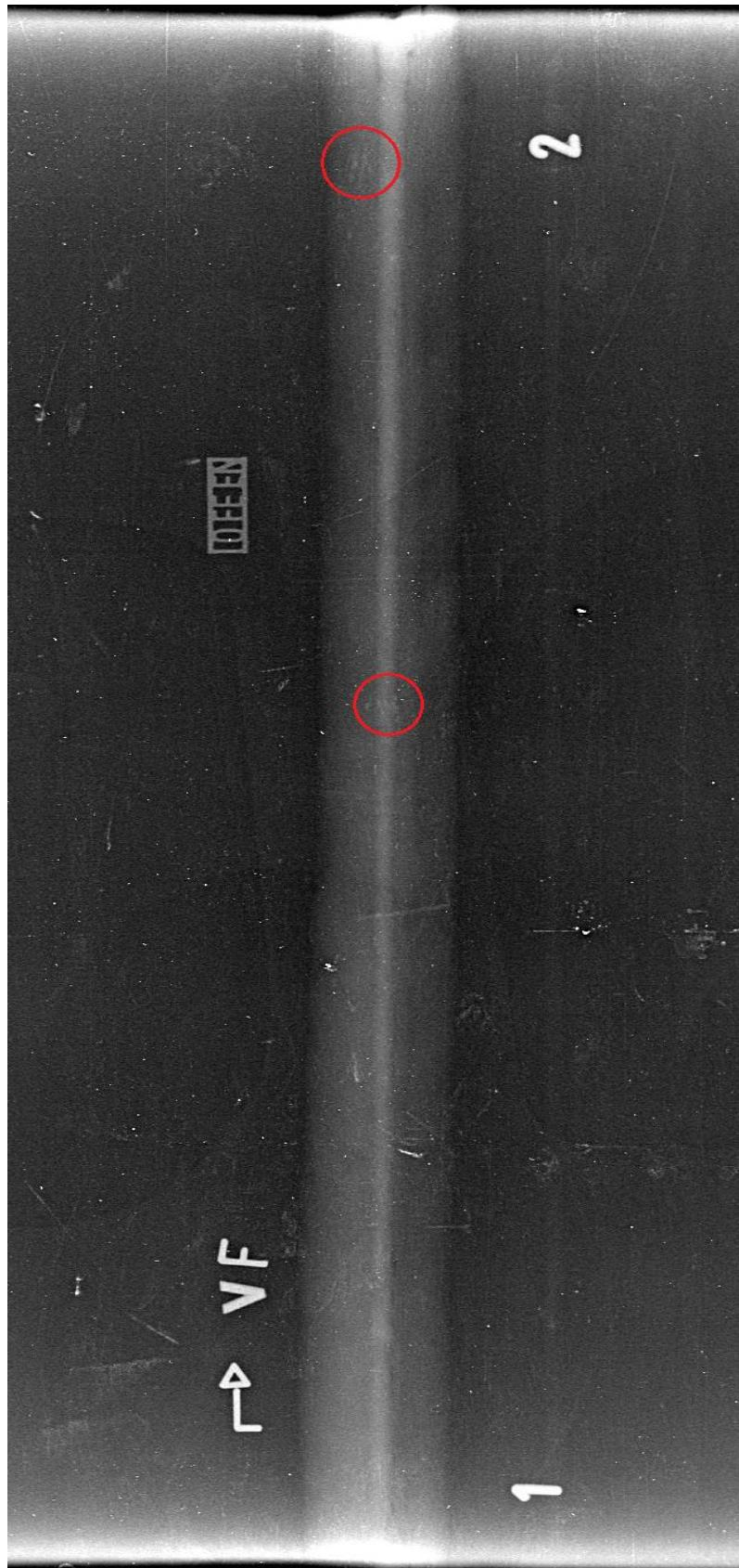
Slika 53. Rezultat radiografskog ispitivanja zavara [29]
