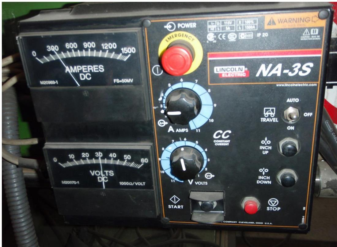
Slika 46. Vrijednosti struje i napona prilikom EPP zavarivanja [29]
