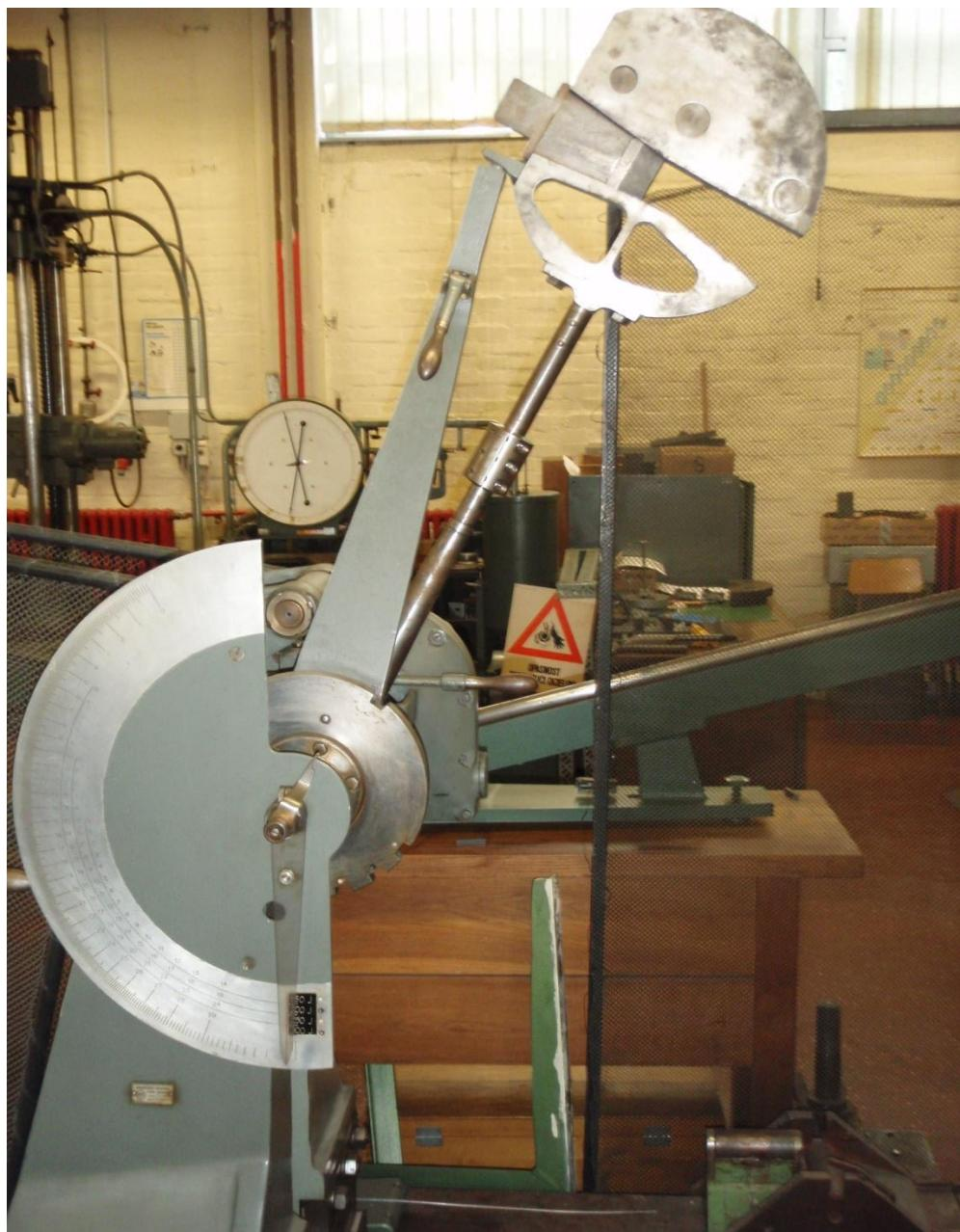
Slika 68. Charpy – ev bat na kojem je mjerena udarni rad loma [29]
