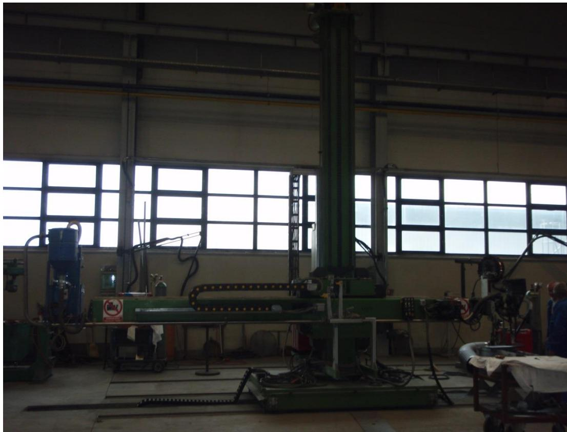
Slika 43. Konzolni nosač na stupu na kojem se nalazi oprema za EPP zavarivanje [29]
