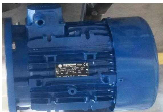
Slika 9. Elektromotor 5AZH 112M-4
