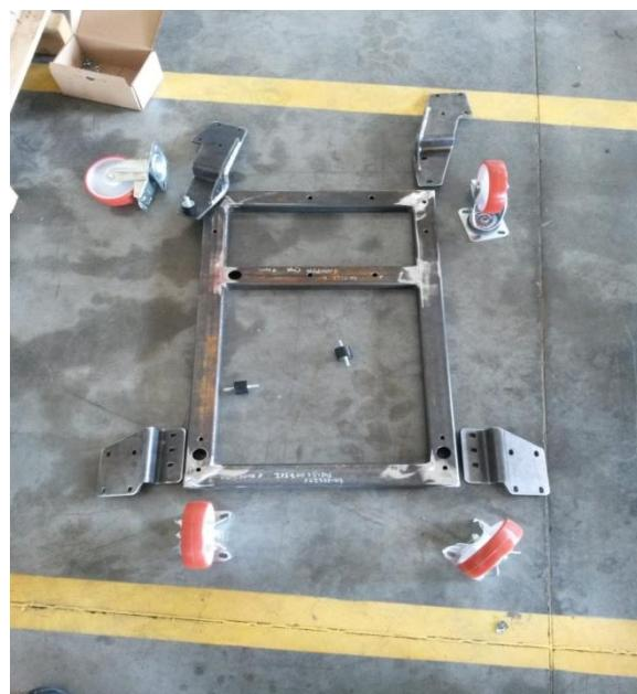
Slika 30. Nosač pogonskog agregata
