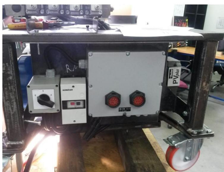
Slika 34. Elektroormar sa pripadajućim sklopkama
