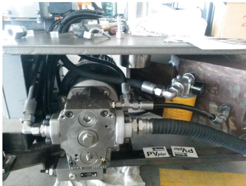
**Slika 36. Spajanje hidraulike**
