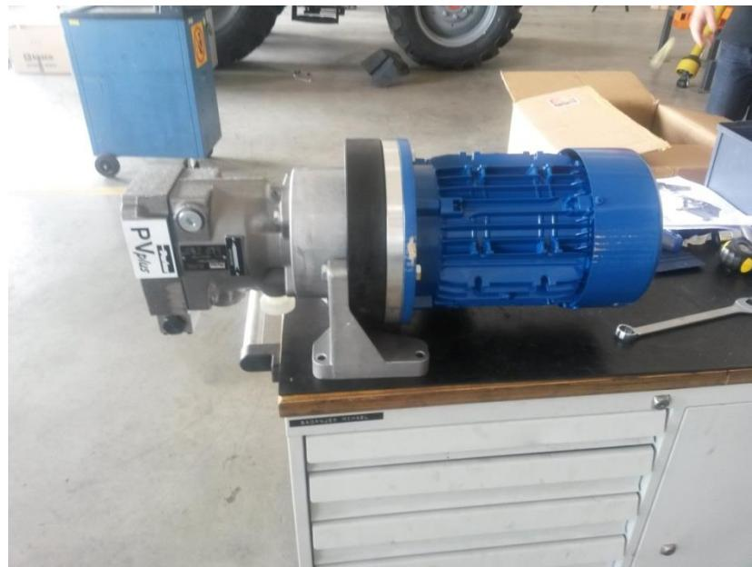
Slika 31. Elektromotor i LS pumpa
