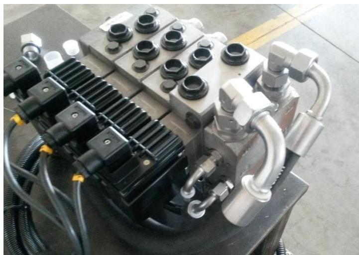
Slika 15. Razvodni ventil PVG32
