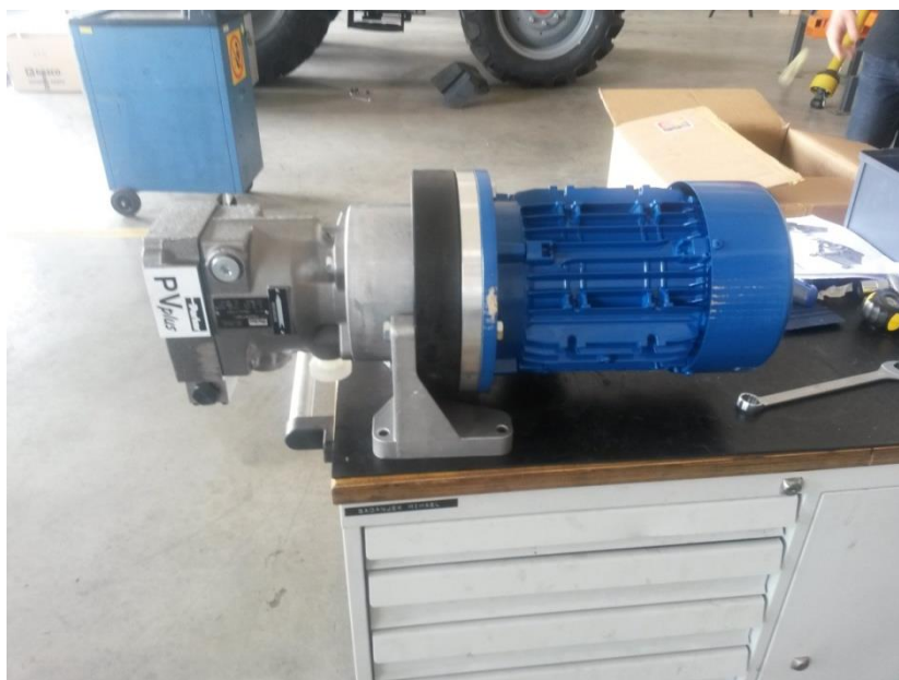
Slika 31. Elektromotor i LS pumpa
