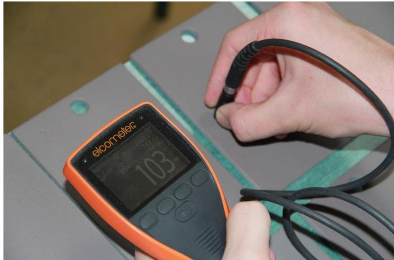
**Slika 43. Mjerenje debljine suhog filma premaza uređajem Elcometer 456**
