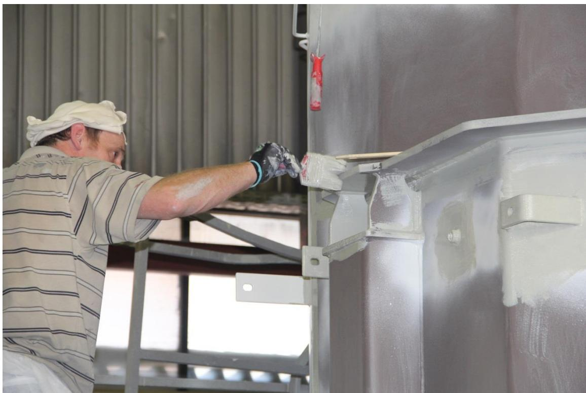
Slika 14. Nanošenje premaza kistom, Končar – Metalne konstrukcije d.d. [2]
