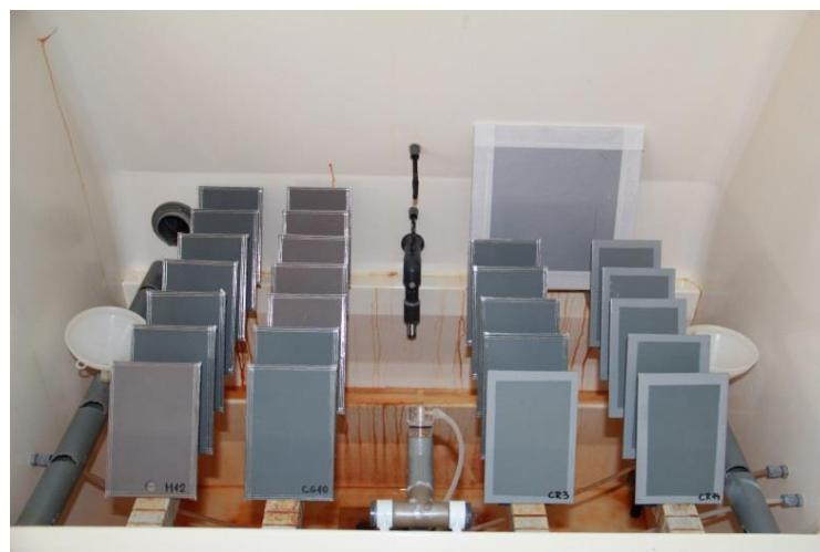
Slika 46. Uzorci u slanoj komori prije ispitivanja
