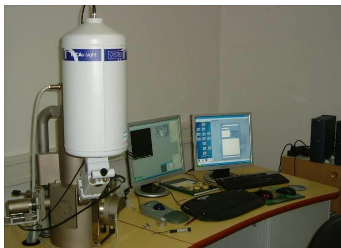
**Slika 51. Skenirajući lektronski mikroskop Tescan Vega 5136 MM i EDX analizator Oxford Instruments**
