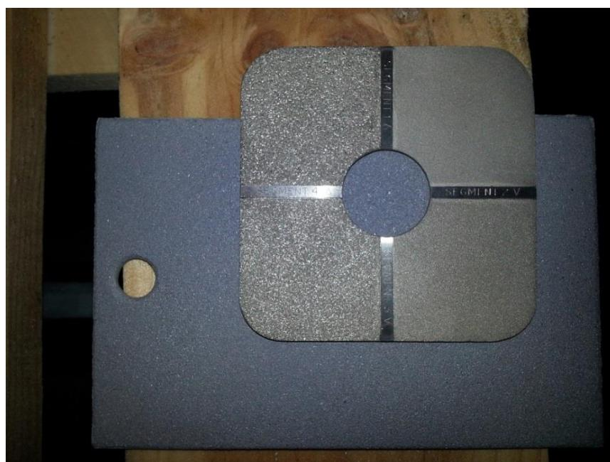
Slika 38. Ocjenjivanje hrapavosti površine pomoću komparatora
