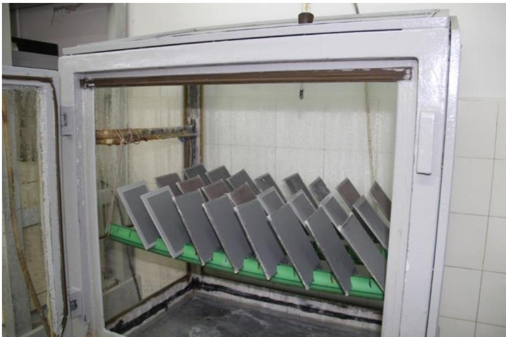
Slika 44. Uzorci u vlažnoj komori na početku ispitivanja
