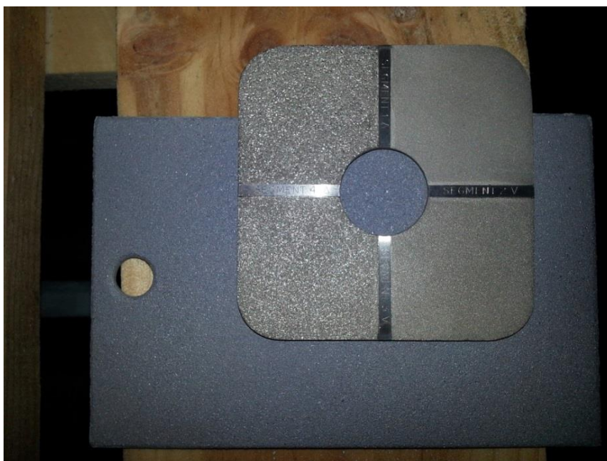
Slika 38. Ocjenjivanje hrapavosti površine pomoću komparatora
