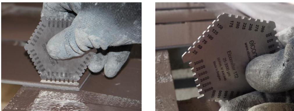
**Slika 42. Mjerenje debljine mokrog filma premaza (DMF) češljjem**
