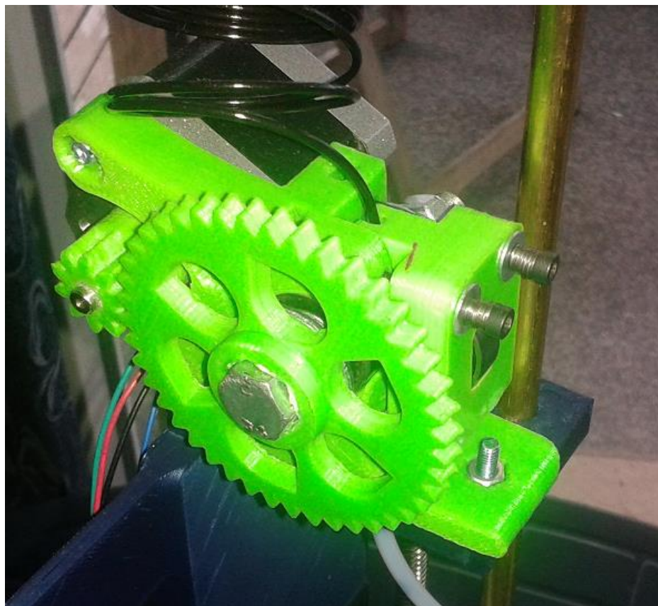
Slika 14: Gornji dio ekstrudera (ispisani dio)
