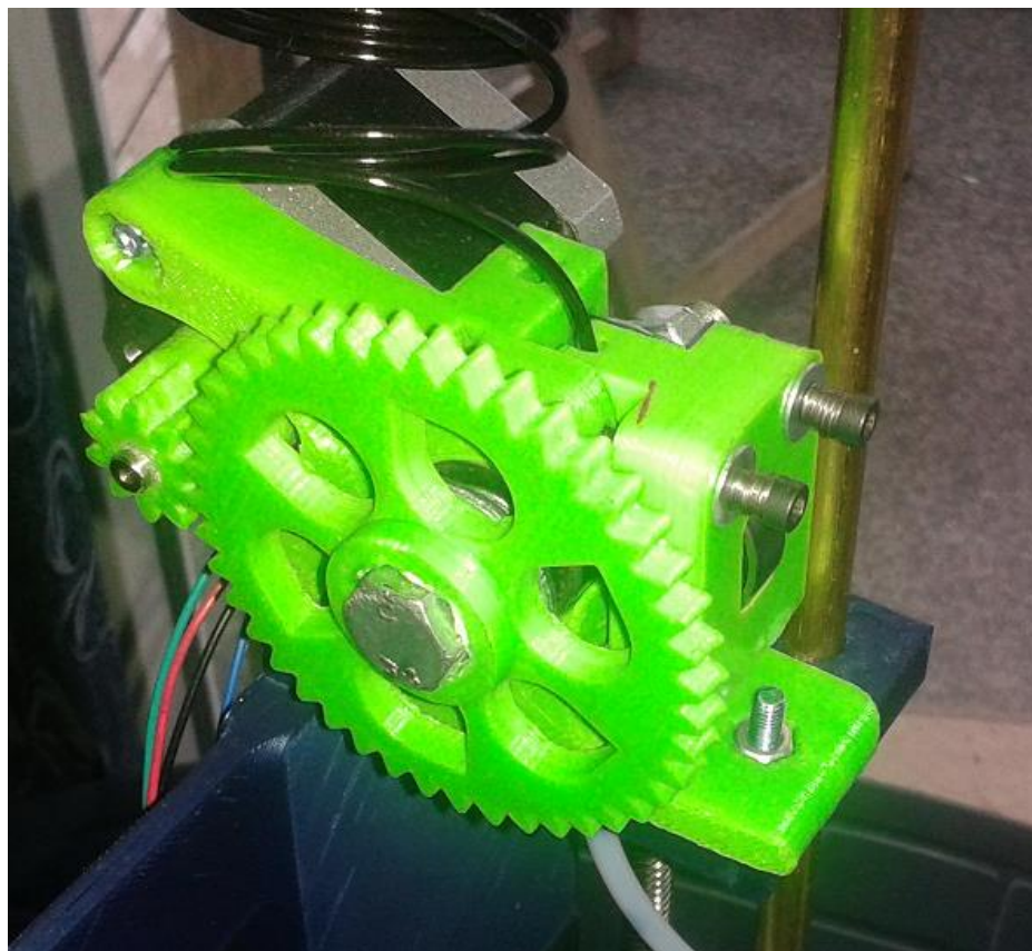
Slika 14: Gornji dio ekstrudera (ispisani dio)
