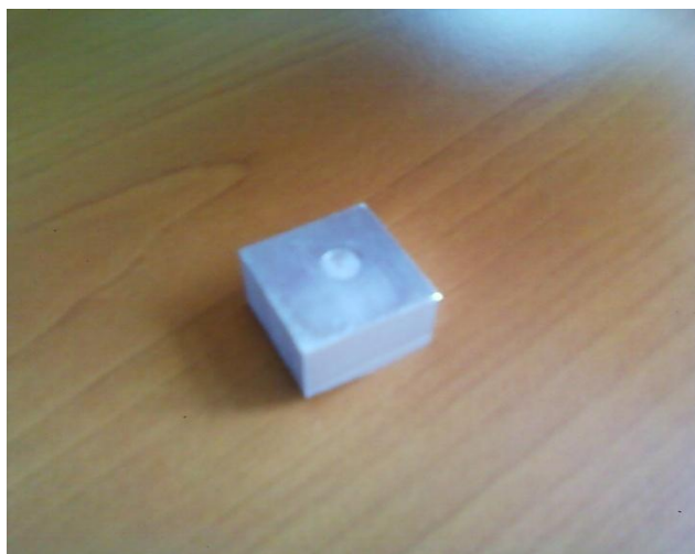
Slika 17. Uzorak "A" nakon analize kemijskog sastava
