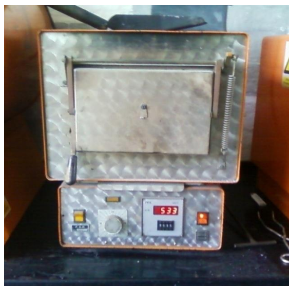
Slika 20. Komorna elektro peč
