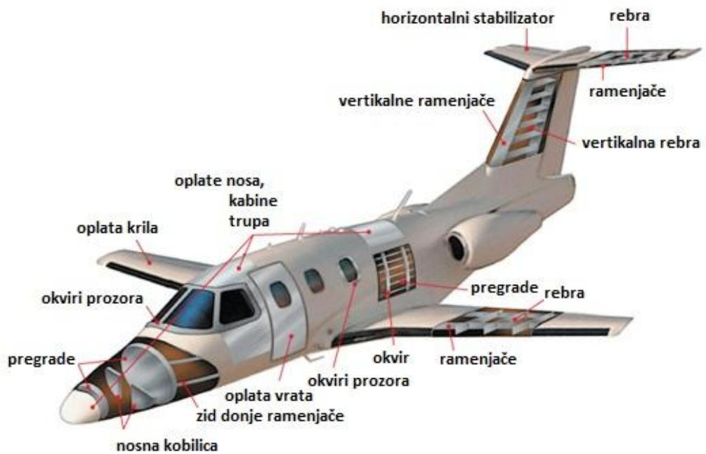
Slika 12. Primjena Al-legura na malom mlažnjaku
