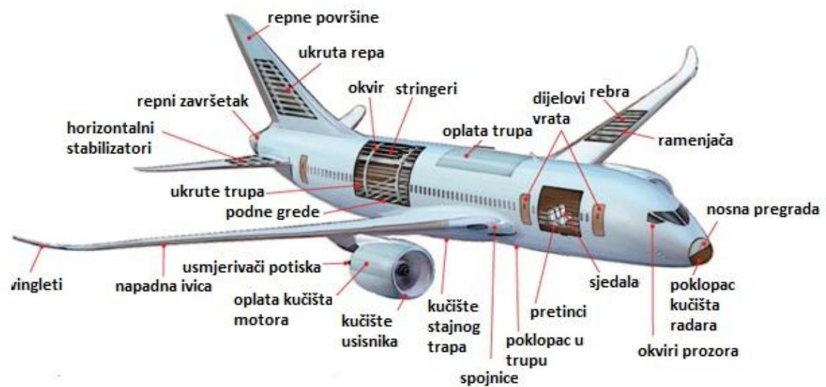
Slika 13. Primjena Al-legura na velikom putničkom zrakoplovu
