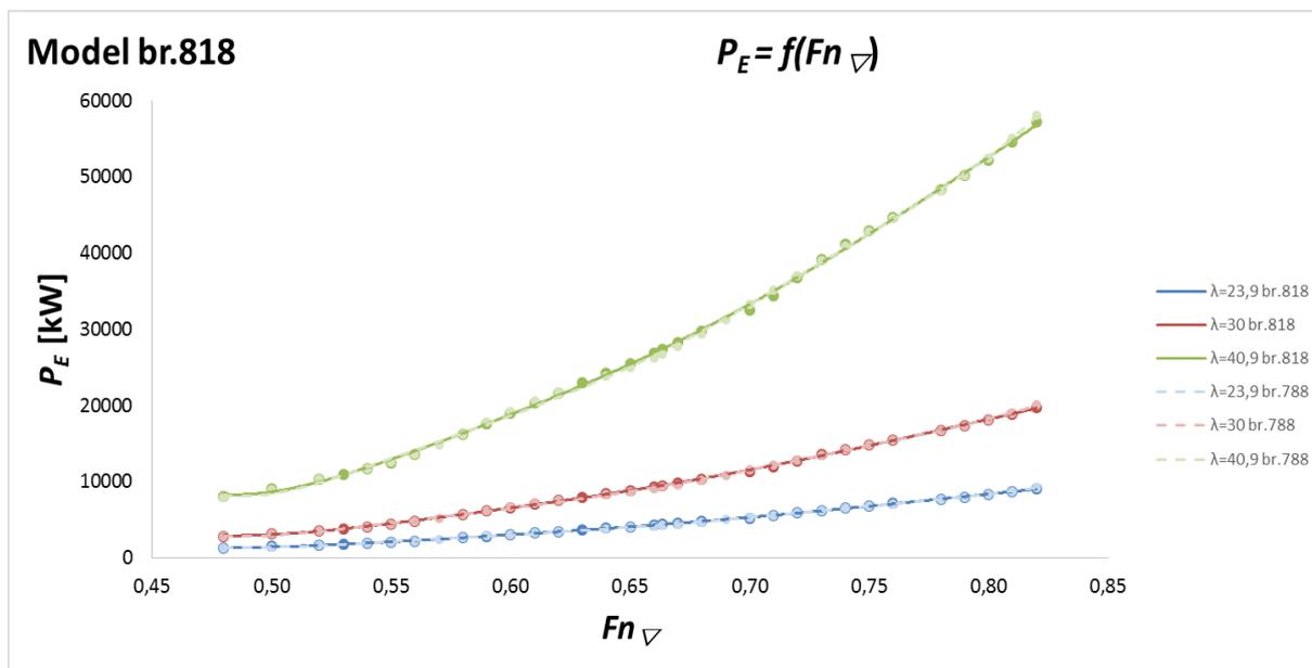
Slika 23. Usporedba krivulja efektivne snage za tri različita mjerila modela br.788 i br.818
