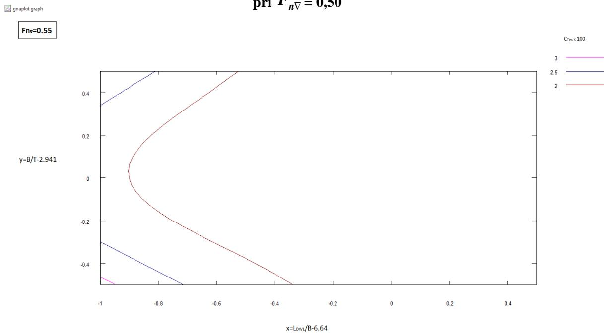
**Slika 47.** Konture funkcije koeficijenta ukupnog otpora  $C_{TV}$  u ovisnosti o  $L_{DWL}/B$  i  $B/T$  pri  $F_{nV} = 0,55$
