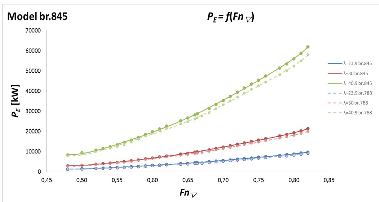
Slika 17. Usporedba krivulja efektivne snage za tri različita mjerila modela br.788 i br.845
