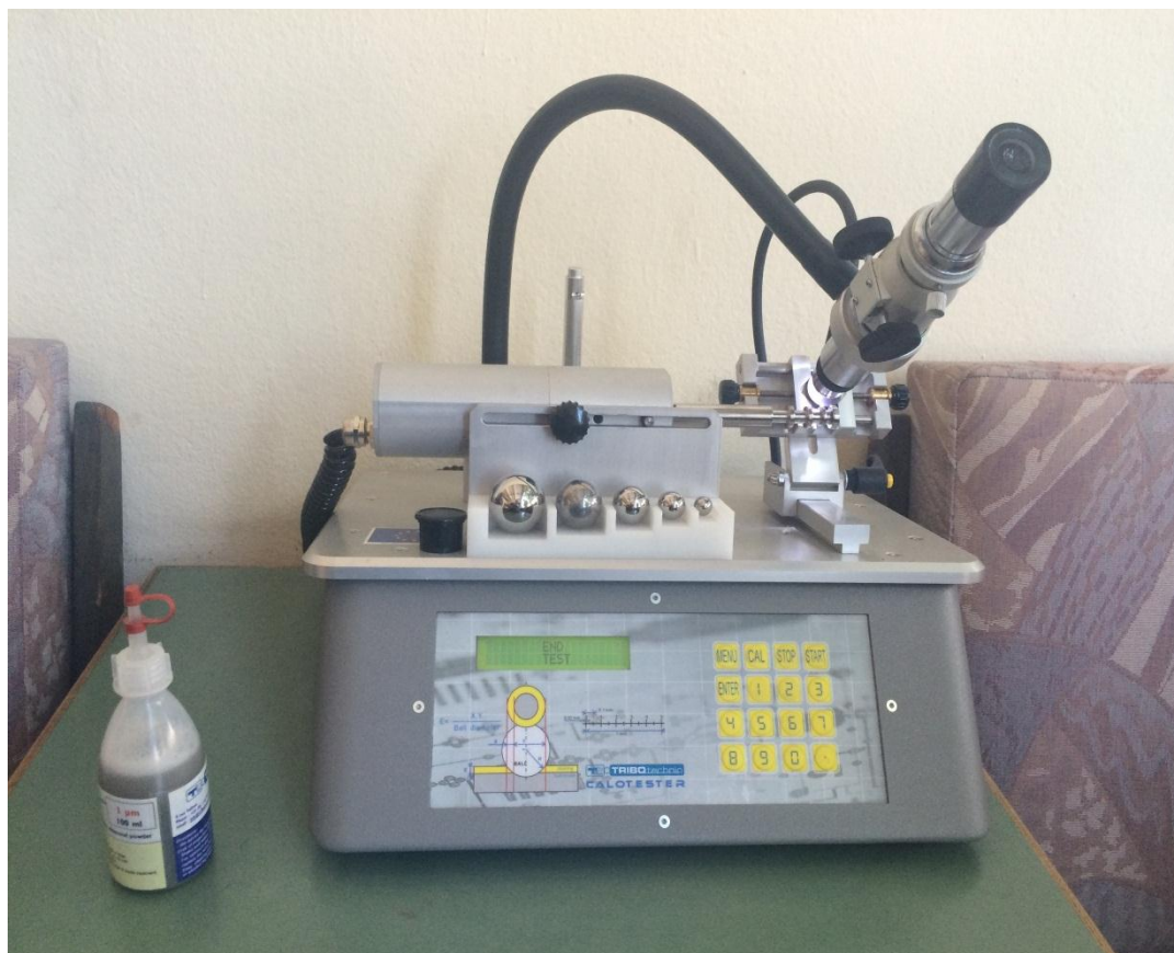
Slika 15: Kalotester za mjerenje debljine slojeva prevlake
