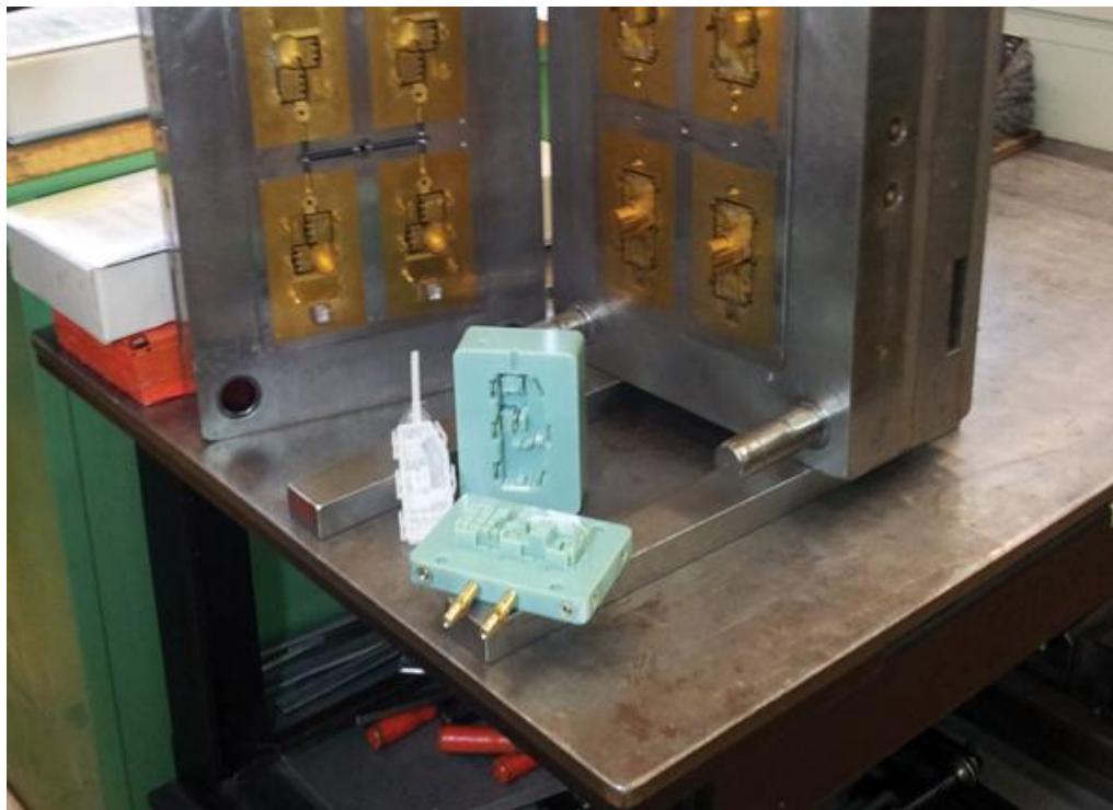
Slika 2: Primjer bakrenog kalupa za injekcijsko prešanje plastomera [18]
