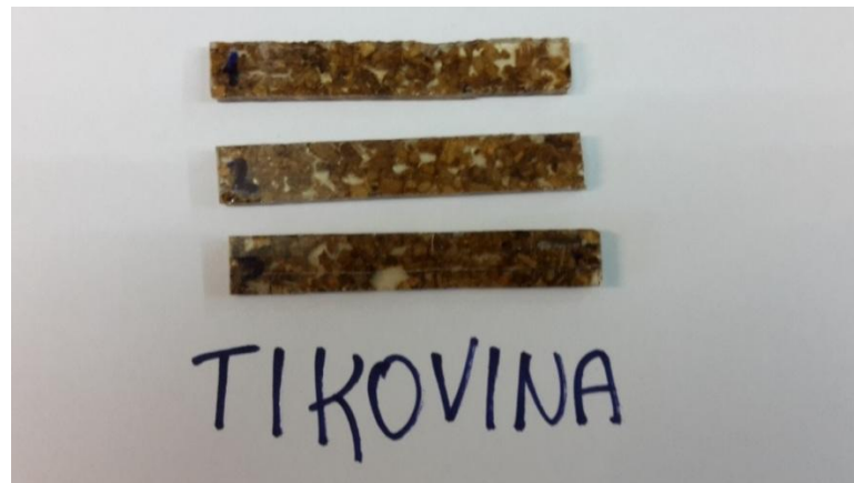
Slika 20. Kompozit s krupnim česticama tikovine
