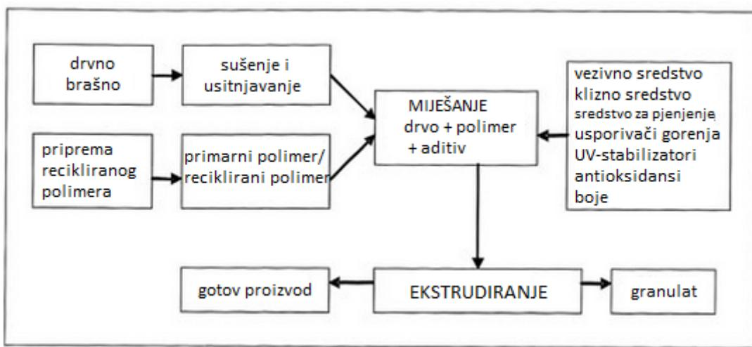
Slika 7. Shematski prikaz procesa ekstrudiranja [16]
