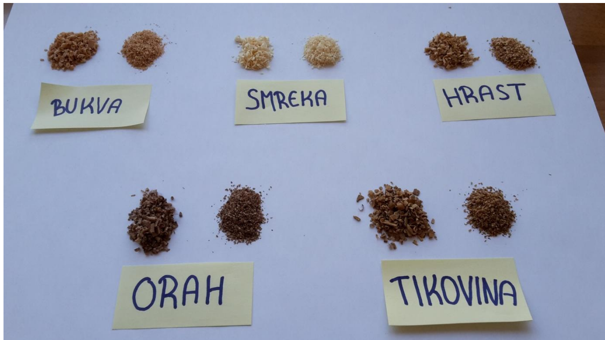
Slika 10. Prosijani uzorci različitih vrsta drva različitih veličina čestica
