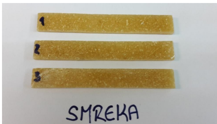
Slika 16. Kompozit sa sitnim česticama smreke
