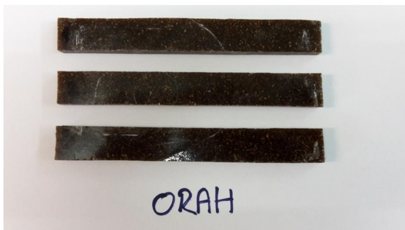
Slika 17. Kompozit s sitnim česticama oraha
