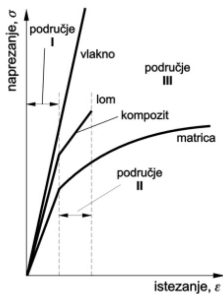
Slika 1. Dijagram naprezanje- istezanje vlaknima ojačanog kompozita [4.]
