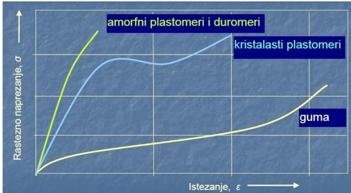
Slika 2. Nominalni dijagram rastezno naprezanje – istezanje [6]
