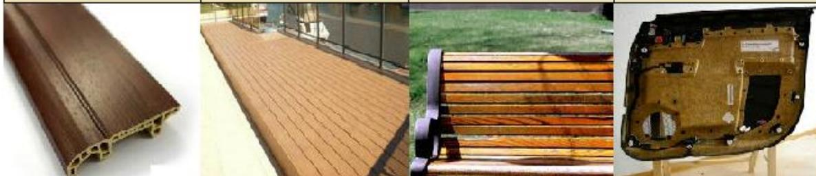
Slika 5. Primjeri primjenedrvno plastičnih kompozita
