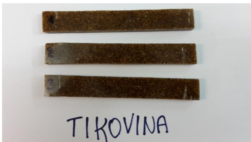
Slika 15. Kompozit sa sitnim česticama tikovine
