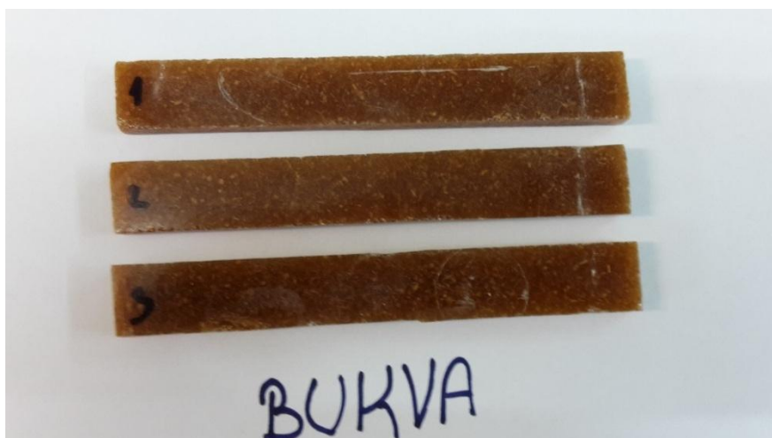
Slika 14. Kompozit sa sitnim česticama bukve
