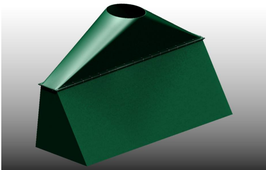
Slika 12. 3D model odsisne haube
