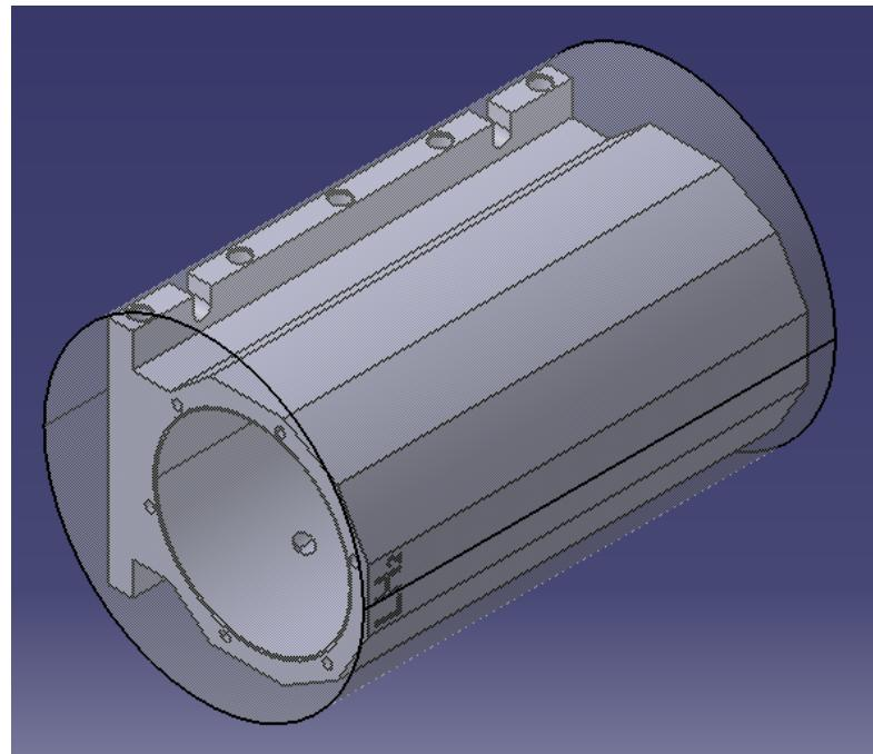
**Slika 14. Prikaz sklopa sirovca i izratka kućišta**
