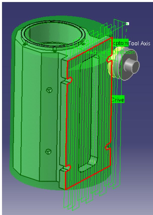
**Slika 20. Obrada baze kućišta u drugom stezanju**
