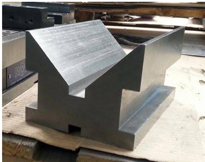
Slika 15. Stezna naprava prvog stezanja - prizma
