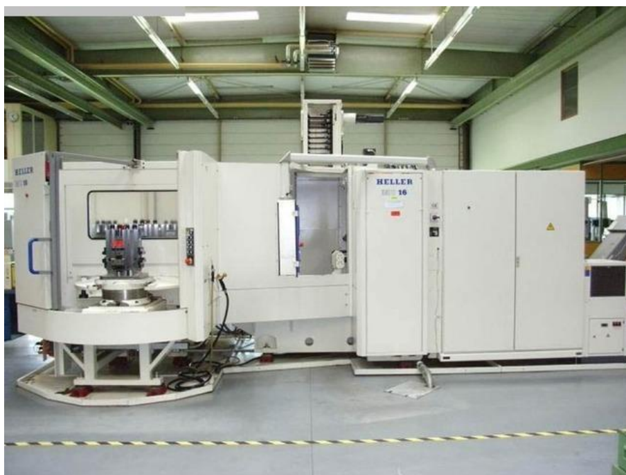
Slika 10. „HELLER MC 16“ – horizontalni obradni centar
