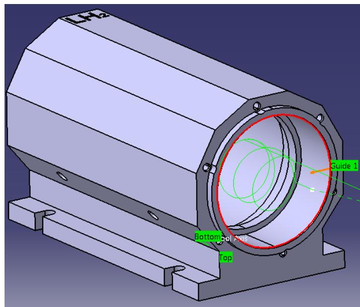
**Slika 27.** Proširivanje prvrt na prednjoj plohi kućišta
