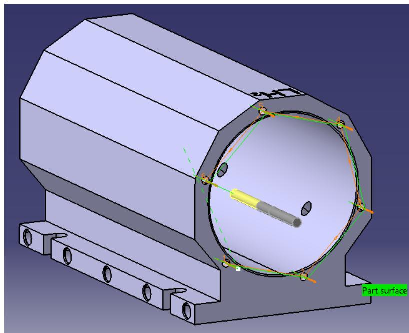
**Slika 28. Izrada bušne slike na stražnjoj plohi kućišta**
