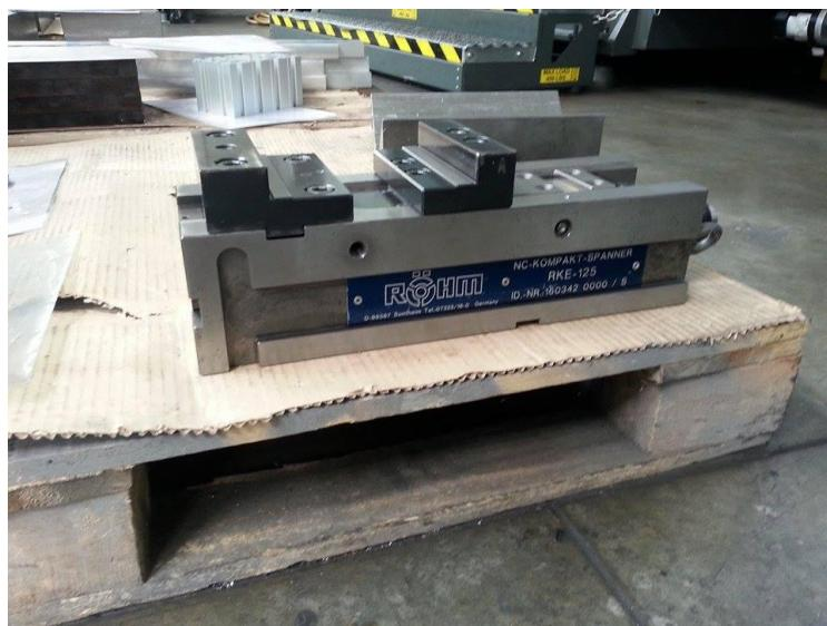
Slika 24. Stezna naprava trećeg stezanja - škripac
