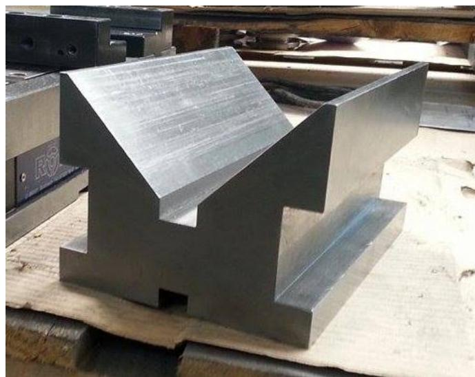
**Slika 15. Stezna naprava prvog stezanja - prizma**
