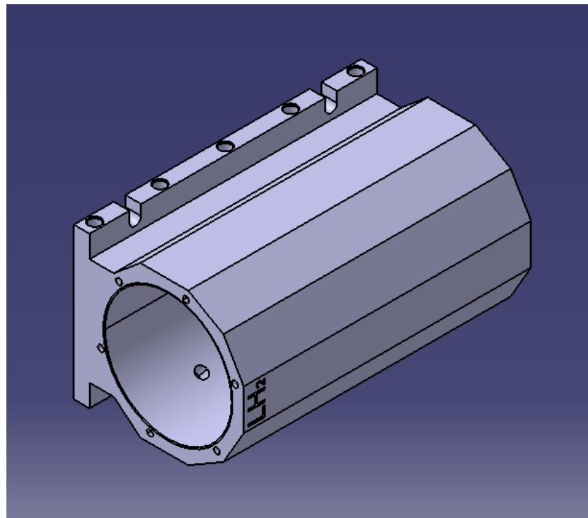
Slika 12. Prikaz modela kućišta motora u *Part Designu*
