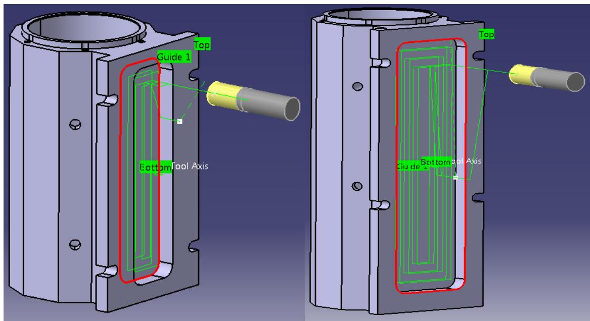
Slika 35. Usporedba obrade džepa na dnu baze kućišta zadalog i parametriziranog modela
