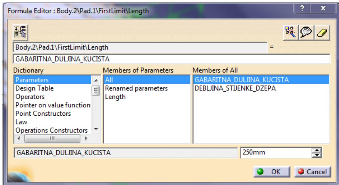
Slika 30. Povezivanje značajke modela s kreiranim parametrom
