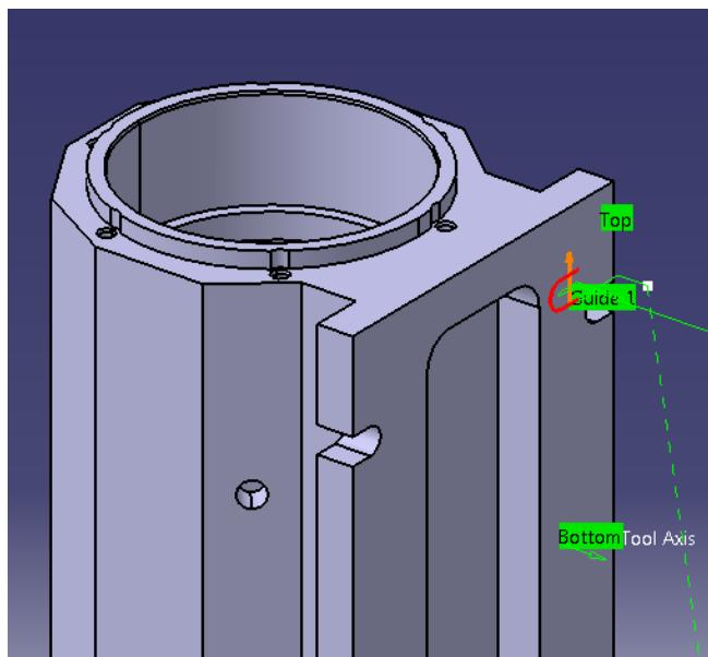
**Slika 22. Obrada utora na bočnoj strani baze kućišta**
