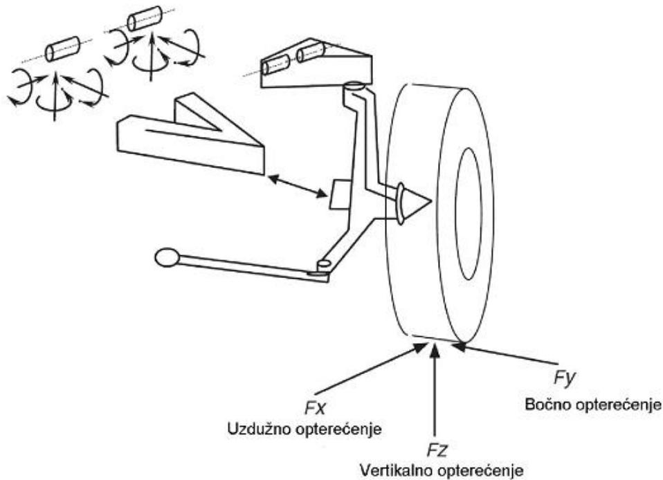
Slika 2. Vrste opterećenja na kontaktu gume i podloge, [1].
