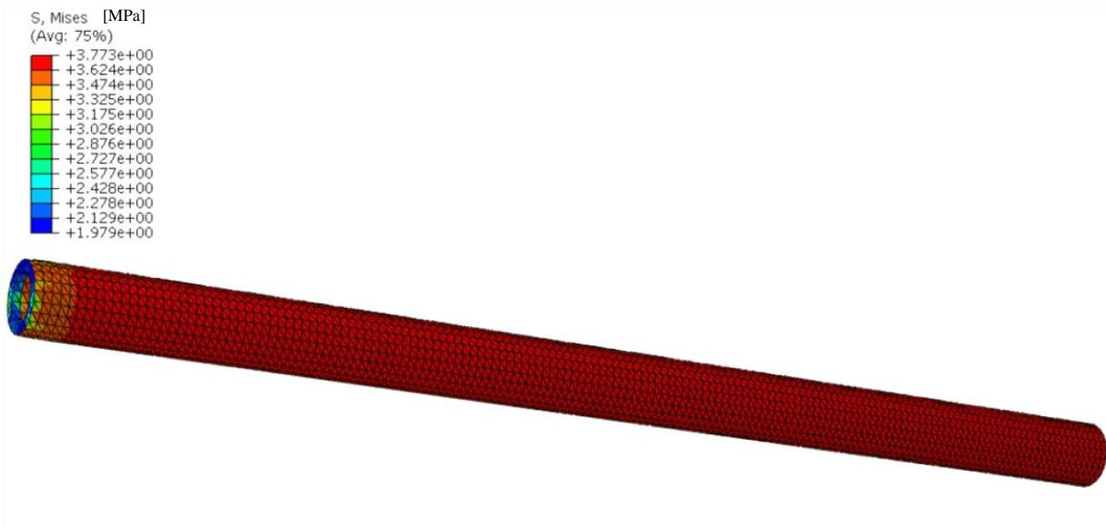
**Slika 29.** Naprezanja u sponi za uzdužno vođenje za slučaj kombiniranog opterećenja.
