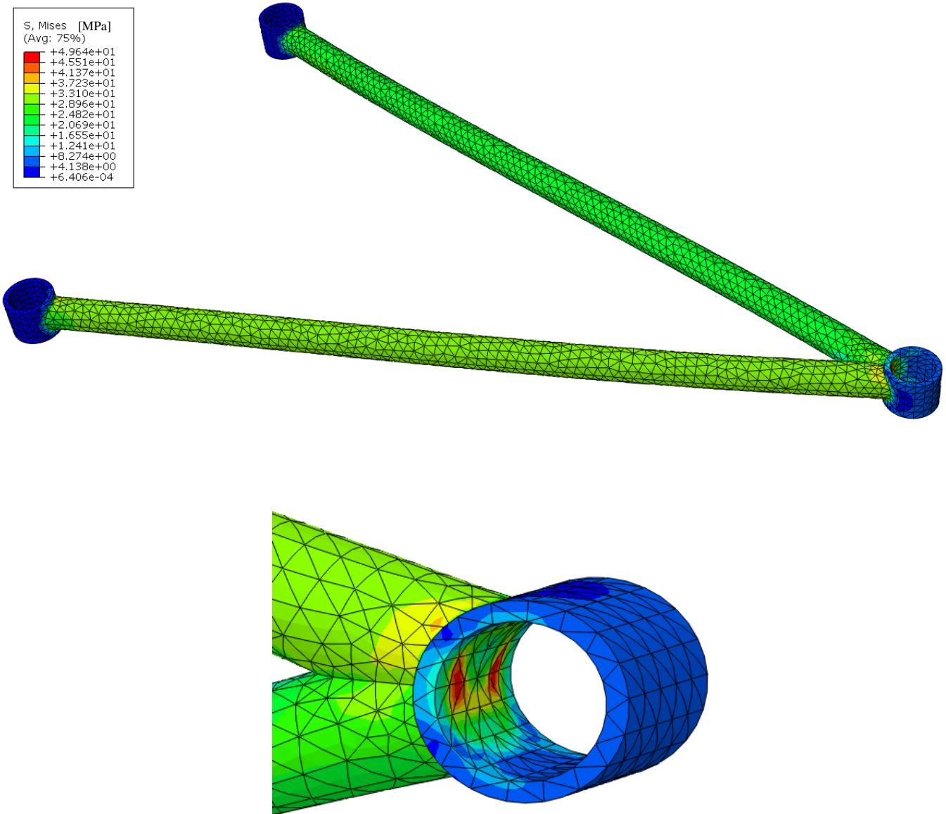
Slika 25. Naprezanja u donjem ramenu i detalj najvećeg naprezanja za slučaj skretanja.
