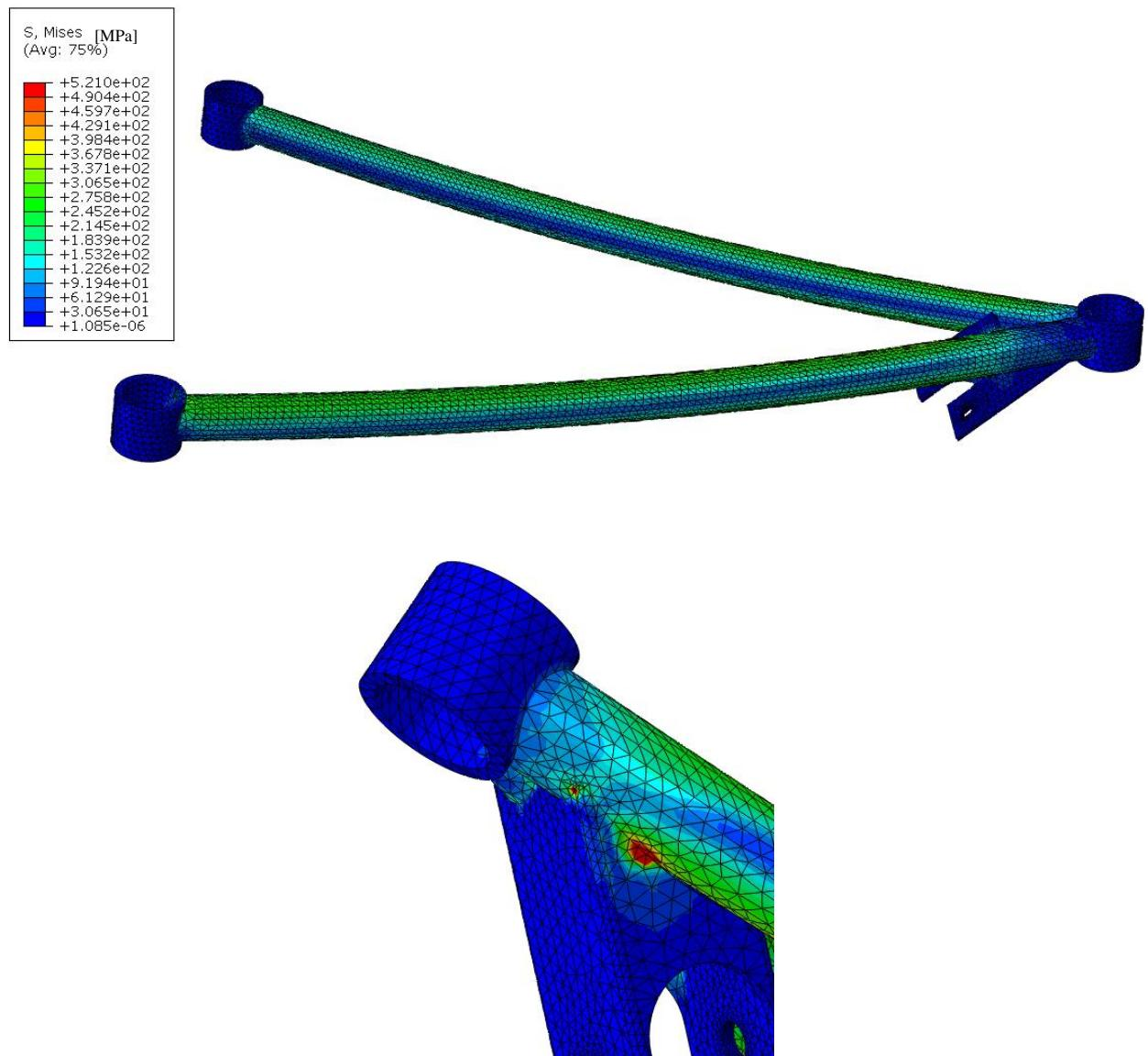
Slika 26. Naprezanja u gornjem ramenu i detalj najvećeg naprezanja za slučaj skretanja.
