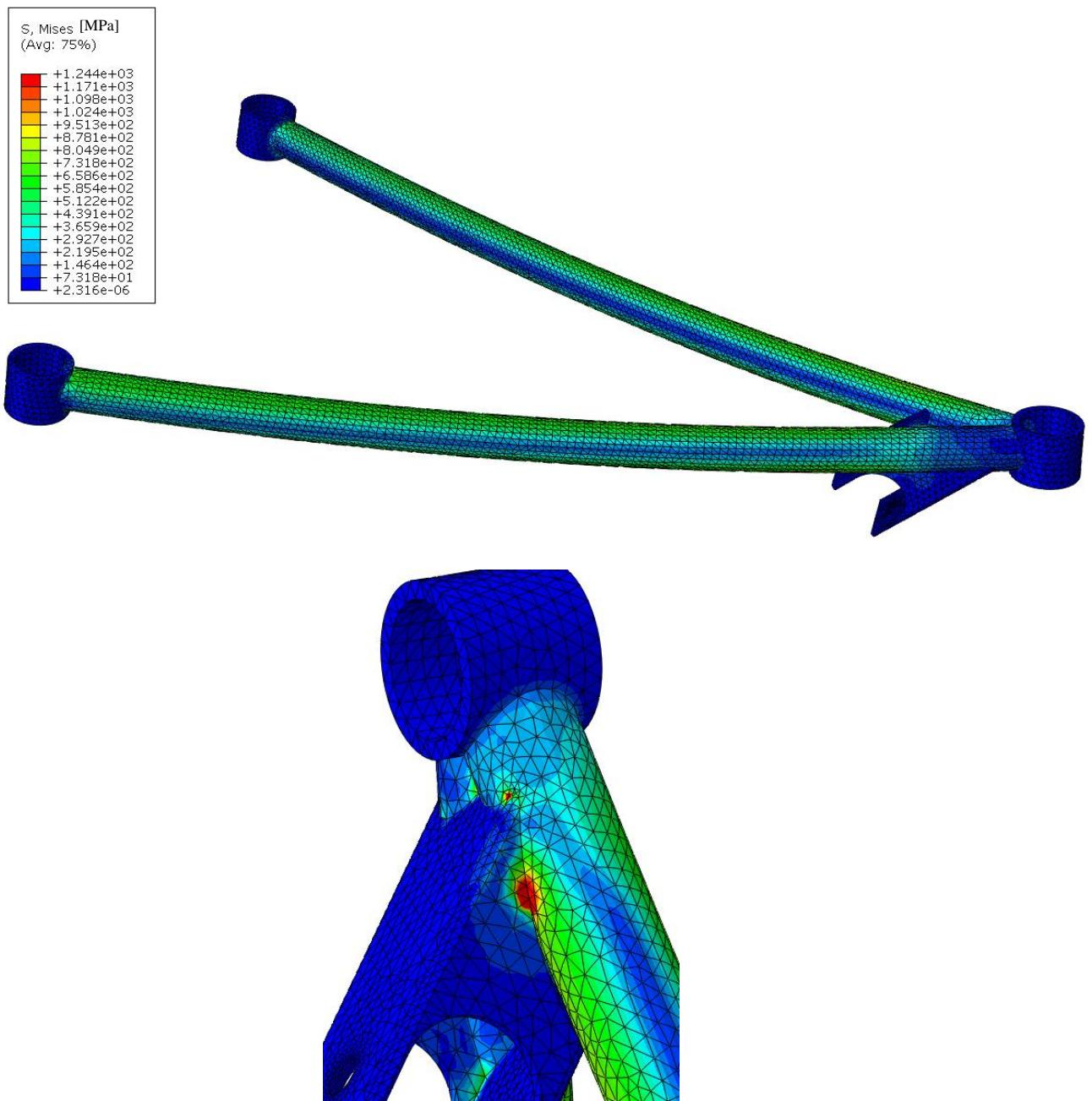
Slika 28. Naprezanja u gornjem ramenu i detalj najvećeg naprezanja za slučaj kombiniranog opterećenja.
