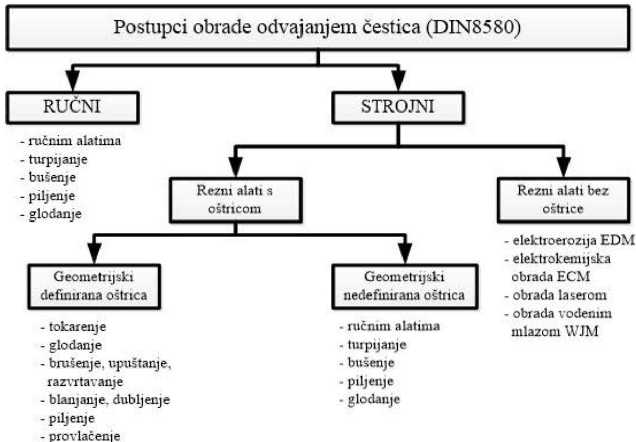
Slika 2.1. Podjela postupaka obrade odvajanjem čestica (DIN8580)
