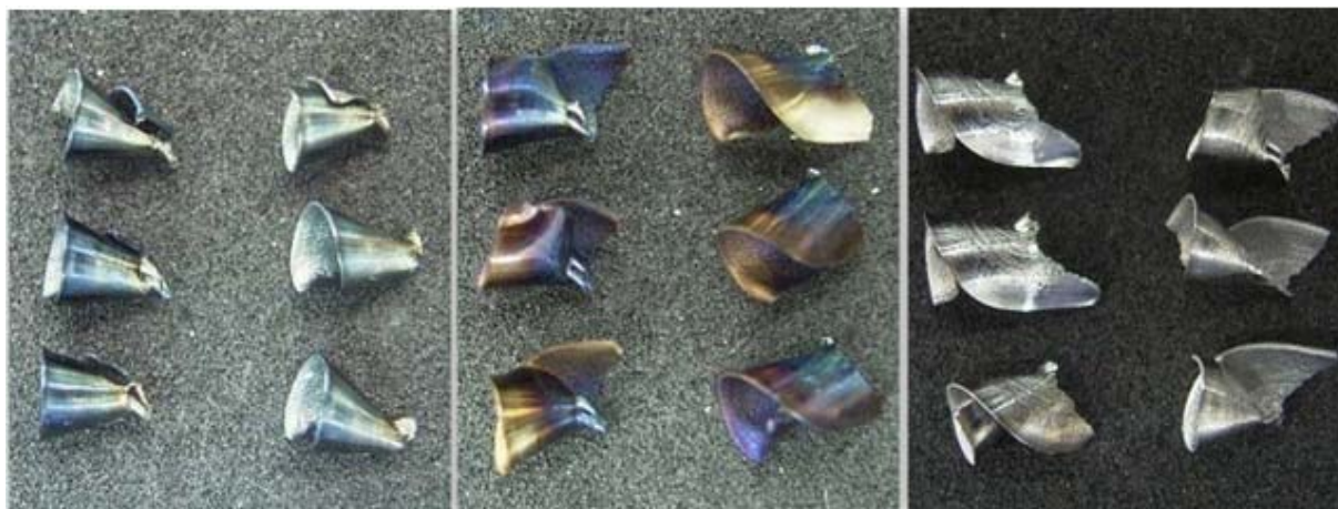
Slika 5.1. Usporedba odvojene čestice nakon bušenja bez hlađenja, s vanjskim hlađenjem i s hlađenjem kroz svrdlo [14]
