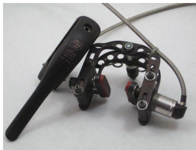
Slika 5. Hidrauličke kočnice [2]
