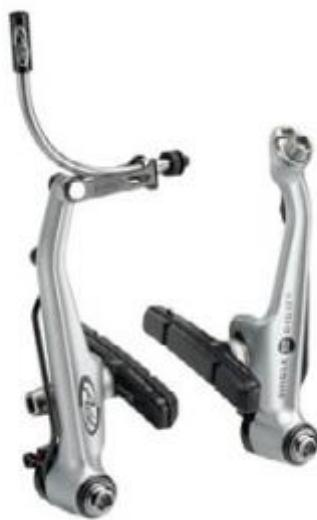
Slika 8. V-kočnice [7]
