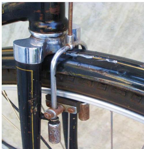
Slika 3. Kočnica na naplatku kotača [2]
