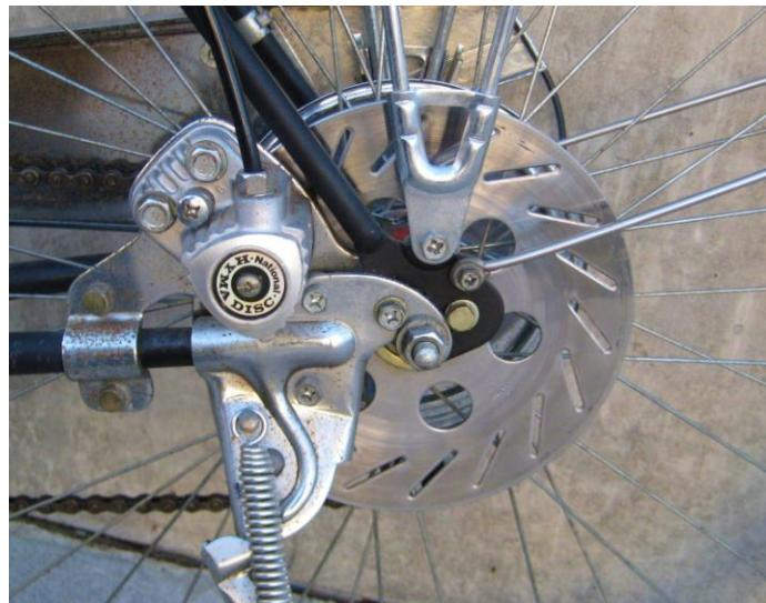
Slika 6. Primjerak iz prve serije disk kočnica [2]
