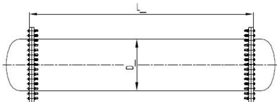
Slika 30. Dimenziije kondenzatora (R717)
