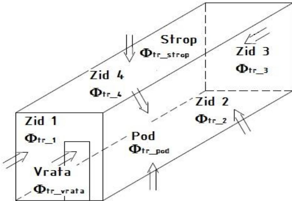
Slika 8. Transmisijski gubitci „HLADIONICE 1“ kroz zidove, strop, pod i vrata
