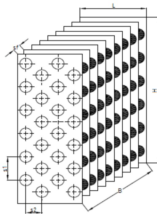
Slika 24. Prikaz konstrukcijskih parametara R404A
