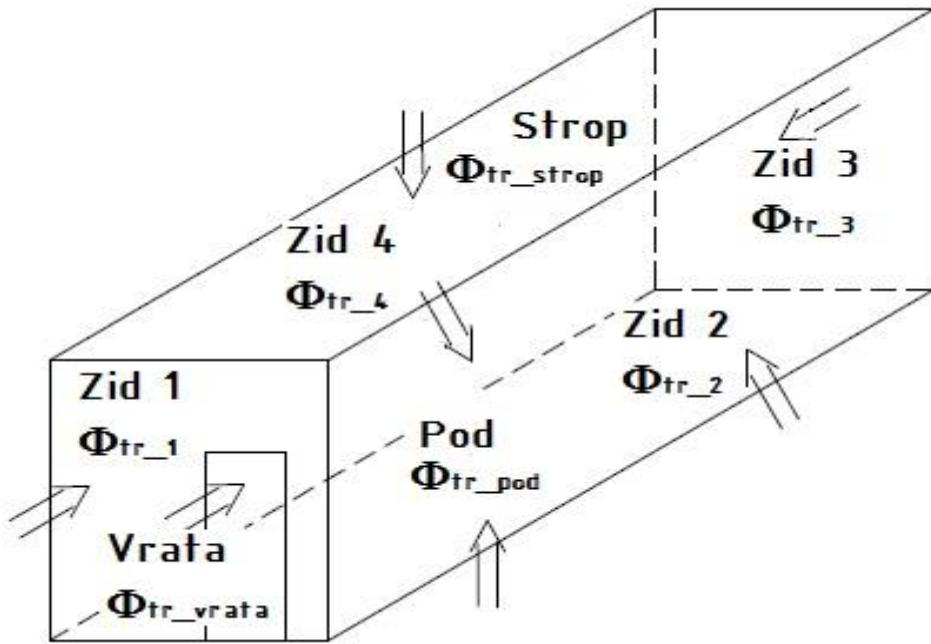
slika 12. Transmisijski gubitci „TUNELA ZA ZAMRZAVANJE 1“ kroz zidove, strop, pod i vrata
