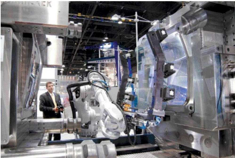
Slika 4.5. Pogled na sustav za injekcijsko-izravno prešanje polikarbonatnih okana za vozila [14]
