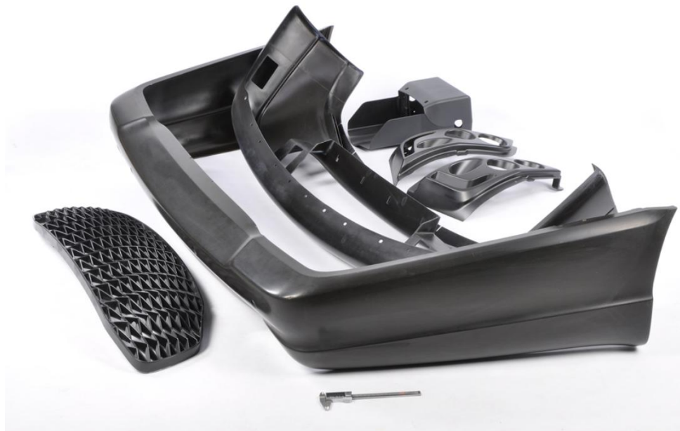
Slika 4.8. Primjeri vanjskih dijelova automobila nastalih postupkom RIM [17]
