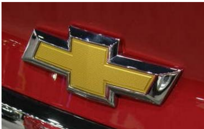
Slika 4.16. Znak Chevrolet -a načinjen injekcijskim ukrašavanjem [22]
