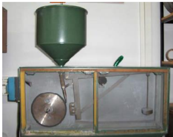
Slika 5.4. Uređaj za ispitivanje metodom „suhi pijesak/gumeni kotač“ [13]
