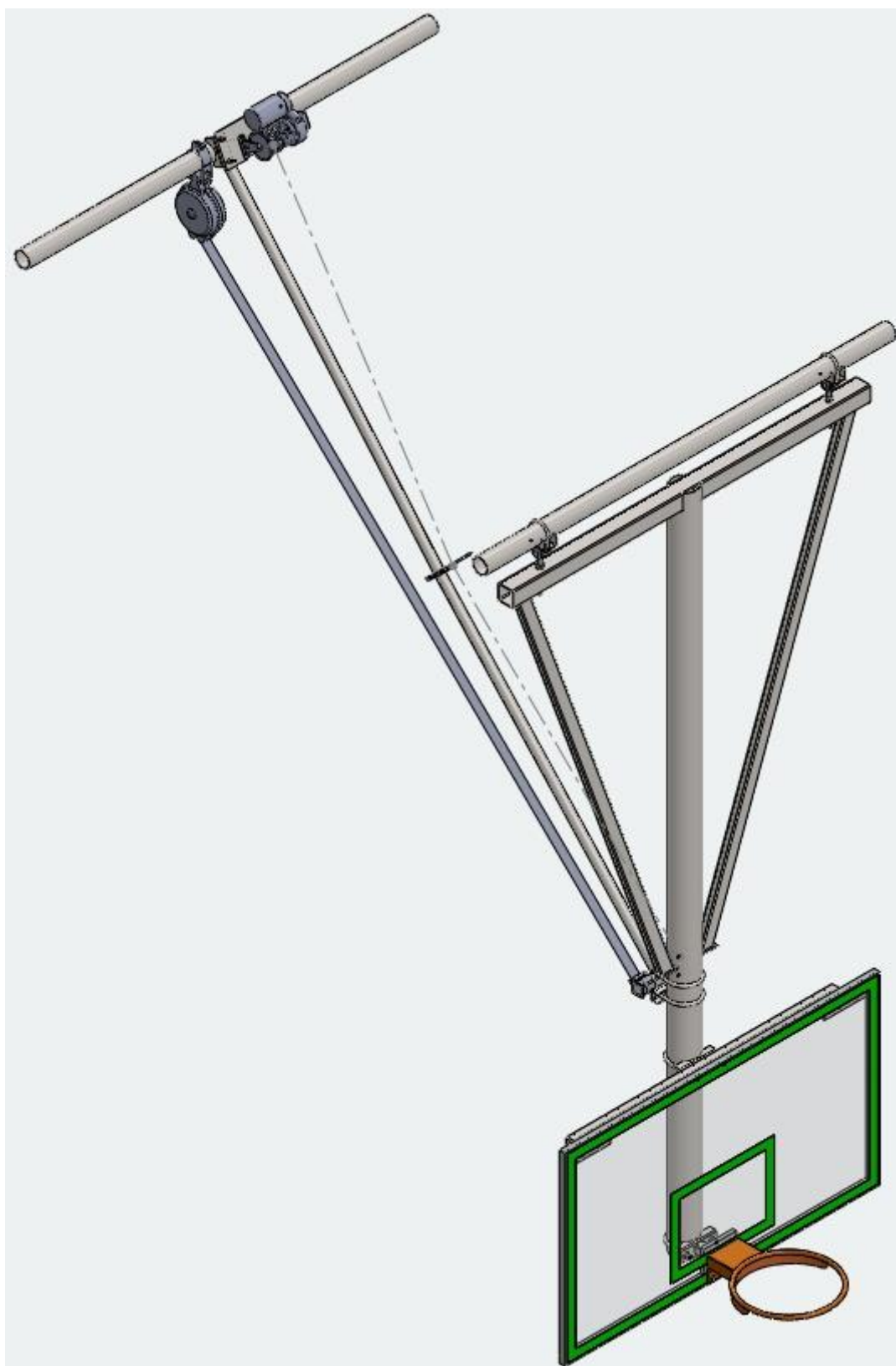
Slika 21. Stropna podizna konstrukcija koša za košarku
