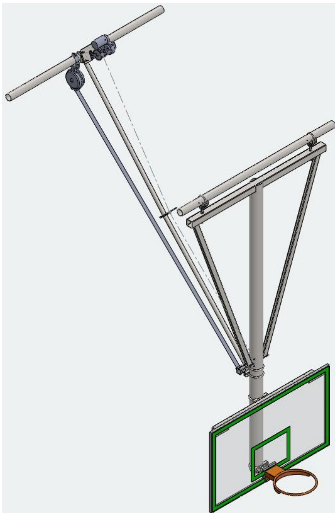
Slika 21. Stropna podizna konstrukcija koša za košarku
