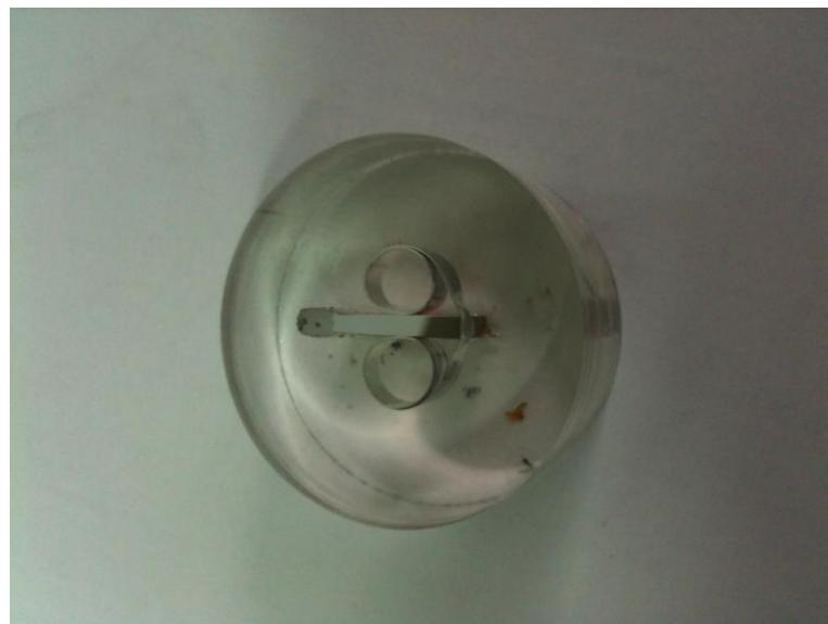
Slika 24. Uzorak spreman za metalografsku analizu
