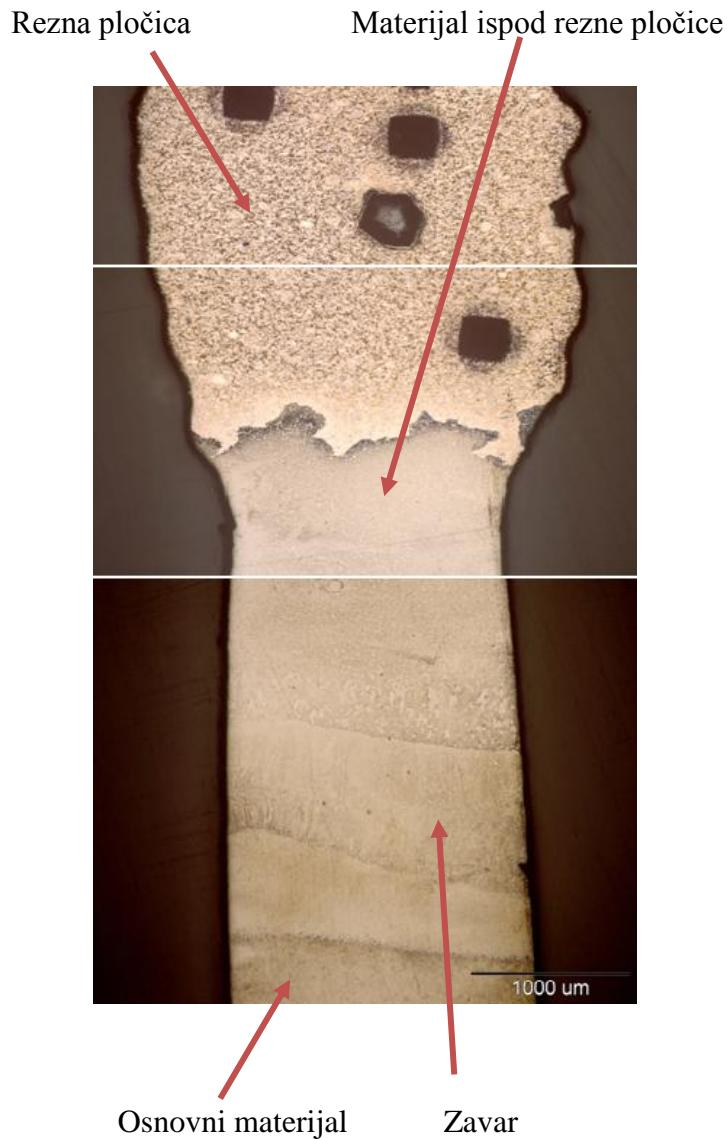
Slika 40. Prikaz mesta ispitivanja tvrdoće po presjeku rezne ploče
