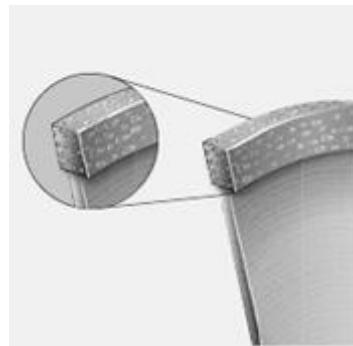
Slika 13. Problem zastakljenog dijamantnog segmenta rezne ploče [6]
