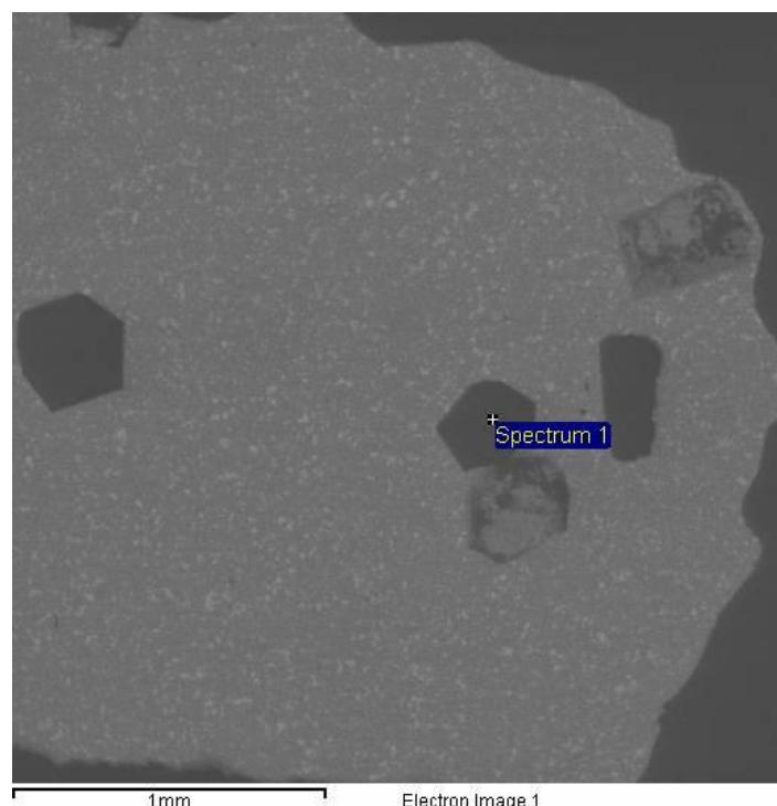
Slika 36. EDS analiza rezne pločice (reznog segmenta)
