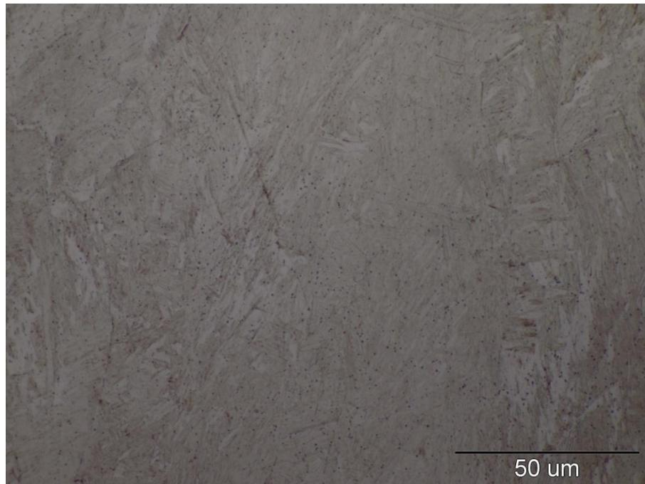
Slika 32. Prikaz zavara između osnovnog materijala i materijala ispod rezne pločice 1000x
