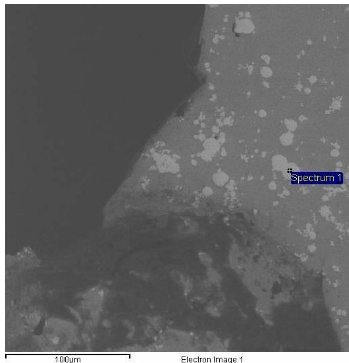
Slika 37. EDS analiza najzastupljenijeg elementa matrice, rezne pločice
