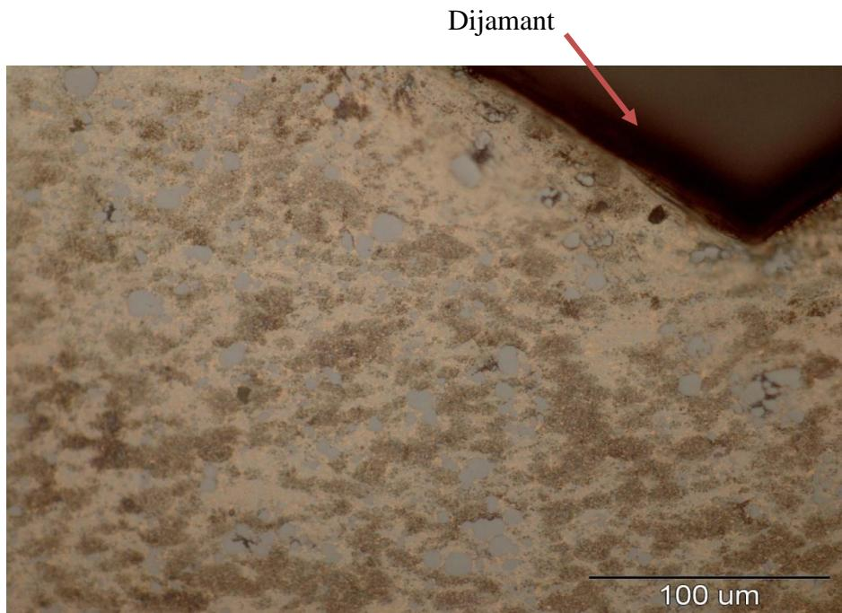
Slika 27. Prikaz rezne pločice povećanja 500x
