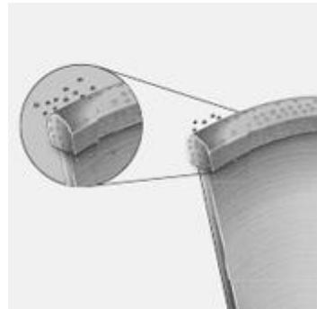
Slika 14. Problem pretjeranog trošenja segmenta rezne ploče [6]
