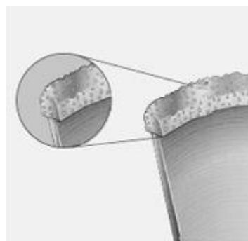
Slika 15. Problem pretjeranog bočnog trošenja segmenta rezne ploče [6]
