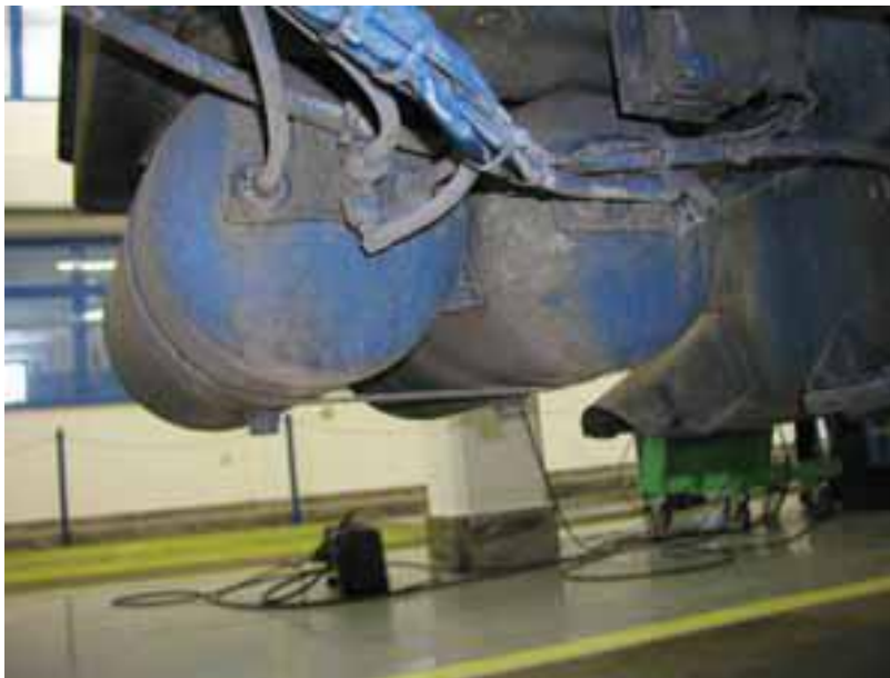
Slika 47. Spremnici zraka s ručnim ventilom za ispuštanje kondezata
