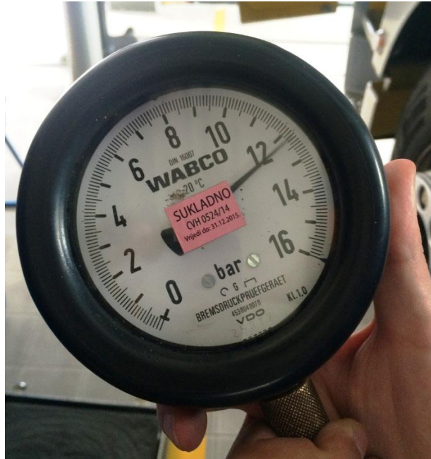
Slika 55. Maximalan tlak u spremniku drugog kruga
