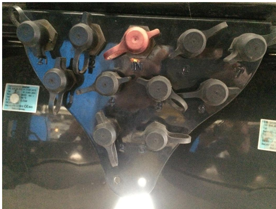
Slika 51. Kontrolni priključci spremnika zraka
