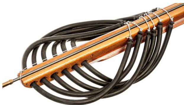
Slika 2. Podvodna puška sa većim brojem guma
