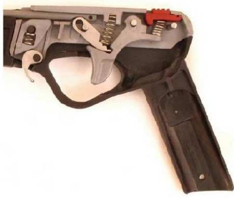
Slika 9 . Članovi mehanizma unutar polimernog kućišta Picasso puške.
