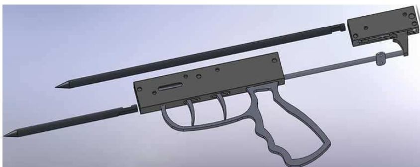
Slika 27. Model kućišta mehanizma s duplim okidačem
