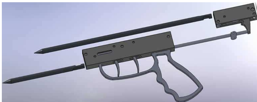
Slika 27. Model kućišta mehanizma s duplim okidačem
