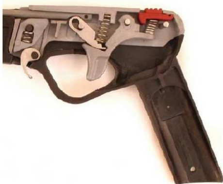
Slika 9 . Članovi mehanizma unutar polimernog kućišta Picasso puške.
