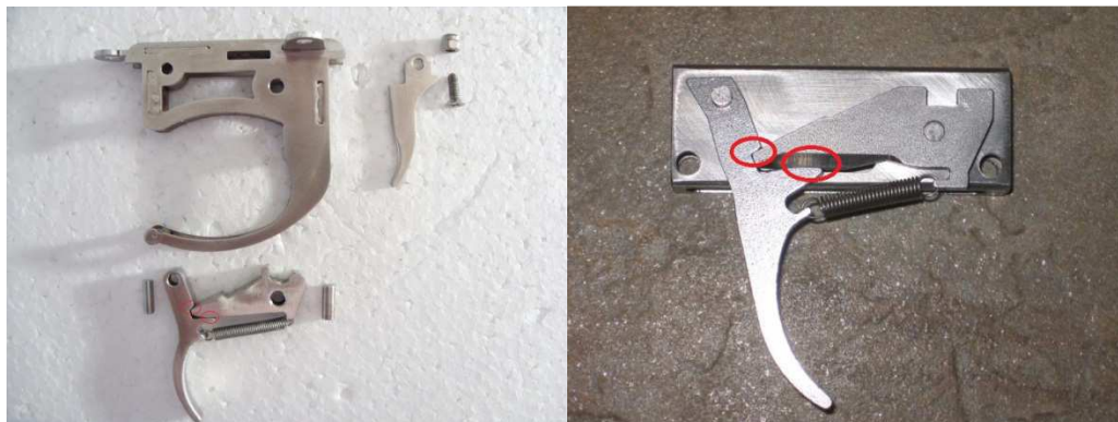
Slika 21. Sklop standardnog mehanizma s 2 linijska dodira
