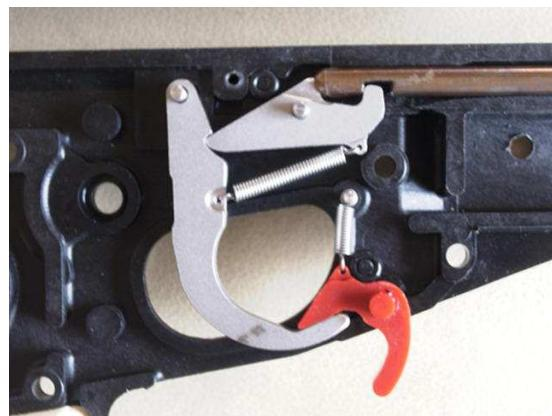
Slika 10. Članovi mehanizma unutar polimernog kućišta Ocean rhino puške
