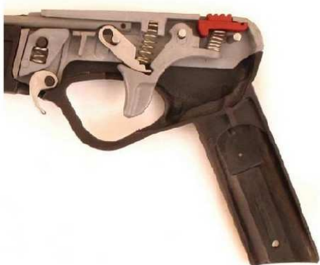
Slika 9 . Članovi mehanizma unutar polimernog kućišta Picasso puške.
