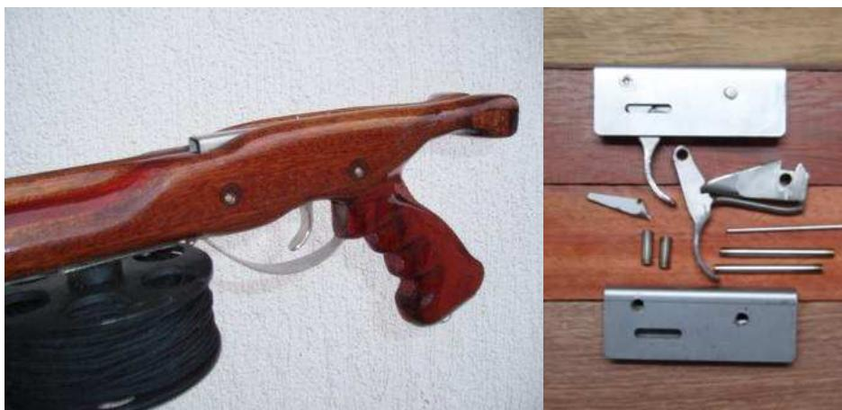
Slika 8. Drveno tijelo puške sa pripadajućim metalnim kućištem
