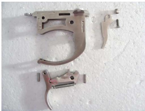
Slika 21. Sklop standardnog mehanizma s 2 linijska dodira
