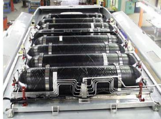
Slika 7.2. Faber cilindar čelični s ugljičnim vlaknima
