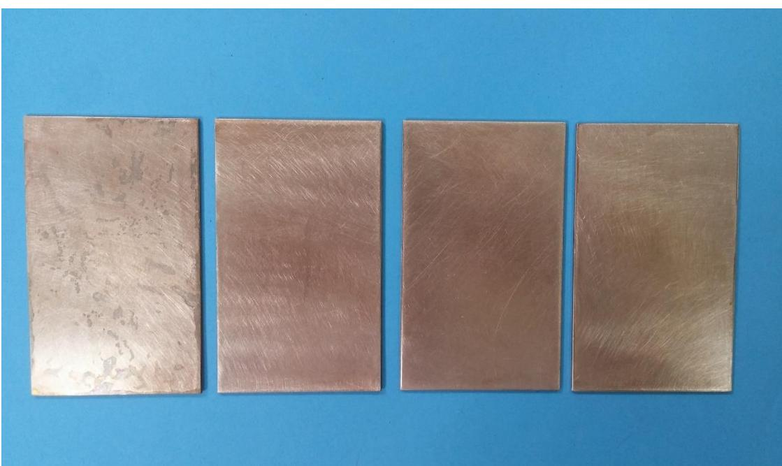
**Slika 31. Rezultati ispitivanja uzorka od bakra PE folijom debljine 200  $\mu\text{m}$**
