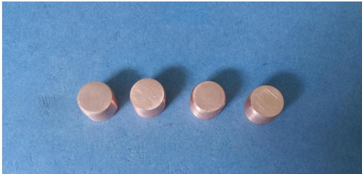
**Slika 32. Uzorci od bakra promjera 10 mm**
