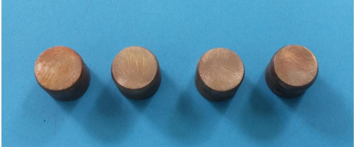
**Slika 40. Rezultati VIA testa uzoraka od bakra ispitivanih PE folijom debljine 100  $\mu\text{m}$**
