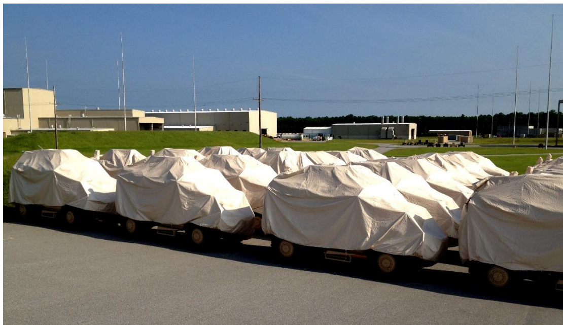
Slika 15. Primjena inhibitora korozije za zaštitu vojnih vozila [19]
