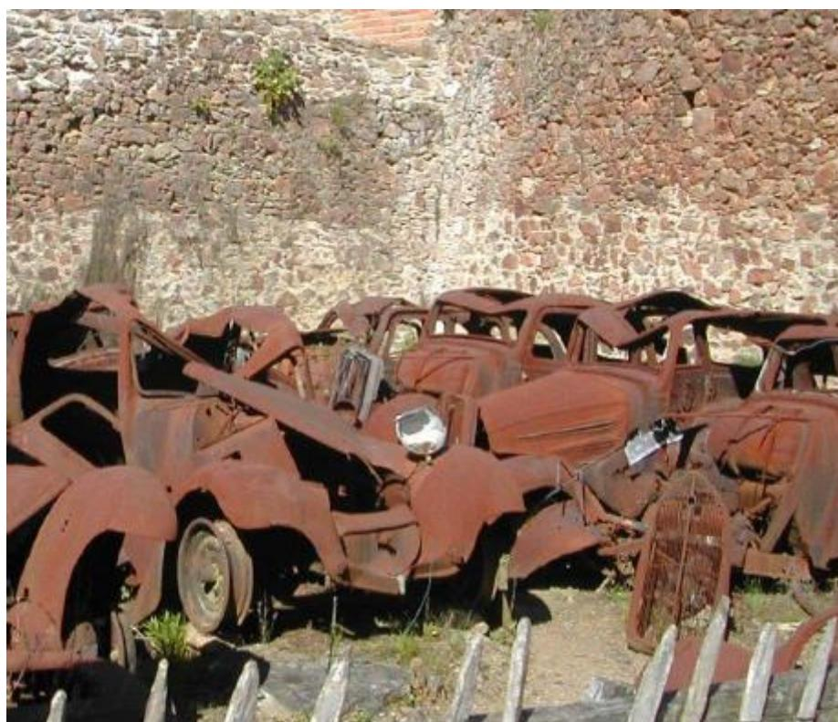
Slika 2. Primjer opće korozije [3]
