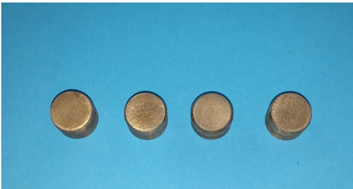
Slika 38. Rezultati VIA testa uzoraka od bakra ispitivanih PE folijom debljine 50 \mu\text{m}
