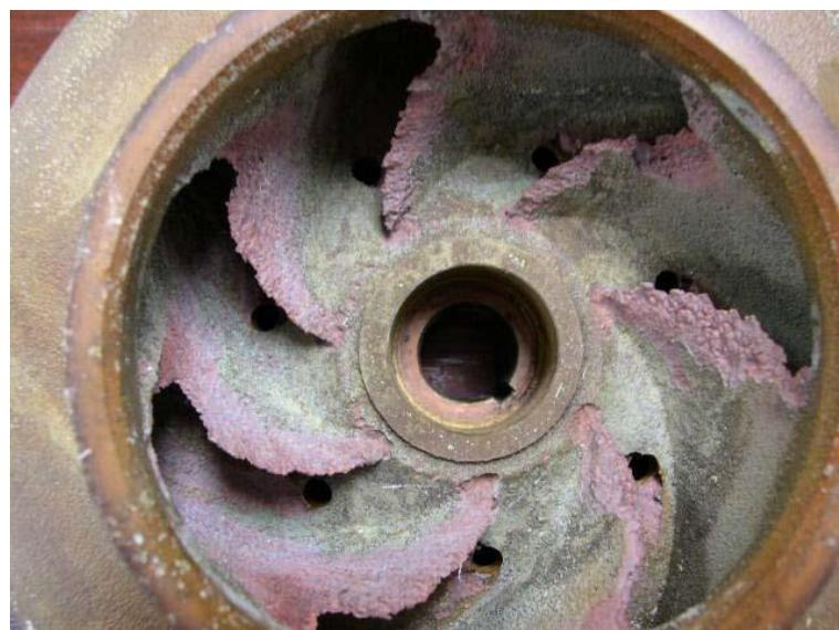
Slika 3. Erozijska korozija [7]
