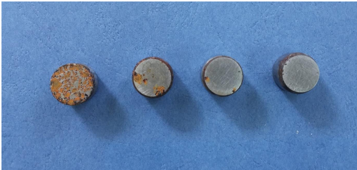
Slika 39. Rezultati VIA testa uzoraka od ugljičnog čelika ispitivanih PE folijom debljine 100 \mu\text{m}
