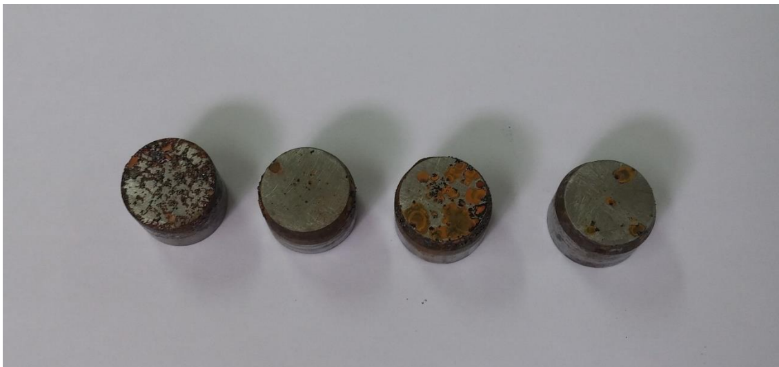
Slika 37. Rezultati VIA testa uzoraka od ugljičnog čelika ispitivanih PE folijom debljine 50 \mu\text{m}
