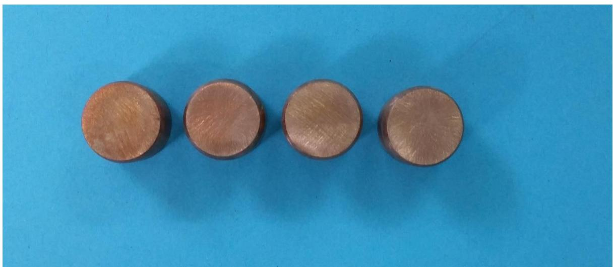
**Slika 42. Rezultati VIA testa uzoraka od bakra ispitivanih PE folijom debljine 200  $\mu\text{m}$**
