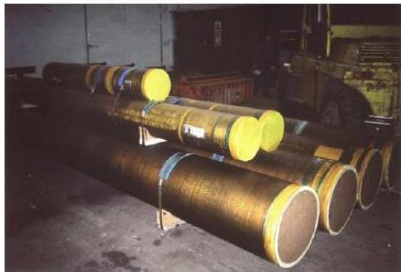
Slika 12. Privremena zaštita unutrašnjosti cijevi praškastim inhibitorima korozije [12]
