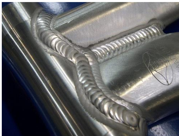
Slika 16 Zavareni spoj aluminija
