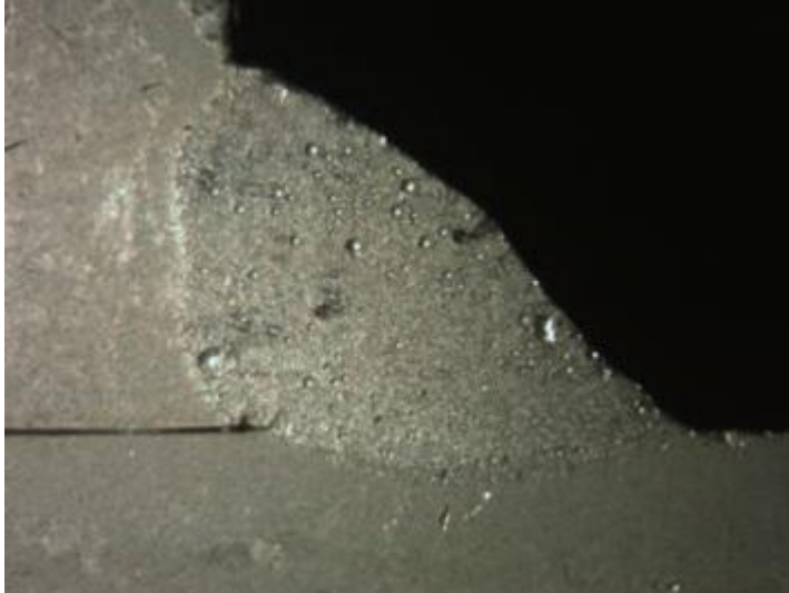
Slika 10. Poroznost u kutnom spoju [11]
