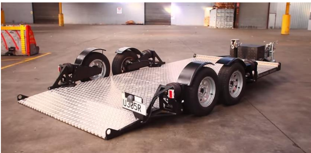
Slika 3. Otvorena prikolica (hidraulična, s podesivom visinom)
