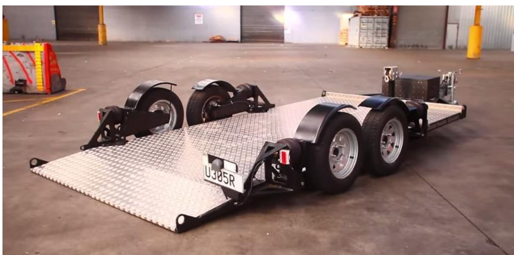
Slika 3. Otvorena prikolica (hidraulična, s podesivom visinom)
