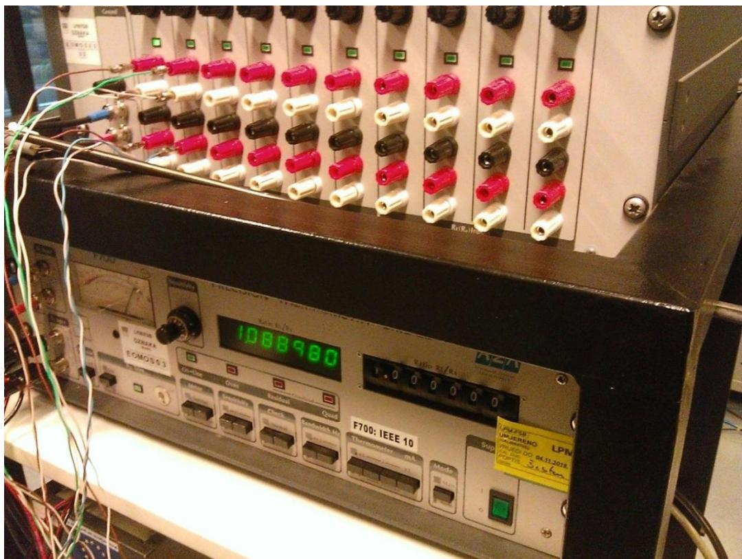
Slika 35. Most za računanje električnog otpora EOMO0302
