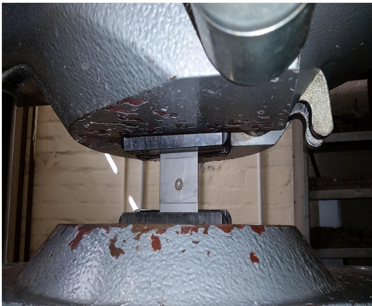
Slika 37. Ispitivanje čvrstoće zavara
