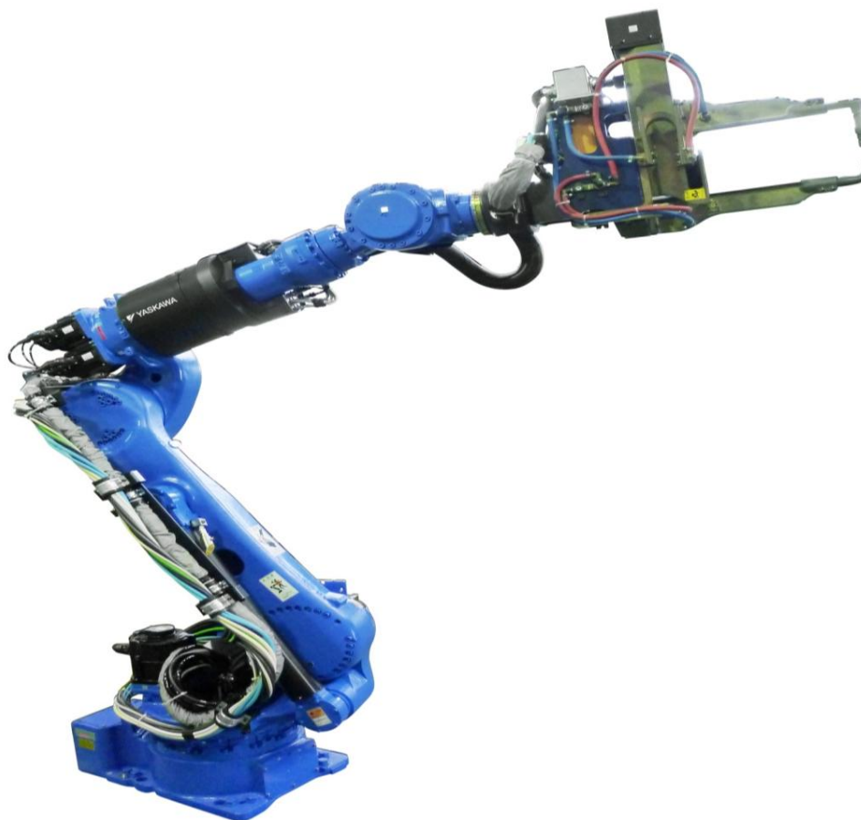
Slika 19. Robot za elektrootporno točkasto zavarivanje [26]
