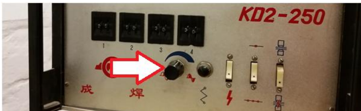
Slika 31. Reguliranje jakosti struje zavarivanja
