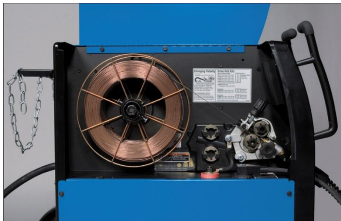
Slika 11. Unutrašnjost dodavača žice [10]
