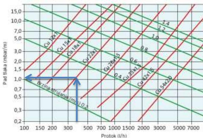
Slika 22. Pad tlaka u bakrenoj cijevi 60 % voda, 40 % glikol [13]
