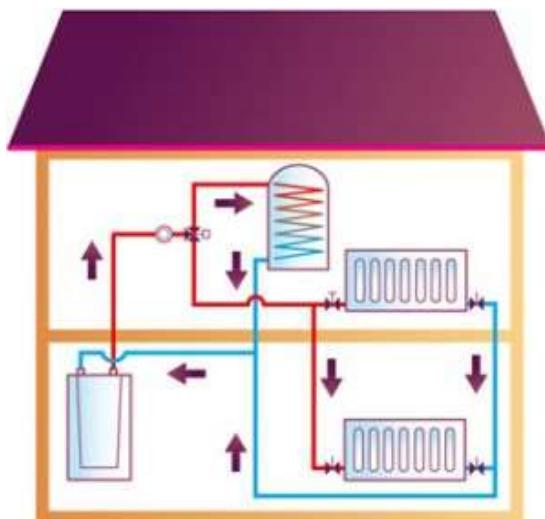
Slika 3. Centralno grijanje i priprema PTV-a sa plinskim kotлом [5]
