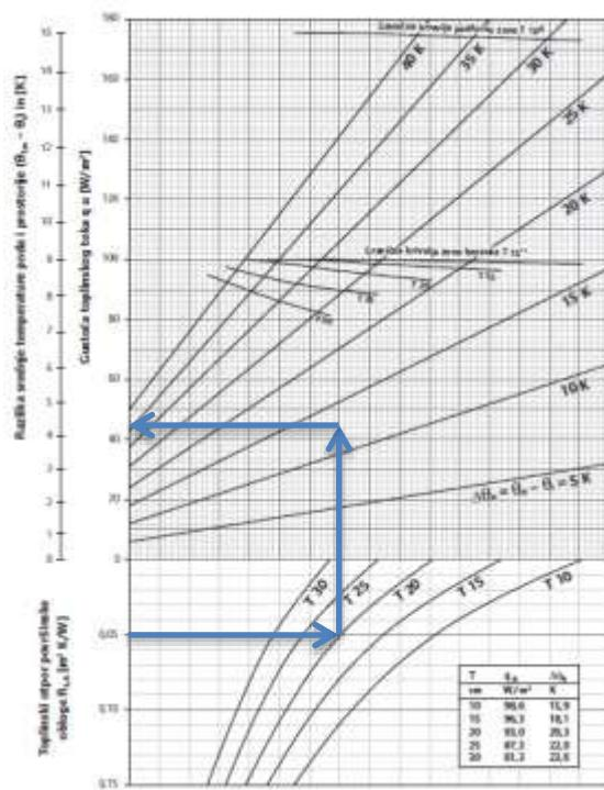
Slika 8. Dijagram za proračun sustava: Uponor Tecto ploča, PE-Xa cijevi  $\Phi 14 \times 2 \text{ mm}$  [10]
