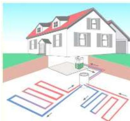
Slika 5. Dizalica topline sa tлом као извором topline [7]
