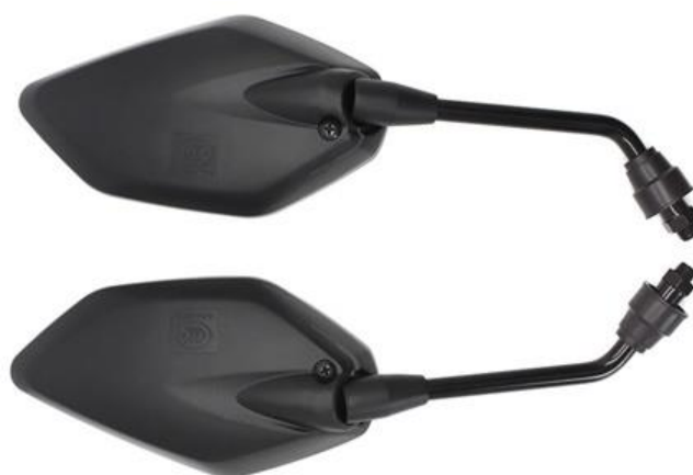
Slika 31. Retrovizori za skuter od polimernih materijala [64]
