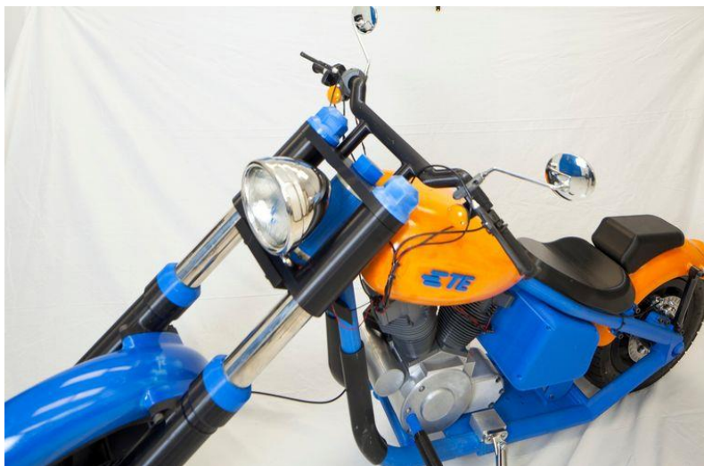
Slika 34. Motocikl izrađen metodom 3D printanja [70]
