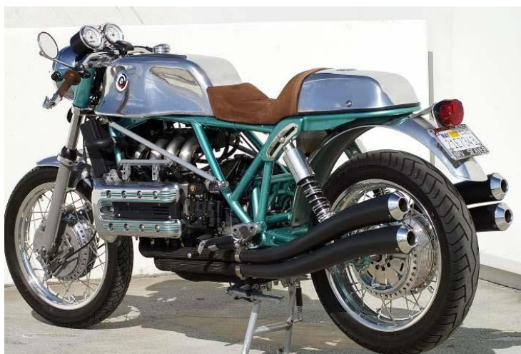
Slika 23. Primjer okvira izrađenog od „chromoly“ čelika [49]
