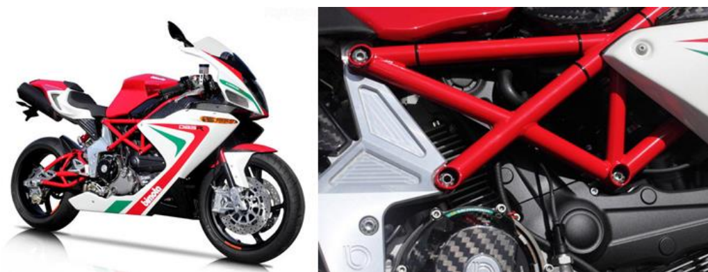
Slika 21. Trokutasti „trellis“ okvir motocikla Bimota DB5R [42]
