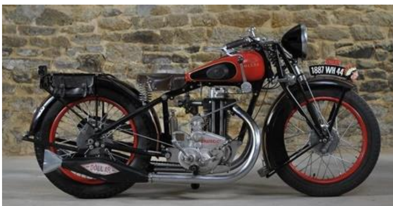
Slika 20. Jednostavan okvir motocikla Dollar S3 iz 1930. godine [41]
