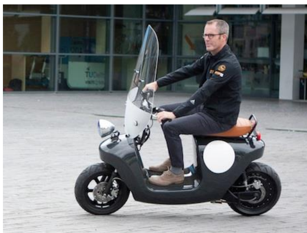
Slika 37. Be.e motocikl s okvirom od vlakana konoplje [75]
