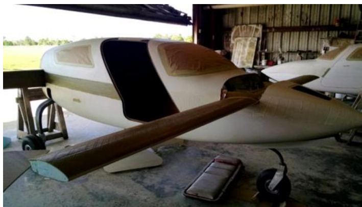
Slika 36. Izrada aviona od 75 % konoplje [74]
