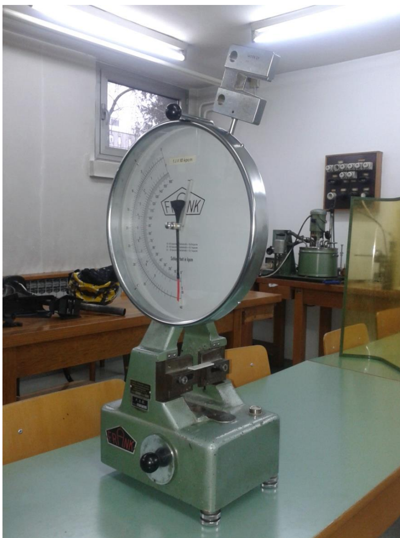
Slika 29. Charpyjev bat za ispitivanje žilavosti
