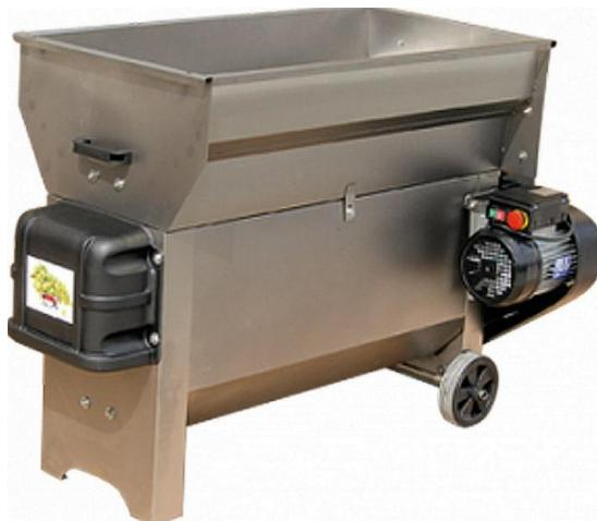
**Slika 6. Samostojeći stroj za mljevenje grožđa**
