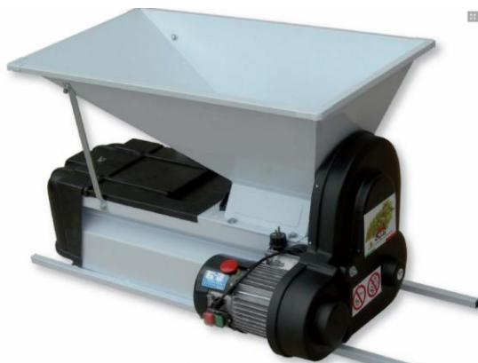
Slika 12. Električni mlin za grožđe
